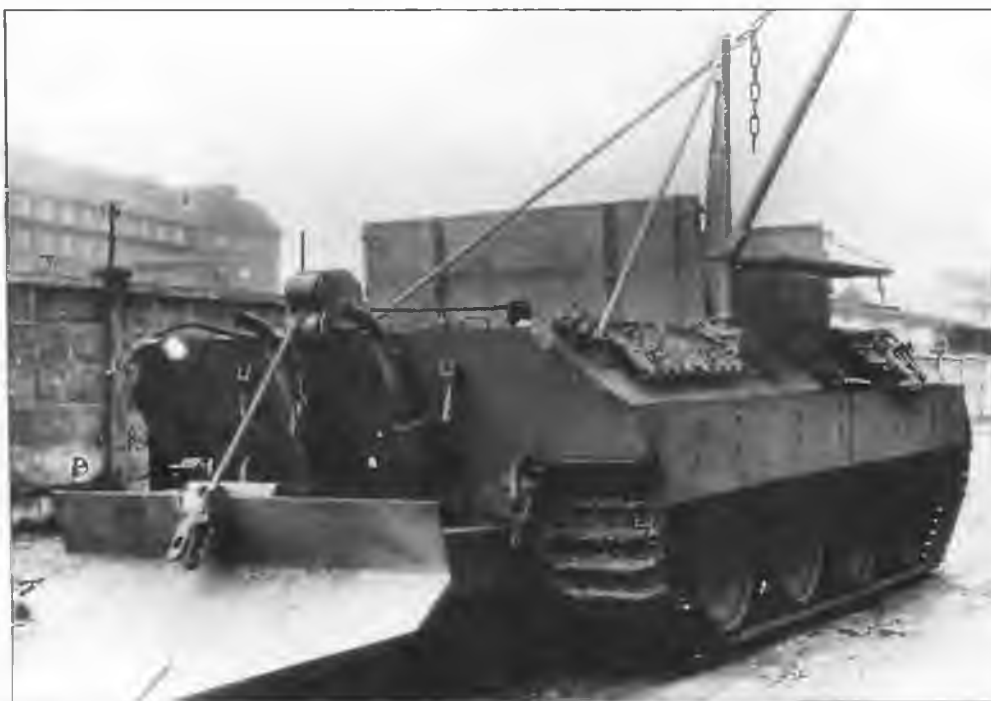
На фото сверху и слева: один из первых вариантов Bergepanther Ausf. G на базе «Пантеры» Ausf. D с лебедкой, кран-стрелой и сошником. Хорошо виден кронштейн со щитом для 20-мм пушки KwK 38
