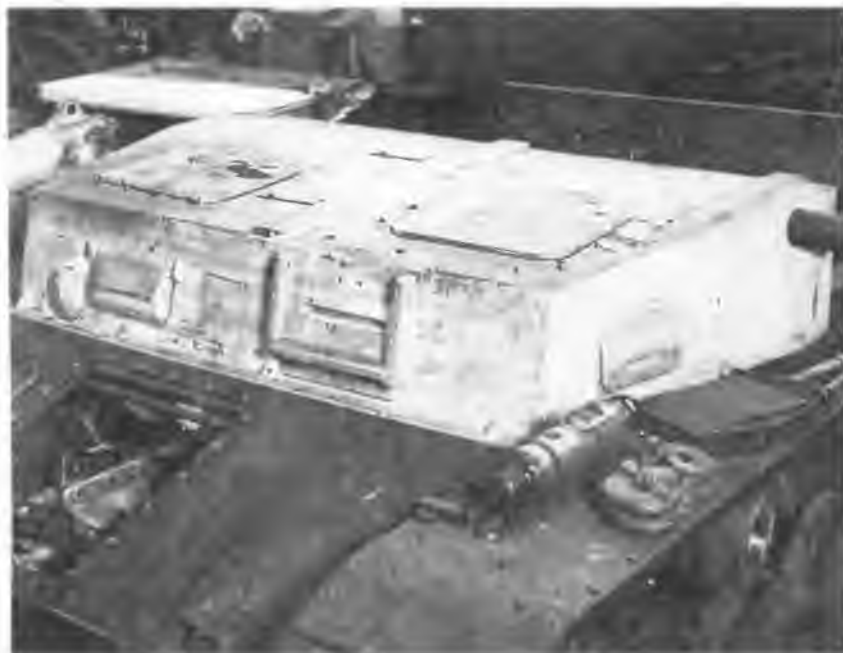
Деревянный макет передней части подбашенной коробки модификации Ausf.B, смонтированный на шасси BW II
