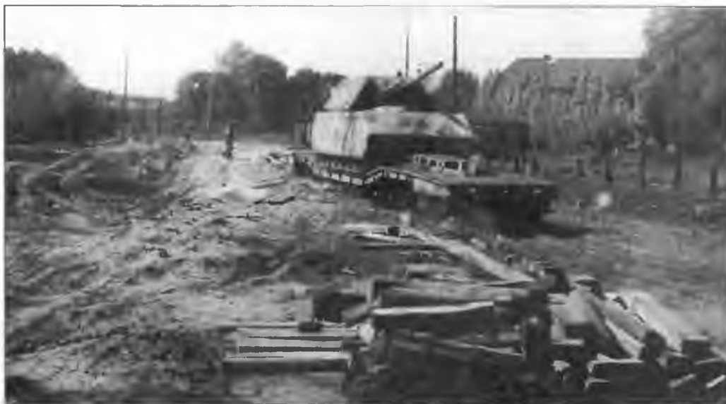
Собранный из двух частей сверхтяжелый танк «Маус» на специальной железнодорожной платформе (Schwertransportwagen)
