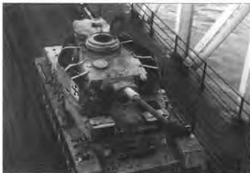
Pz.IV Ausf.J финской армии. Октябрь 1944 года. У этой машины демонтированы противокумулятивные экраны на корпусе
