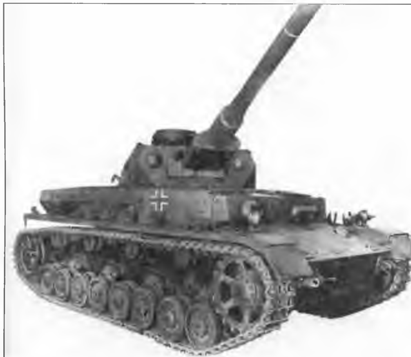
Pz.IV Ausf.F с деревянным макетом 75-мм пушки с длиной ствола 75 калибров
