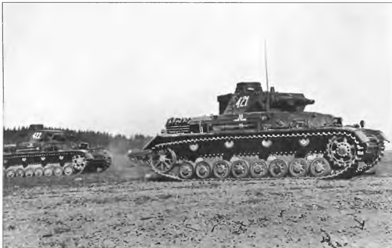
Танки Pz.IV Ausf.B. Восточный фронт, лето 1941 года. К началу операции «Барбаросса» все танки ранних выпусков были оборудованы башенными ящиками для снарядов
