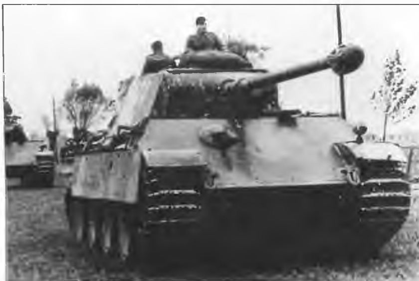
«Пантера» Ausf.G поздних выпусков без циммерита на броне
