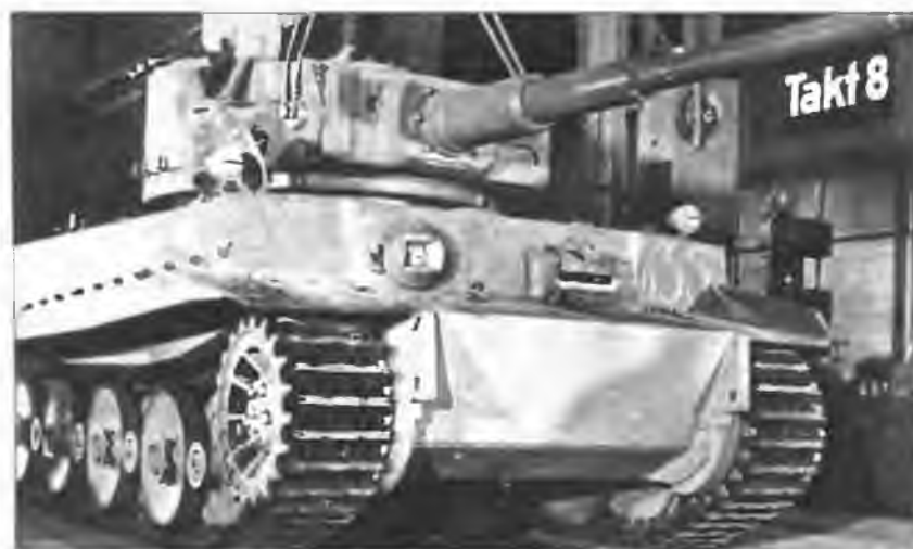
Монтаж башни в заводском цехе
