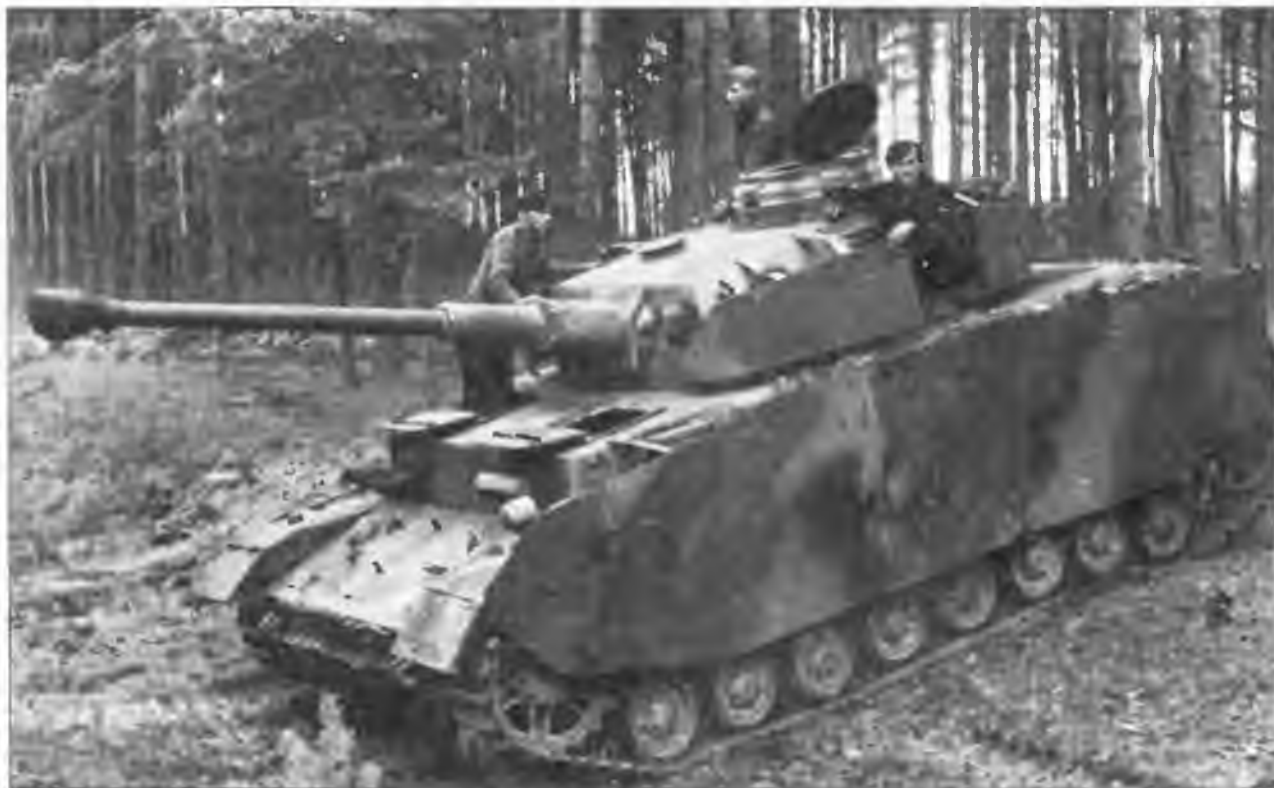
Pz.IV Ausf.J ранних выпусков. Почти полное внешнее соответствие модификации H (единственное отличие – отсутствие бортового прибора наблюдения механика-водителя), Восточный фронт, 1944 год
