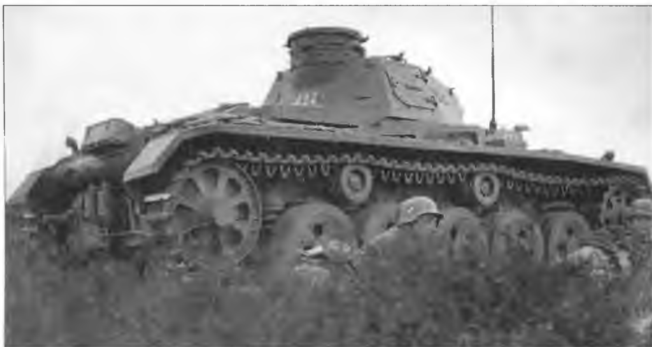
Pz.III Ausf.A во время учений в 1938 году. Хорошо видны ведущее колесо характерной только для этой модификации формы, два поддерживающих катка и пружинная подвеска
