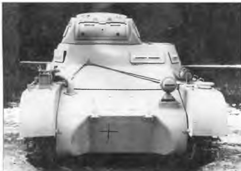
Pz.I Ausf.A – вид спереди. На большинстве танков фара со светомаскировочной насадкой устанавливалась посередине, а не слева
