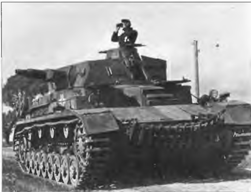
Pz.IV Ausf.D, 6-я танковая дивизия, лето 1941 года. К началу операции «Барбаросса» машины ранних выпусков приобрели черты, характерные для более поздних моделей, например гусеничные траки на лобовом листе корпуса (фото слева). Командирская башенка танка Ausf.D (вверху)
