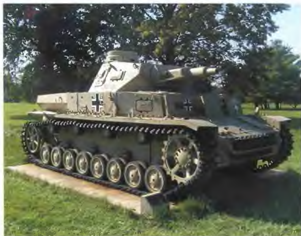
Panzer IV Ausf.D в экспозиции военного музея на Абердинском полигоне в США. Машина прошла частичную модернизацию в ходе войскового ремонта, в частности направляющее колесо заимствовано у Ausf.F
