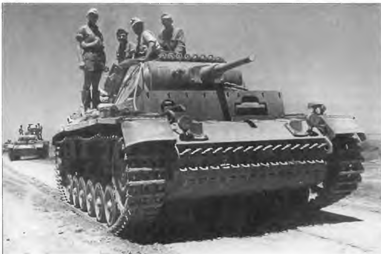
Pz.III Ausf.J в Африке. У машины в лобовой части корпуса установлен дополнительный 20-мм броневой лист
