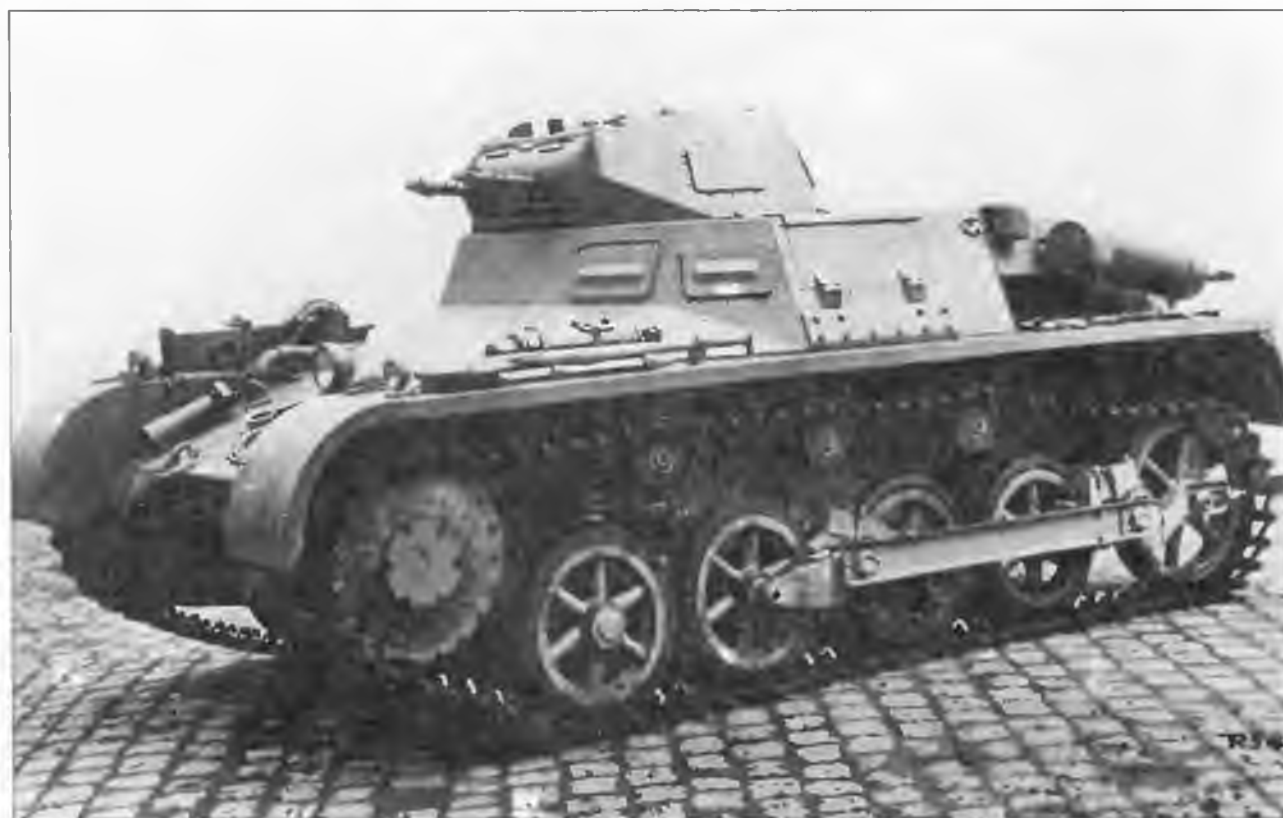
Прототип танка Pz.I Ausf.A с дизельным двигателем Krupp M601
