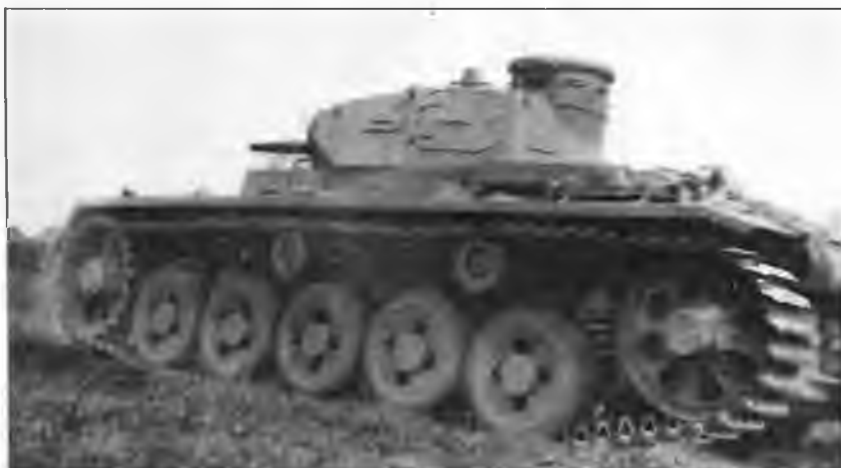
Pz.III Ausf.A в движении. Хорошо видны опорные катки большого диаметра, использовавшиеся только на этой модификации
