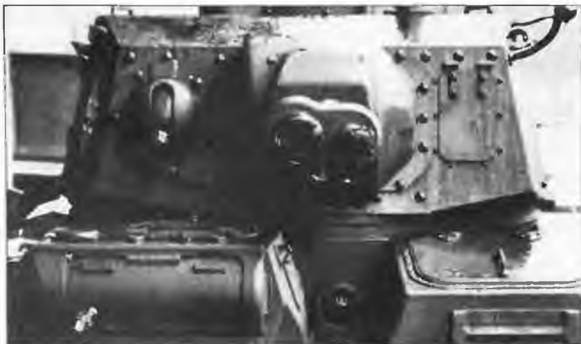
Башня Круппа, вид спереди. Хорошо видны спаренный пушечный лафет и шаровая установка пулемета в главной башне
