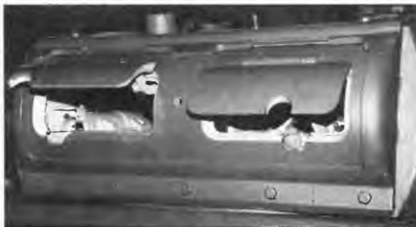
Амбразуры для установки пулеметов. Щитки амбразур находятся в небоевом положении
