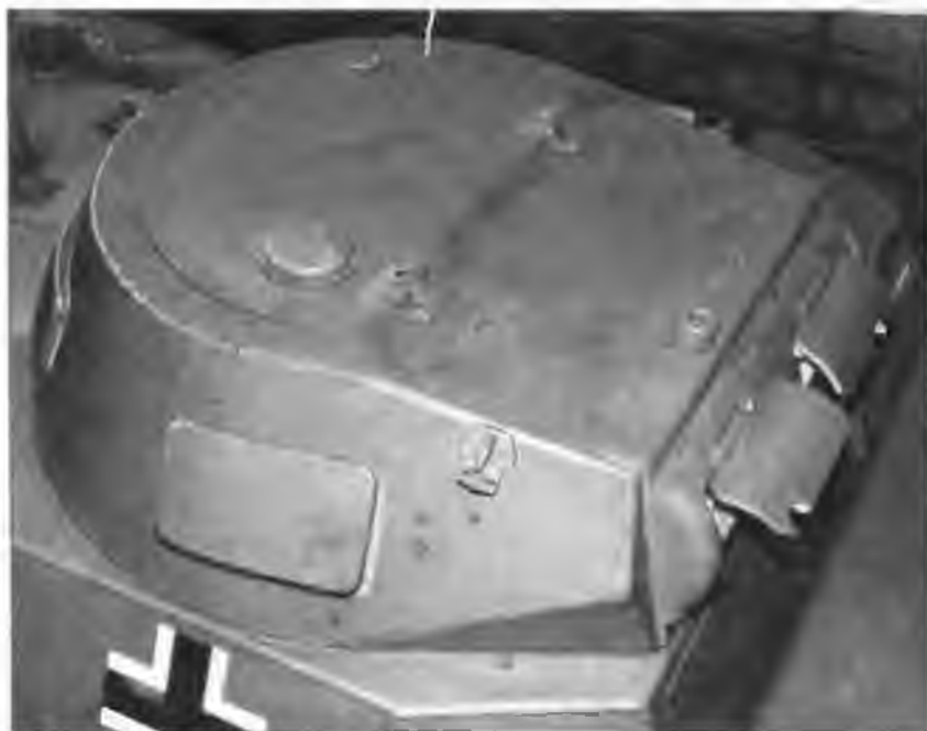
Башня танка Pz.I Ausf.A (вооружение не установлено). Хорошо видны смотровой лючок в борту башни и рым
