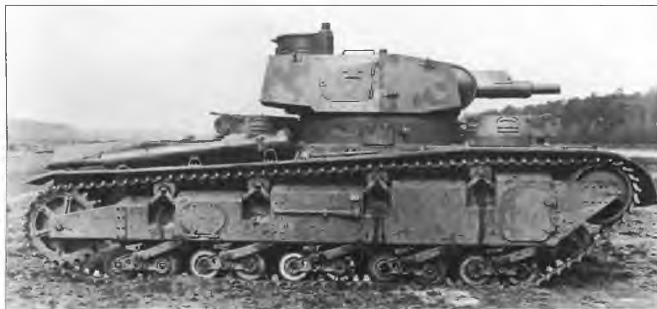
Средний танк Nb.Fz. №2 с башней фирмы Крупп
