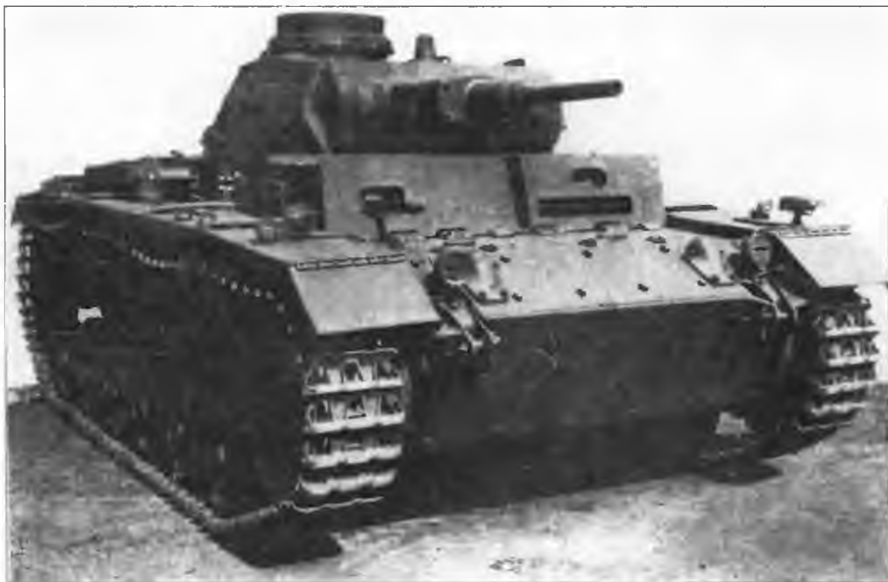
Pz.III Ausf.F, перевооруженный 50-мм пушкой. Кроме нового орудия, на этой машине установлено дополнительное бронирование лобового листа корпуса
