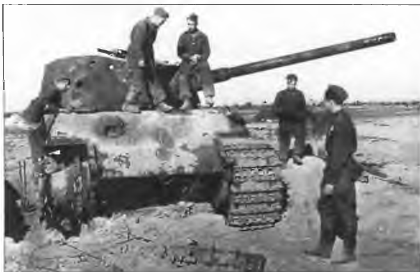
Красноармейцы осматривают тяжелый танк «Тигр-Б», подбитый на Сандомирском плацдарме. Судя по многочисленным вмятинам, пробоинам и отсутствию кормовых листов башни, этот танк подвергся обстрелу из различных артсистем с целью выяснения его поражаемости. Польша, август 1944 года
