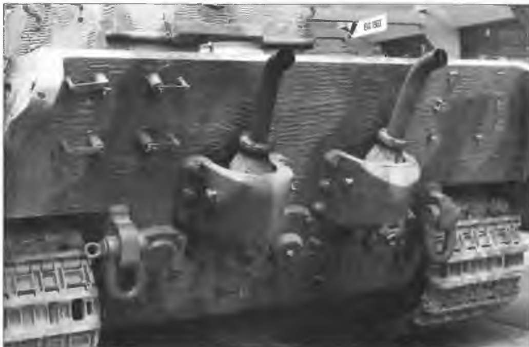
Кормовая часть корпуса. Под правой выхлопной трубой – незаглушенное отверстие для ручного запуска двигателя
