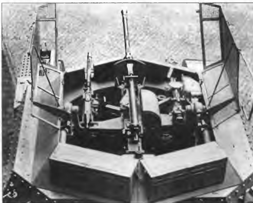
Вид на боевое отделение разведывательного танка Aufklärungspanzer 38(t). Хорошо виден лафет вооружения с 20-мм пушкой KwK 38 в центре, пулеметом MG 34 слева и прицелом TZF 3a справа. Откидная сетчатая крыша защищала боевое отделение от ручных гранат
