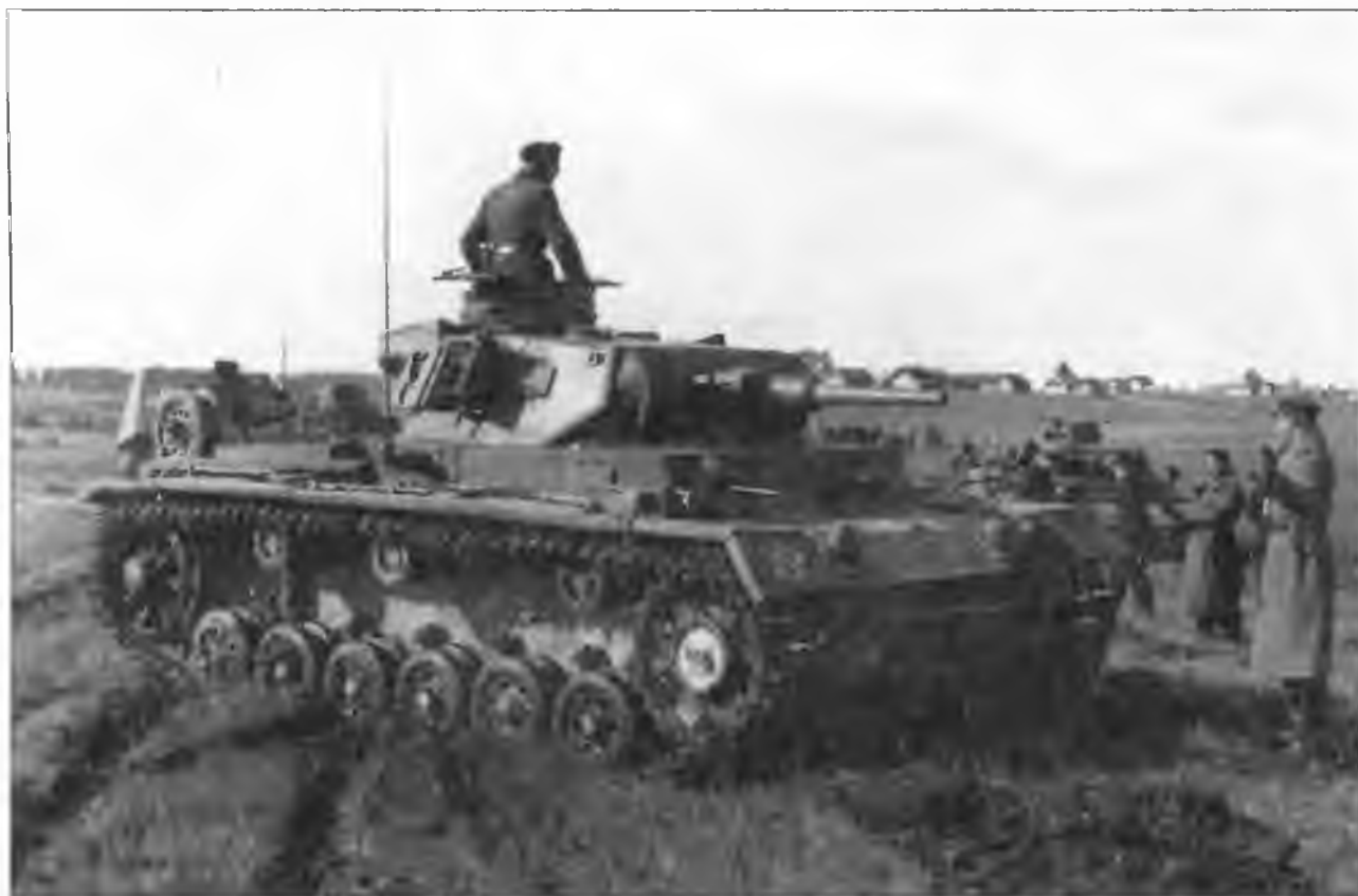
Вверху: Pz.III Ausf.J с короткоствольной 50-мм пушкой
