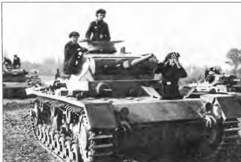
Pz.III Ausf.D. Польша, сентябрь 1939 года. Теоретически механик-водитель и стрелок-радист могли пользоваться для посадки в танк люками доступа к агрегатам трансмиссии. Однако совершенно очевидно, что в боевой обстановке сделать это было практически невозможно
