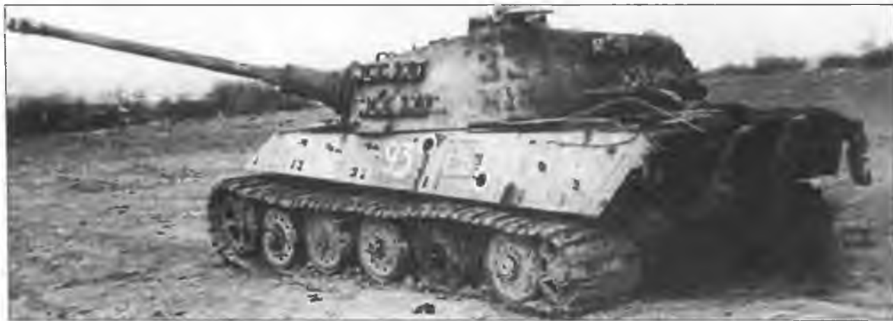
«Королевский тигр», подбитый из засады. В борту корпуса хорошо видны две пробоины, обведенные мелом. Район оз. Балатон, март 1945 года
