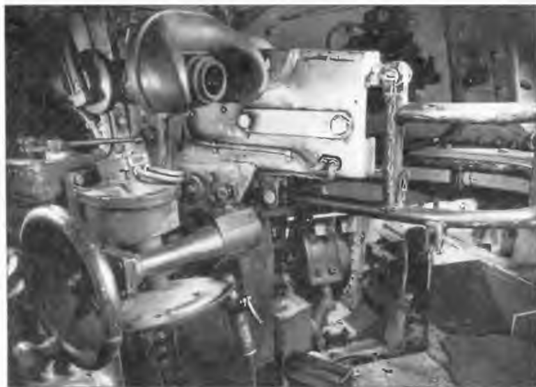
Интерьер башни танка Pz.IV Ausf.G. По сравнению с танками, вооруженными короткоствольными пушками, после установки орудия KwK 40 в интерьере башни практически ничего не изменилось
