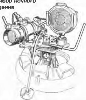
«Пантера» Ausf. G, с установленным на командирской башенке прибором ночного видения
