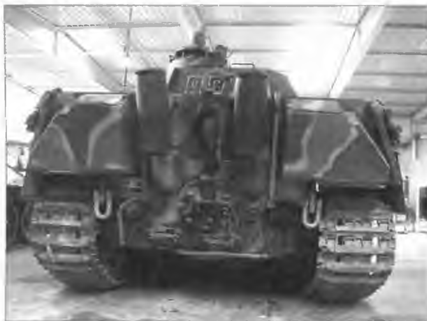
Вид на кормовой лист корпуса «Пантеры» Ausf.G позднего выпуска, о чем можно судить по пламегасителям на выхлопных трубах
