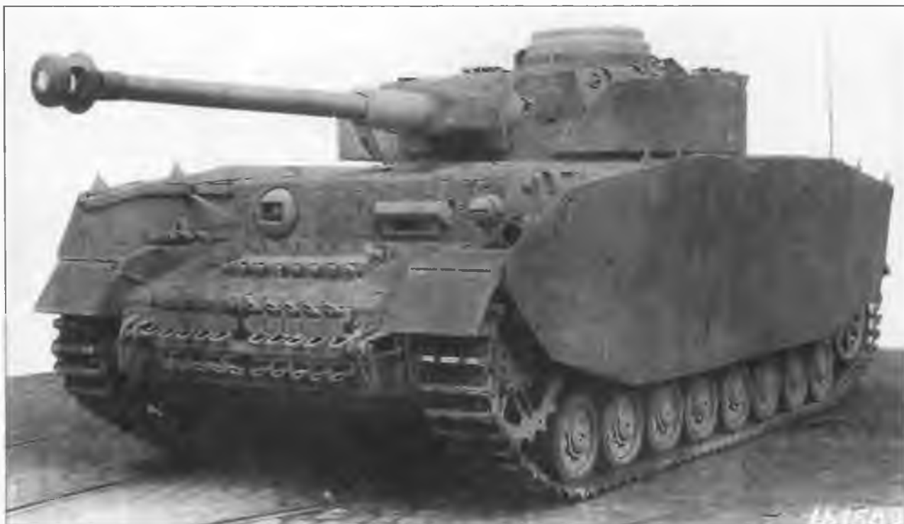
Pz.IV Ausf.H с полным комплектом бортовых экранов и нанесенным «циммеритным» покрытием. Машина изготовлена в сентябре 1943 года и подготовлена для испытаний «циммерита»
