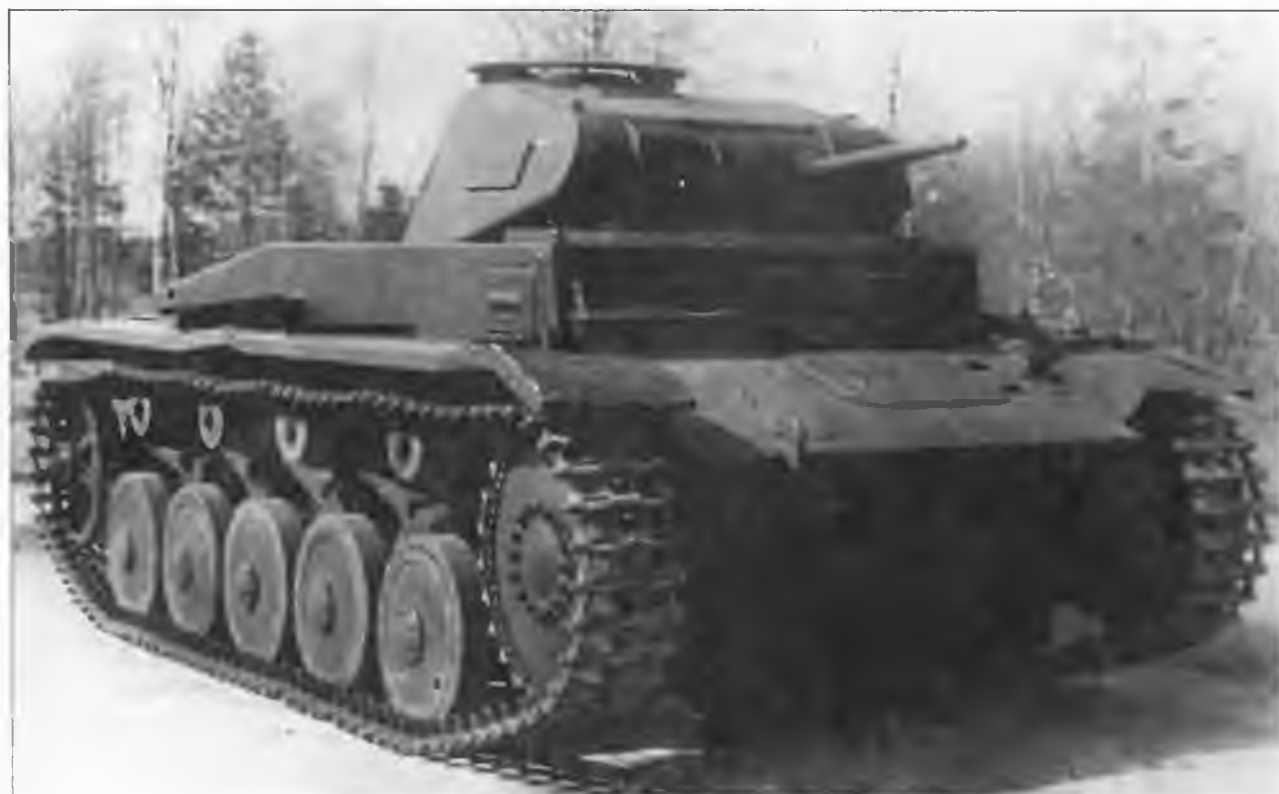
Вверху: заправка топливом танка Pz.II во 2-й танковой бригаде. После Польской кампании лобовая броня танков Ausf. с, А и В была усилена накладными листами. Опылательный знак – черныи крест в белой окантовке – был введен с 26 октября 1939 года Внизу: легкий танк Pz.II Ausf.D
