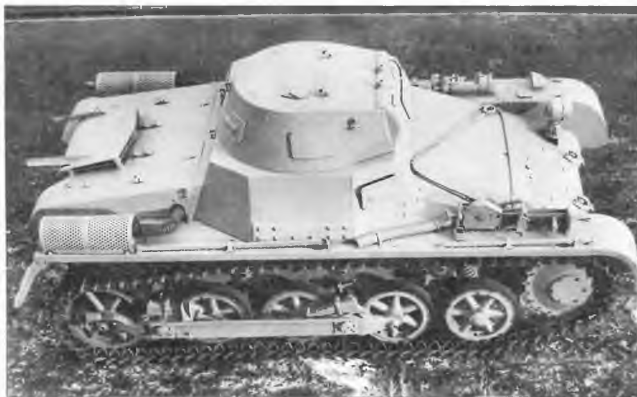
Один из первых серийных Pz.I Ausf.A. На снимках хорошо видны характерные сетчатые кожухи глушителей и укладка принадлежностей и инструмента на надгусеничных полках. Рукав, закрепленный на правой полке, предназначен для подвода воздуха к вентилятору системы охлаждения тормозов
