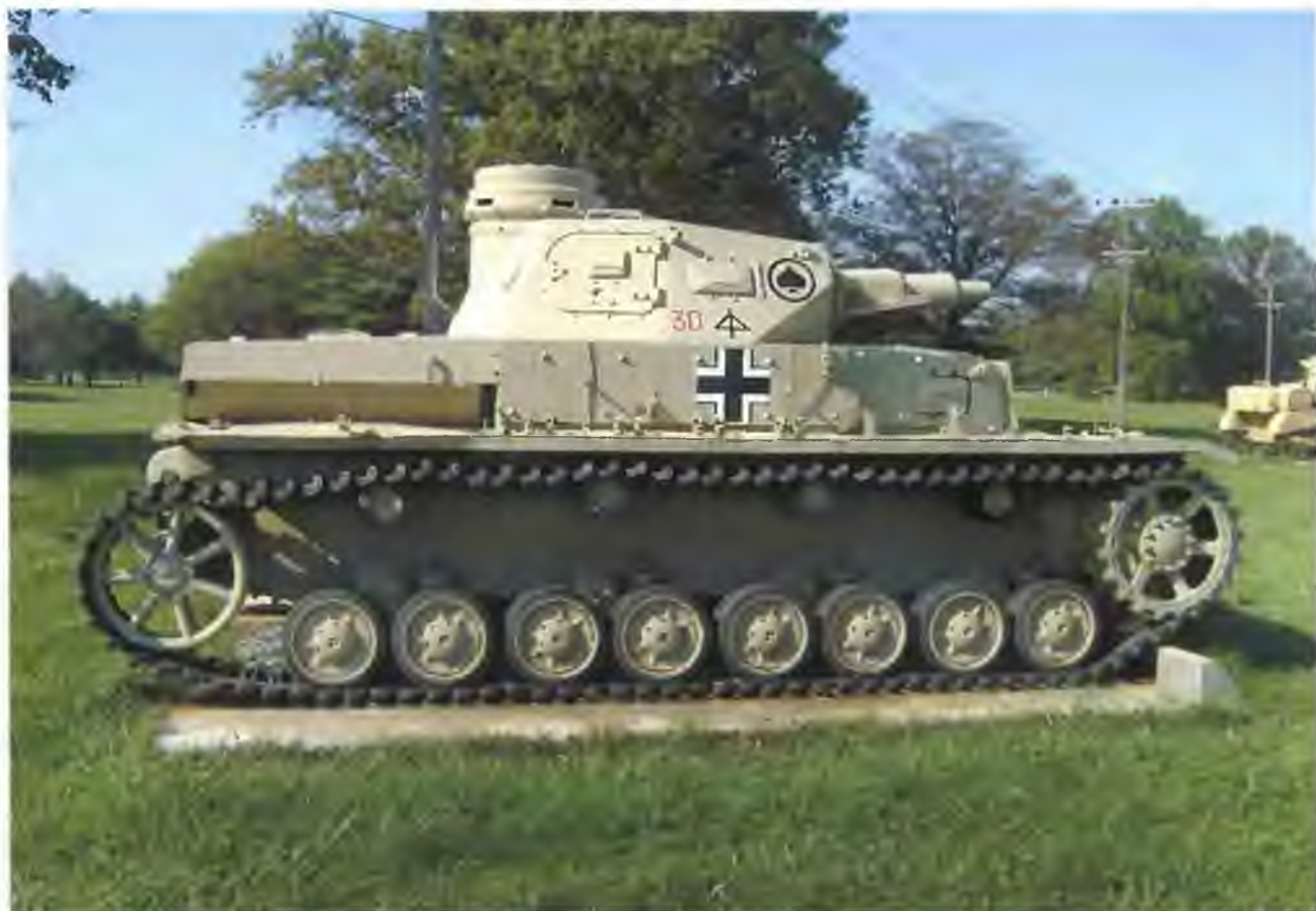
Panzer IV Ausf.D в экспозиции военного музея на Абердинском полигоне в США. Машина прошла частичную модернизацию в ходе войскового ремонта, в частности направляющее колесо заимствовано у Ausf.F
