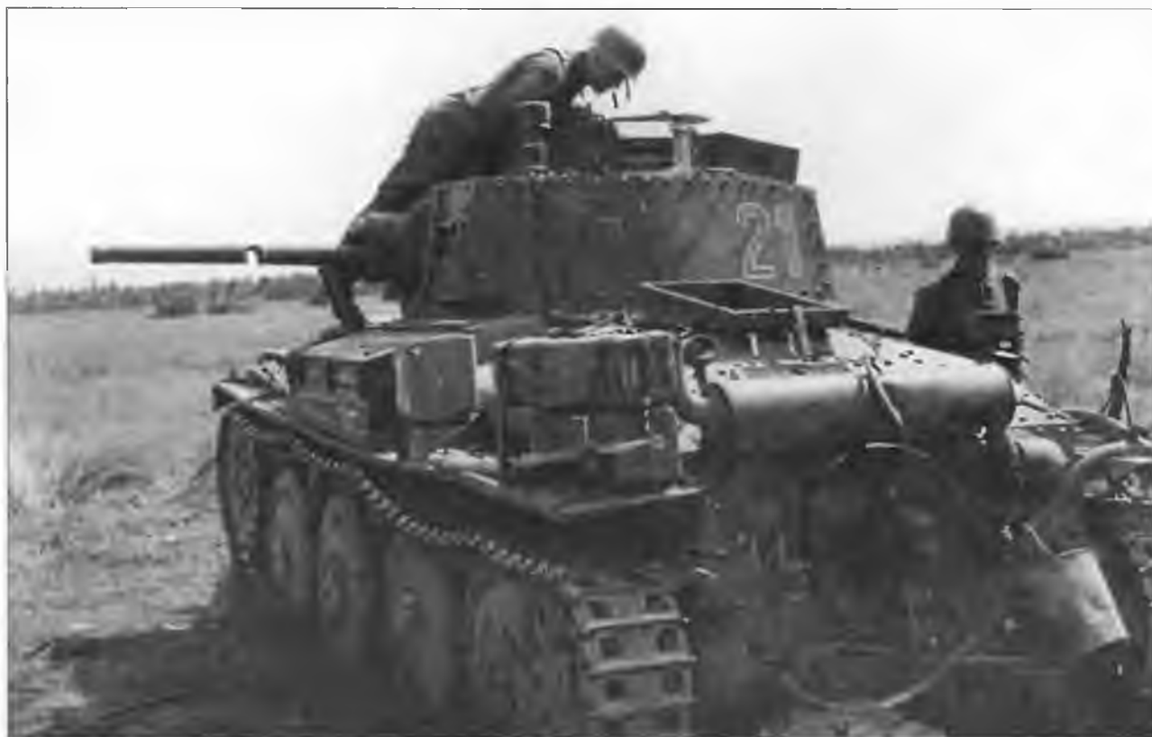
Красноармейцы осматривают подбитый танк Pz.38(t) Ausf.G из состава 20-й танковой дивизии. Обращает на себя внимание ствол пушки вражеского танка, пробитый советским снарядом! Западный фронт, июль 1941 года
