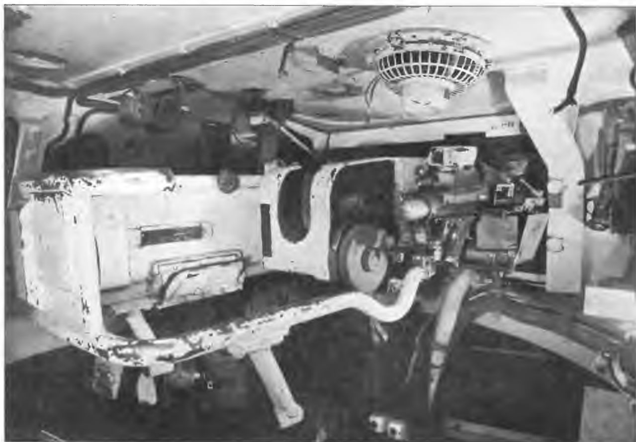
Интерьер башни танка Pz.IV Ausf.E. Хорошо видны ка- зенная часть пуш- ки, спаренный пу- лемет, огражде- ние пушки, башенный вентиля- тор, налобник и окуляр телескопи- ческого прицела, маховик подъем- ного механизма
