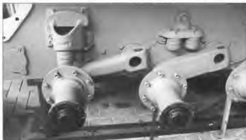
Элементы ходовой части танка «Пантера»: отбойный ролик (в центре); балансиры опорных катков и ограничители их хода (внизу)
