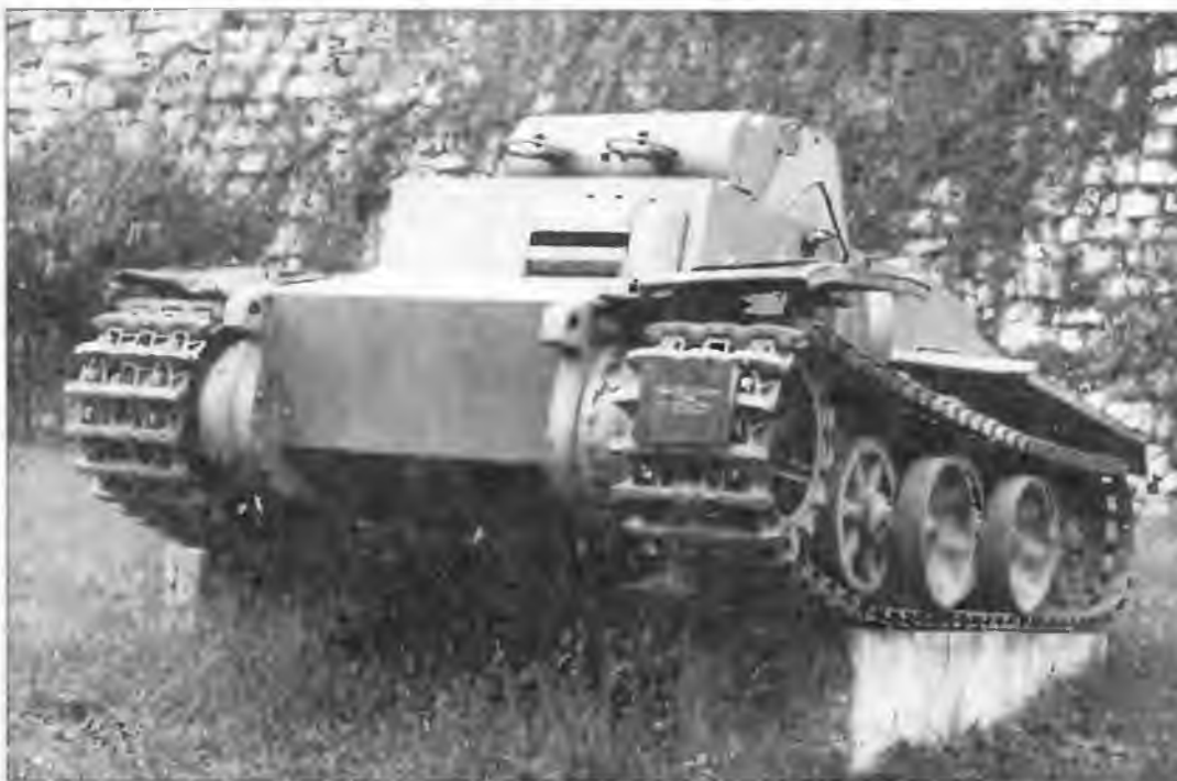
Pz.I Ausf.F в военном музее Белграда. У этой машины полностью отсутствуют резиновые бандажи опорных катков
