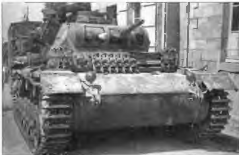
Уже во время Французской кампании 1940 года немцы начали использовать запасные гусеницы для усиления бронезащиты своих танков, в данном случае – Pz.III Ausf.E (слева и внизу)
