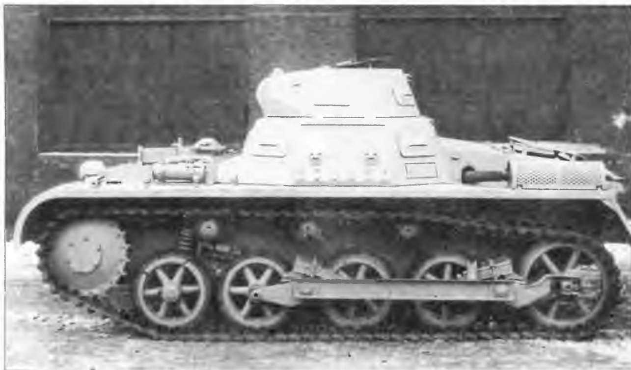
Один из первых серийных Pz.I Ausf.A. На снимках хорошо видны характерные сетчатые кожухи глушителей и укладка принадлежностей и инструмента на надгусеничных полках. Рукав, закрепленный на правой полке, предназначен для подвода воздуха к вентилятору системы охлаждения тормозов
