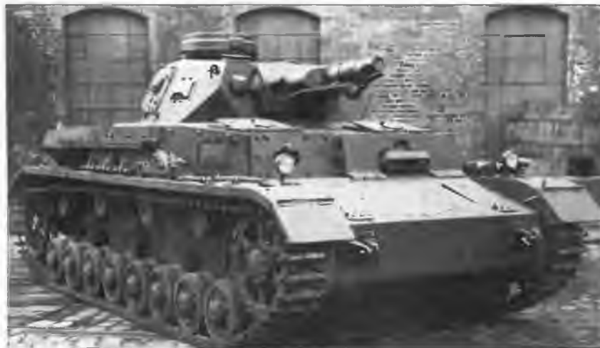
Pz.IV Ausf.E во дворе завода. Обращают на себя внимание 30-мм накладная броня корпуса и отбойник для отгибания антенны под стволом орудия
