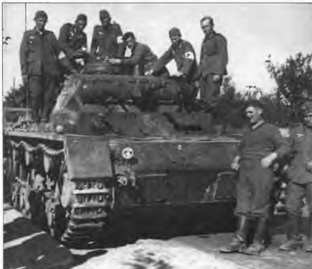
Немецкие солдаты осматривают танк Pz.III Ausf.D, подбитый польской противотанковой артиллерией. На лобовой 14,5-мм броне машины хорошо видны несколько пробоин от 37-мм снарядов. Польша, 1939 год
