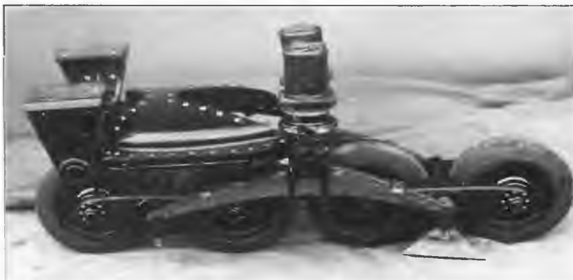
Тележка подвески «грострактора» фирмы Daimler-Benz
