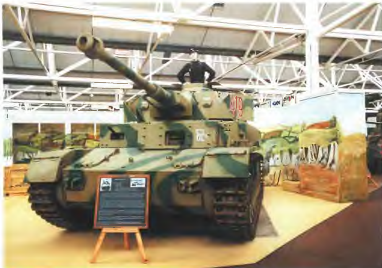
Жертва большого ремонта: Panzer IV Ausf. D перевооруженный 75-мм длинноствольной пушкой. Королевский танковый музей в Бовингтоне, графство Дорсет, Англия.
