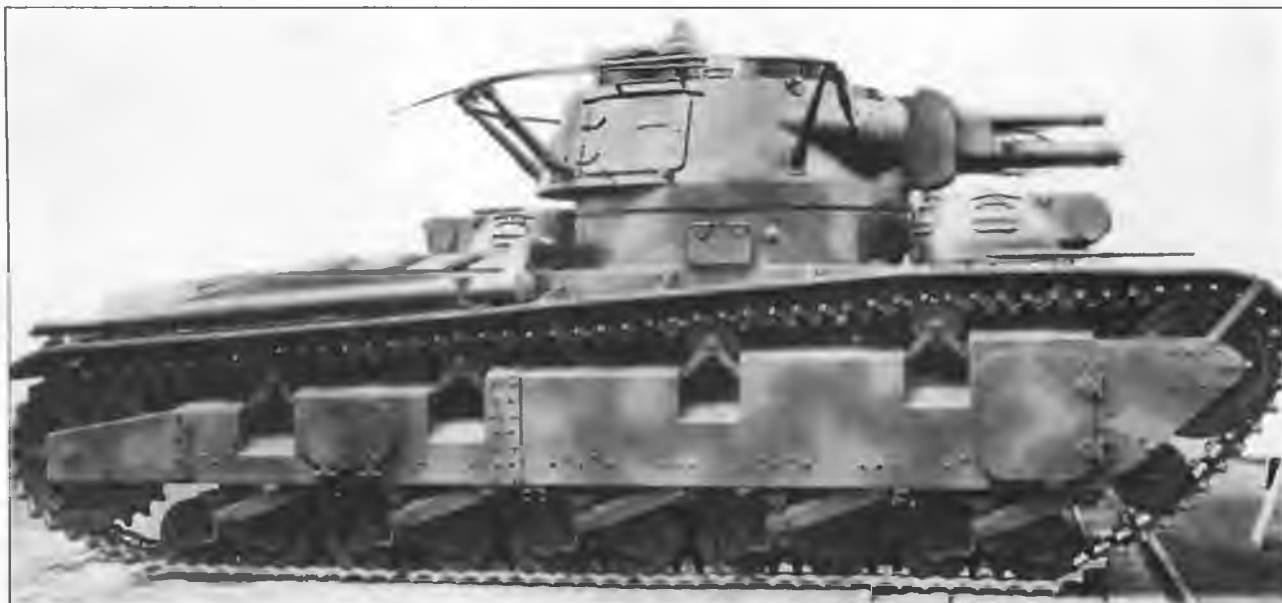
Средний танк Nb.Fz. №1 с башней фирмы Rheinmetall
