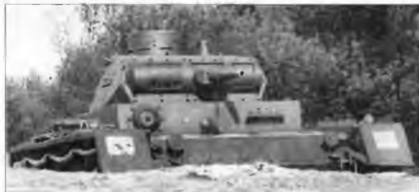
Танк Pz.III варианта В или С на полигоне. 1938 год. Модификации В и С отличались только ходовой частью, которая на этой фотографии не видна
