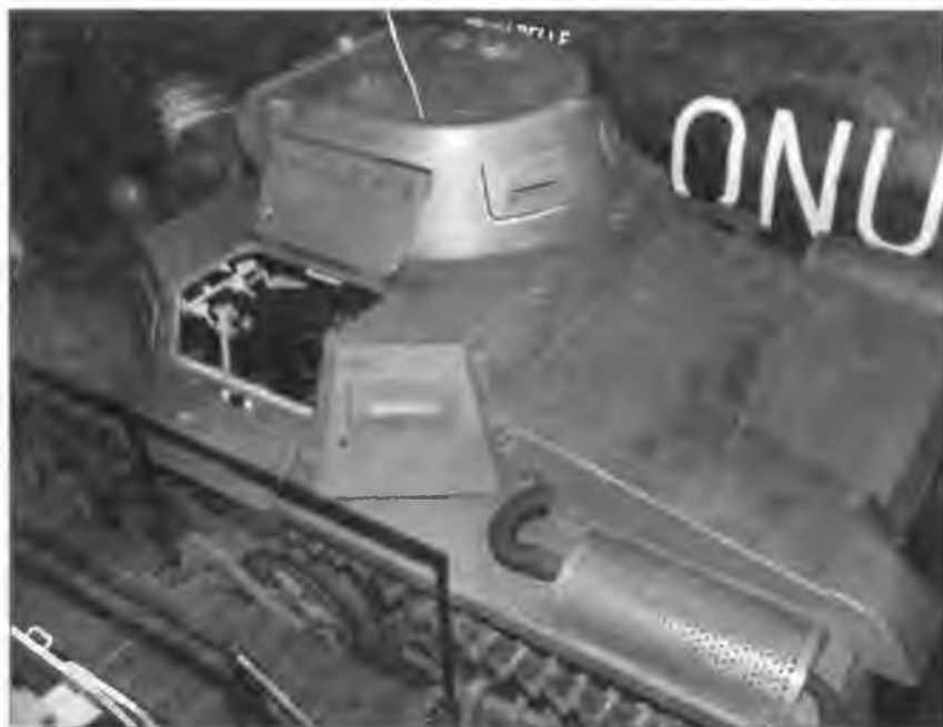
Вид сверху на Pz.I Ausf.A (фото сверху). Хорошо видны сетчатое ограждение глушителя и открытый посадочный люк механика-водителя
