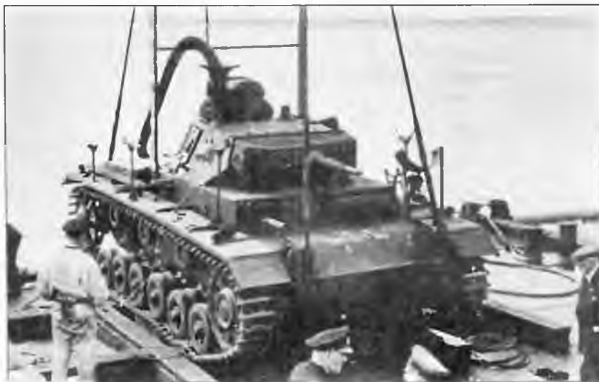
Начало испытаний Tauchpanzer III: танк поднимают краном для последующего опускания в воду. 1940 год
