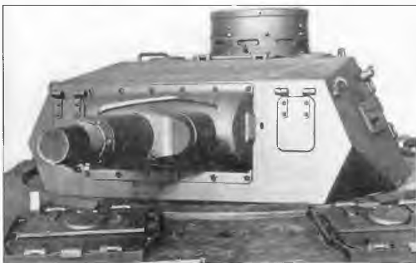
Башня танка Pz.IV Ausf.A. Следует отметить, что за время серийного производства конфигурация башни практически не изменилась
