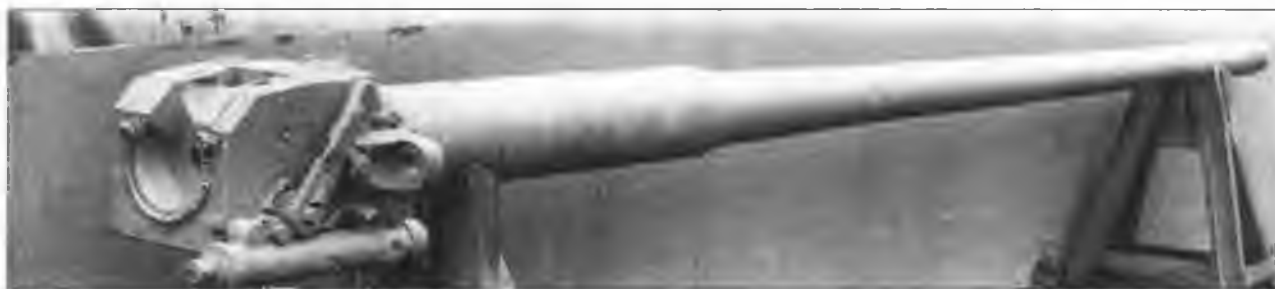
Ствол пушки KwK 42 без тормоза отката, накатника и дульного тормоза
