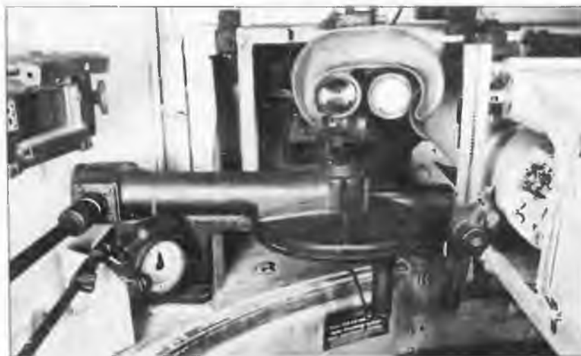
Место наводчика танка «Тигр». На переднем плане – механизм ручного привода поворота башни, над ним – окуляры бинокулярного прицела TZF 9a
