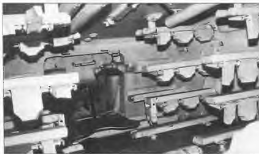
Стеллажи для размещения орудийных выстрелов в нише башни. Между ними – дверца люка для загрузки боеприпасов и аварийного выхода из танка
