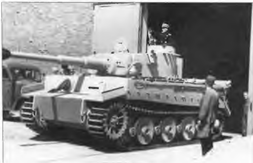
Серийный «Тигр» выезжает из цеха. Машина оснащена узкими транспортными гусеницами; наружный ряд опорных катков демонтирован
