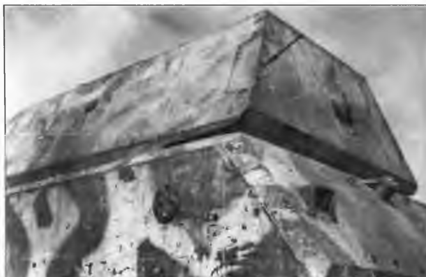
Вид соединения кормового листа башни с левым бортовым листом. Стрелкой указан штифт
