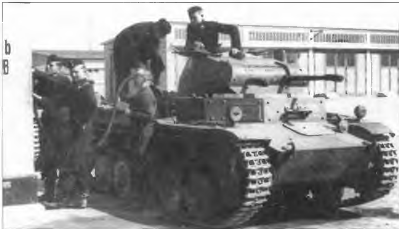
Вверху: заправка топливом танка Pz.II во 2-й танковой бригаде. После Польской кампании лобовая броня танков Ausf. с, А и В была усилена накладными листами. Опылательный знак – черныи крест в белой окантовке – был введен с 26 октября 1939 года Внизу: легкий танк Pz.II Ausf.D
