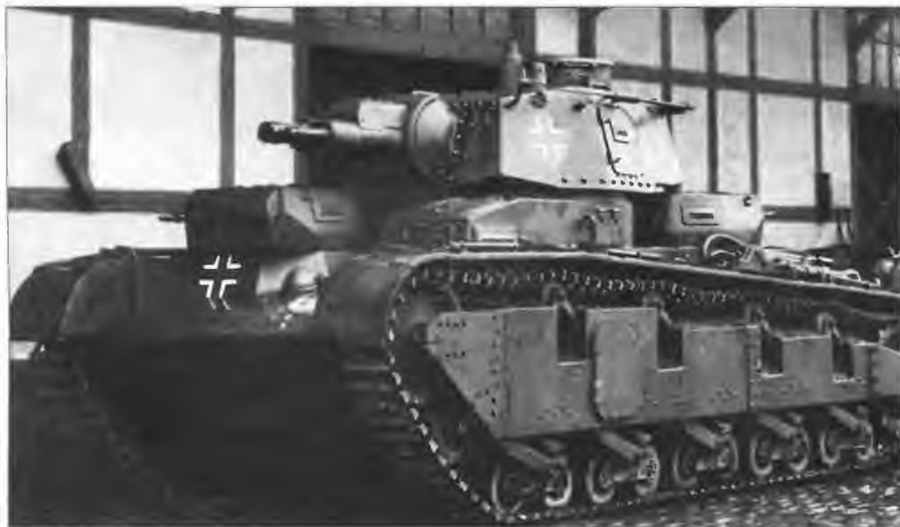
Танк Nb.Fz. в Осло, 1940 год. Хорошо видны маска пушек и поручневая антенна на башне
