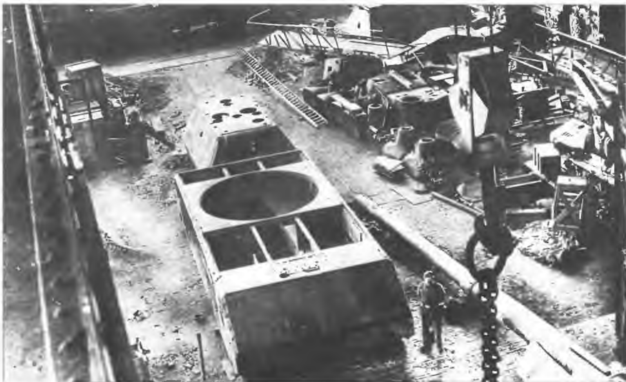
Корпус и башня танка «Маус», захваченные союзниками в сборочном цеху завода фирмы Krupp в Эссене. 1945 год
