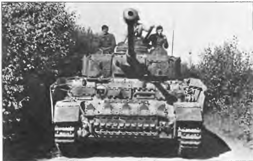
Pz.IV Ausf.H совершает марш во время операции «Цитадель». Июль 1943 года. Лобовые детали башни и корпуса дополнительно защищены не только штатными немецкими траками, но и трофейными — от T-34
