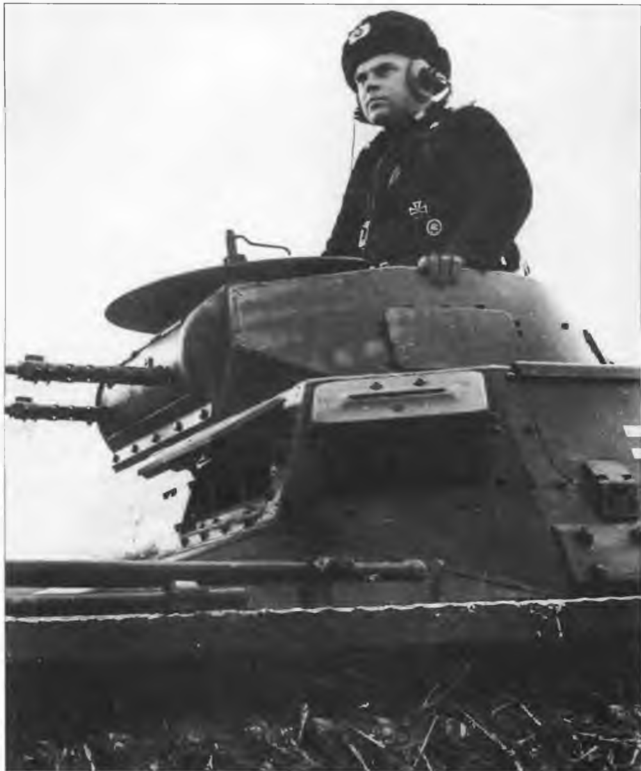
Pz. I Ausf. B и немецкий танкист крупным планом. Танки Pz. I разных модификаций легко идентифицировать по размещению ЗИПа и инструментов на надгусеничных полках. У этого танка на надгусеничной полке впереди слева размещены лопата и топор (их рукоятки видны на снимке), но нет огнетушителя. Значит, это машина модификации «В», у которой огнетушитель располагался слева сзади
