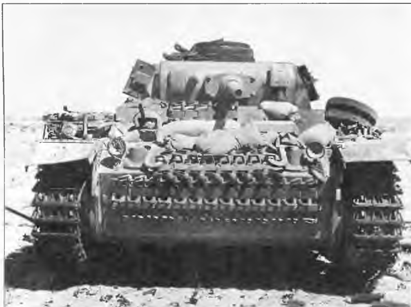
Танк Pz.III Ausf.J перед боем. Лобовая броня машины усилена не только запасными траками гусениц, но и мешками с песком. Северная Африка, 1941 год
