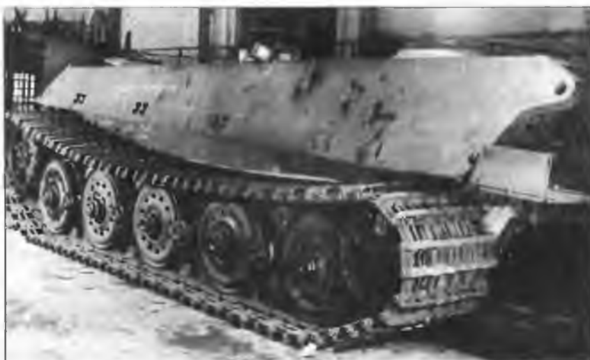
Корпус и ходовая часть танка «Королевский тигр»
