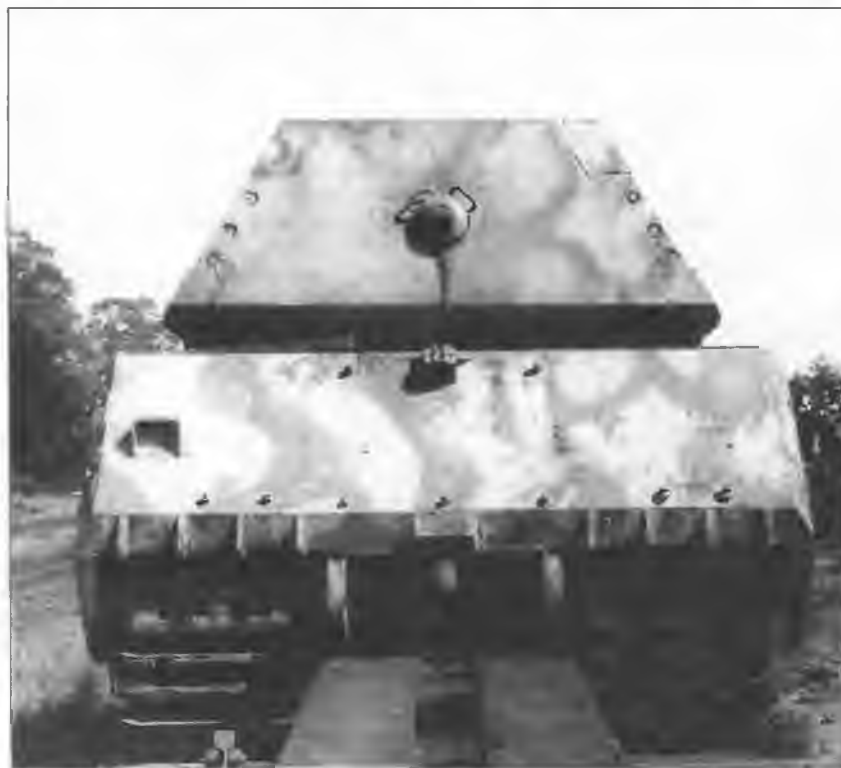
«Маус» на платформе перед отправкой в СССР (фото слева и внизу). В лобовой броне корпуса хорошо видны вмятины от снарядов, что позволяет утверждать, что немцы проводили испытания первого прототипа обстрелом. Возможно, впрочем, что это следы от советских снарядов. Обращает на себя внимание массивная литая крышка люка для загрузки боеприпасов в кормовом листе башни. Хорошо различимы шиповые соединения кормового и бортовых листов и штифты
