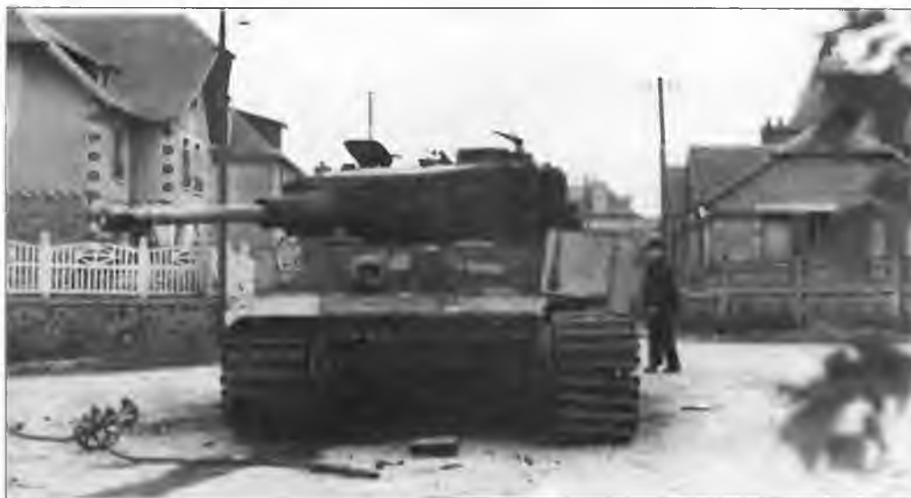
У этого «Тигра» взрывом боекомплекта сорвало с погона башню. На лобовой броне танка виден значок 1-й роты 101-го батальона СС. Нормандия, июнь 1944 года
