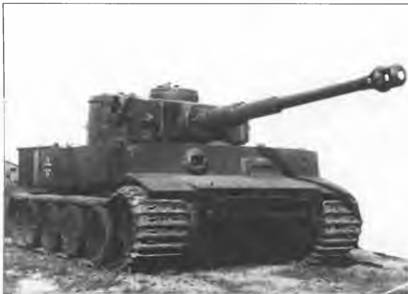
Первый «Тигр», захваченный Красной Армией, на НИБТПолигоне в Кубинке. Скобы на нижнем лобовом листе корпуса предназначены для запасных траков; на двух скобах на правом борту башни крепились ящики для снаряжения. На лобовом листе подбашенной коробки слева изображение мамонта – эмблема 502-го тяжелого танкового батальона, справа – приварена подкова, видимо, «на счастье»...
