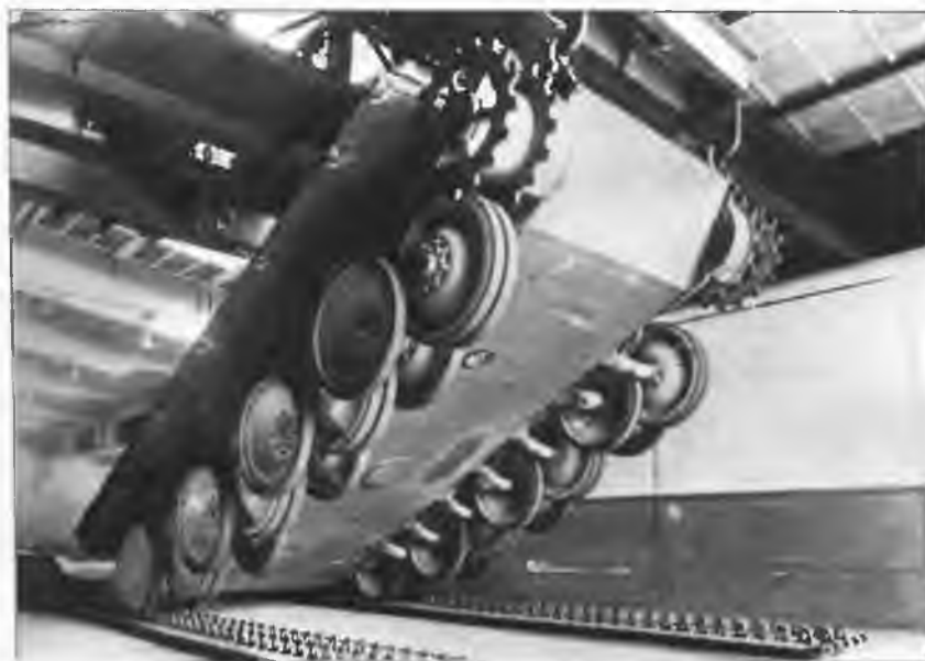
Первые серийные «пантеры» на сборочной линии фирмы MAN. 1943 год (вверху). Монтаж гусениц в заводском цехе (слева)
