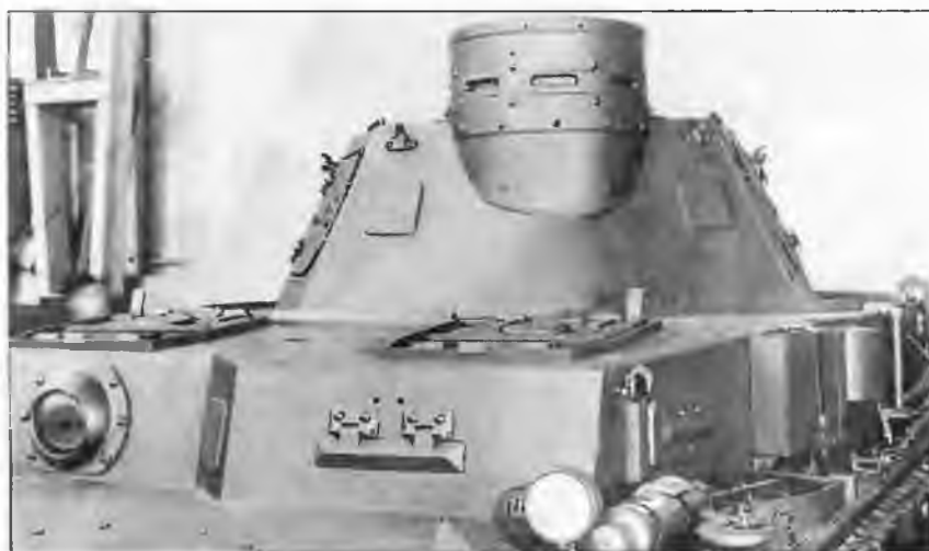
Башня танка Pz.IV Ausf.A. Следует отметить, что за время серийного производства конфигурация башни практически не изменилась
