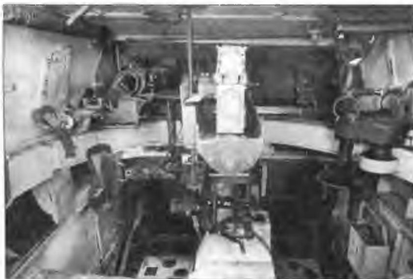
Интерьер боевого отделения танка Luchs , вид на переднюю часть башни. Справа – механизм поворота башни, в центре – казенная часть 20-мм пушки, слева – кронштейн крепления пулемета
