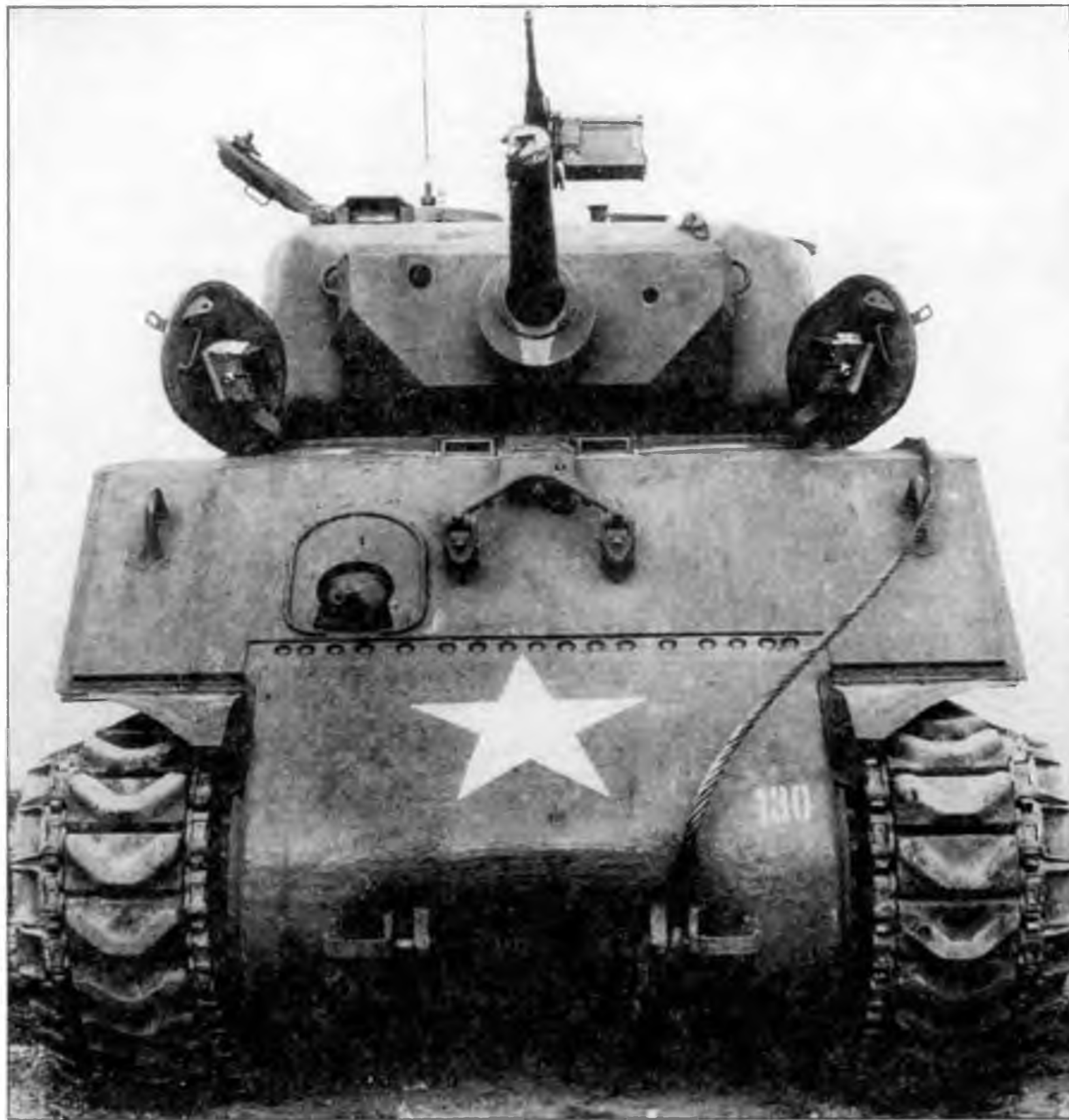
Серийный танк М4А3Е2. Хорошо видно усиленное по сравнению с обычным «Шерманом» бронирование корпуса и башни (слева и внизу)
