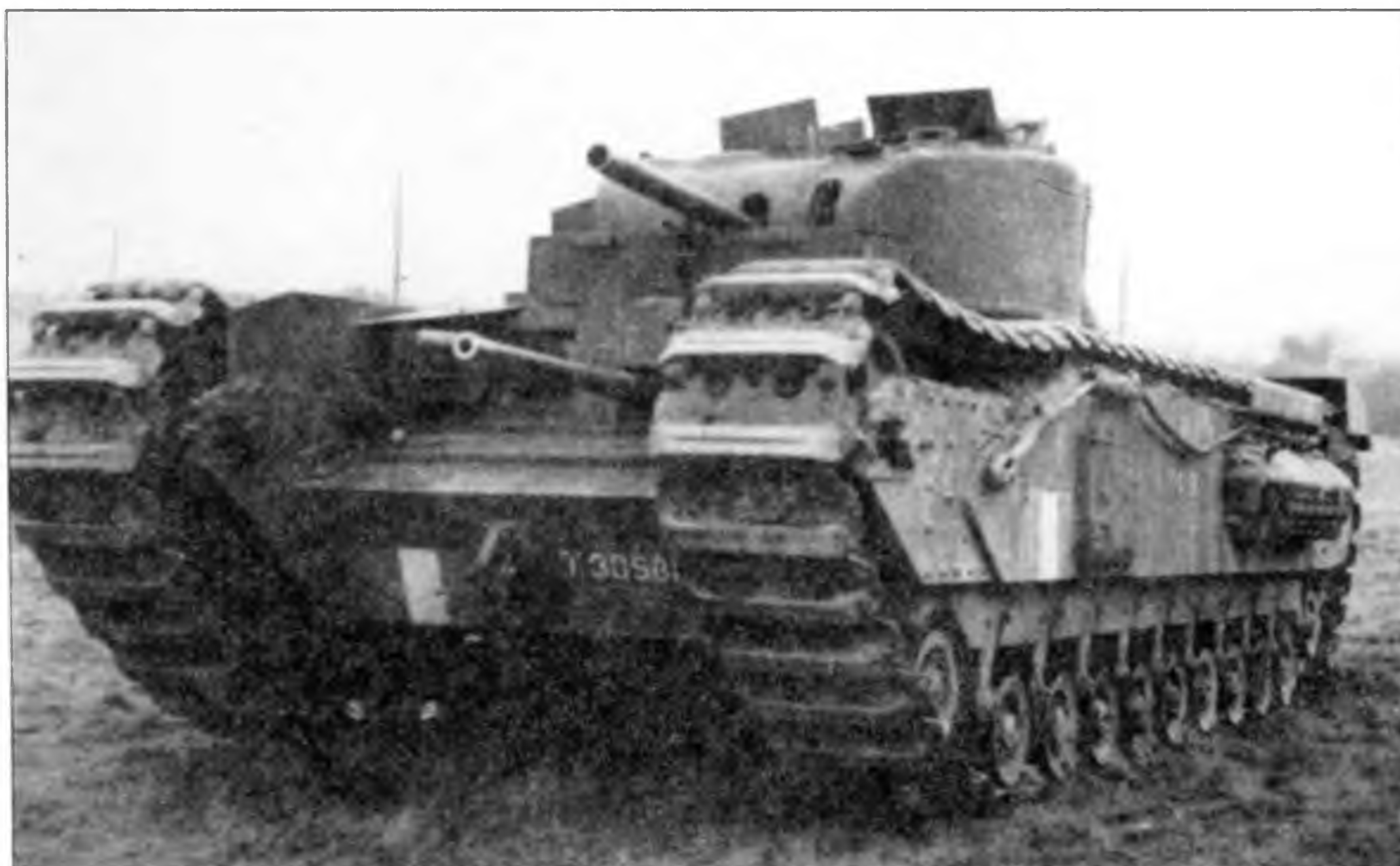
Пехотный танк Churchill IIC. 76-мм гаубица установлена в башне
