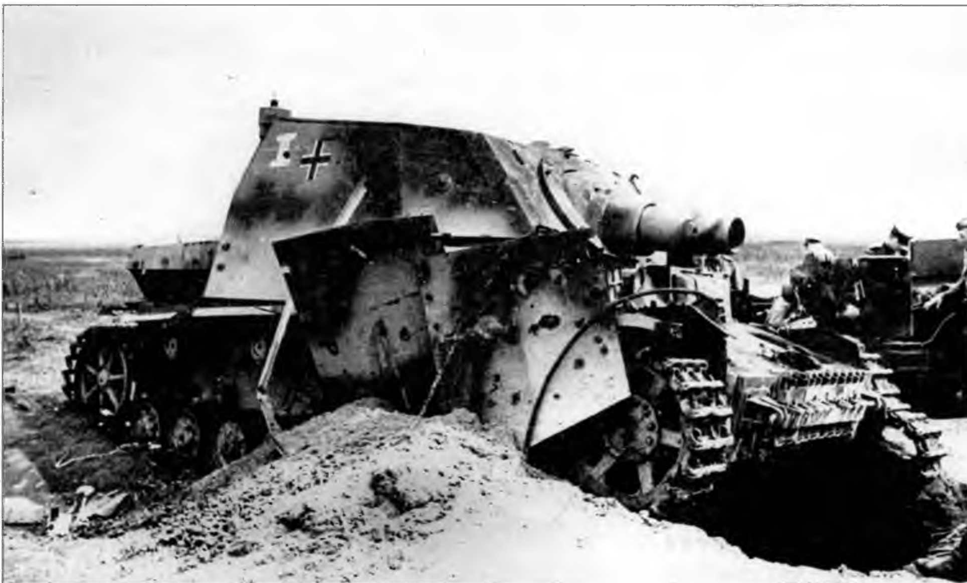
«Бруммеры», подбитые на Курской дуге. 19 июля 1943 года. Машины этого типа, принимавшие участие в операции «Цитадель», не имели «циммеритного» покрытия
