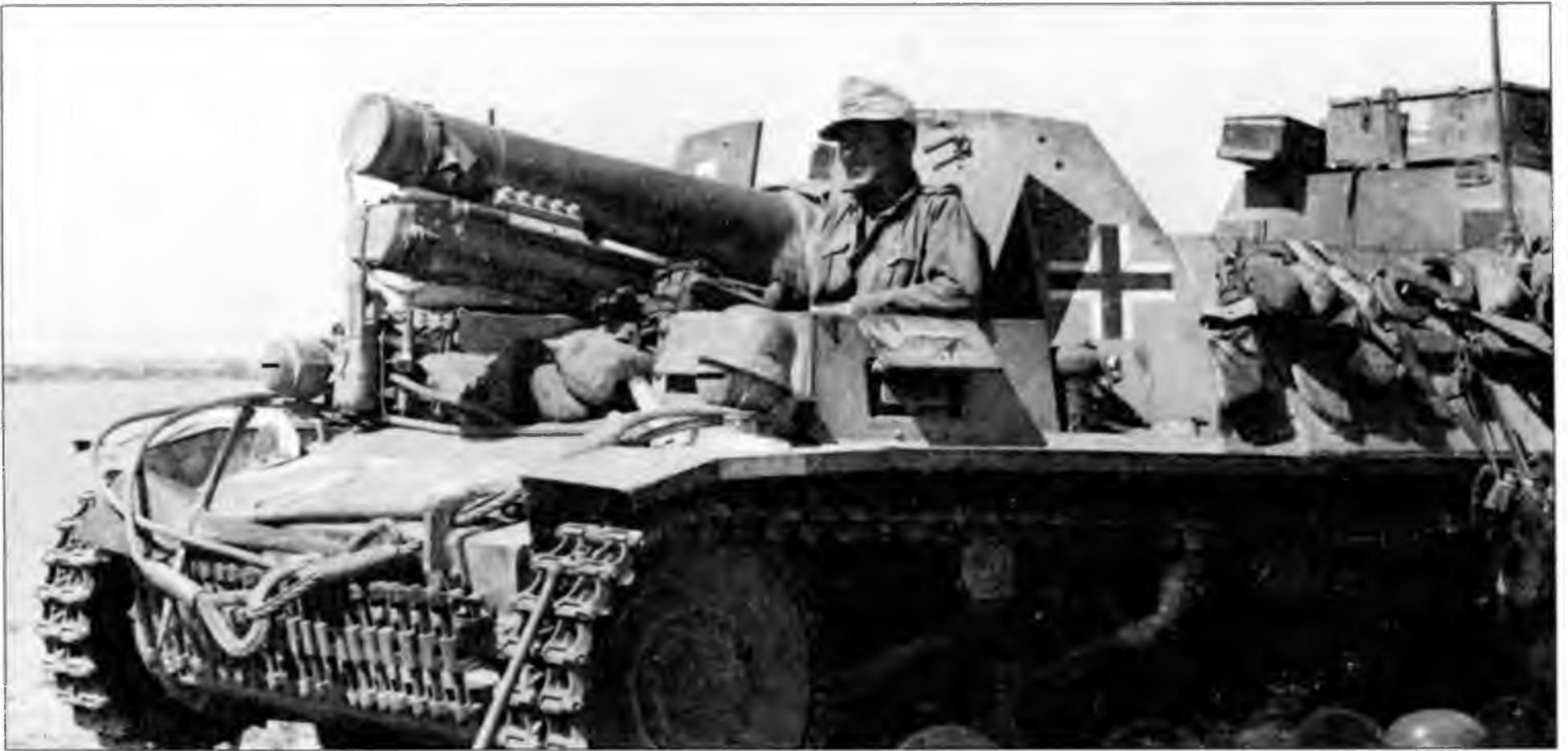
Sturmpanzer II в Африке. Механик-водитель стоит в люке своей рубки. На дульный срез орудия надет пылезащитный чехол, что было особенно актуально в условиях пустыни
