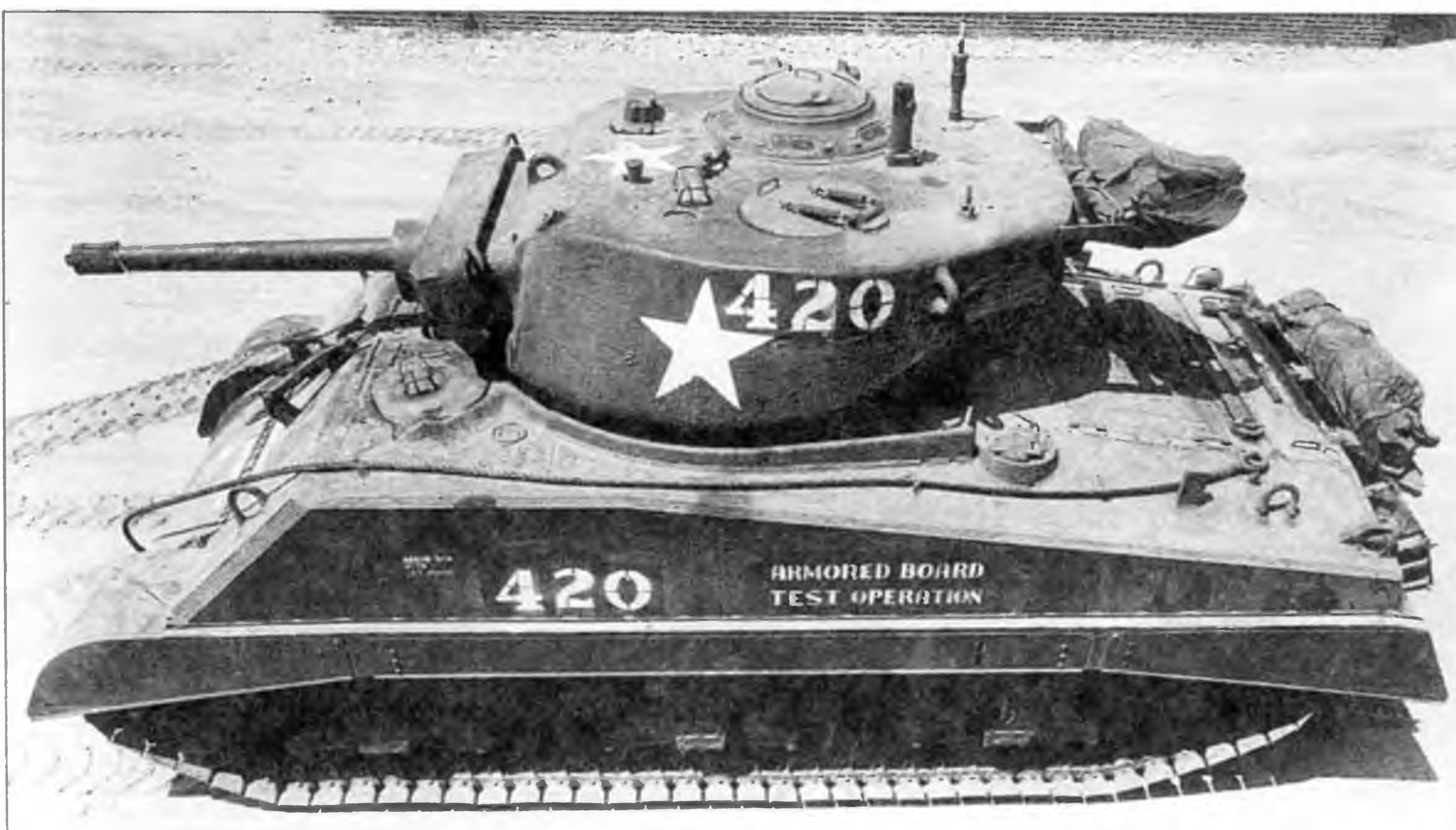
Серийный танк M4A3E2, подготовленный к испытаниям на полигоне в Форт Нокс. Для снижения удельного давления все машины этой модификации оснащались уширителями гусениц. Весна 1944 года
