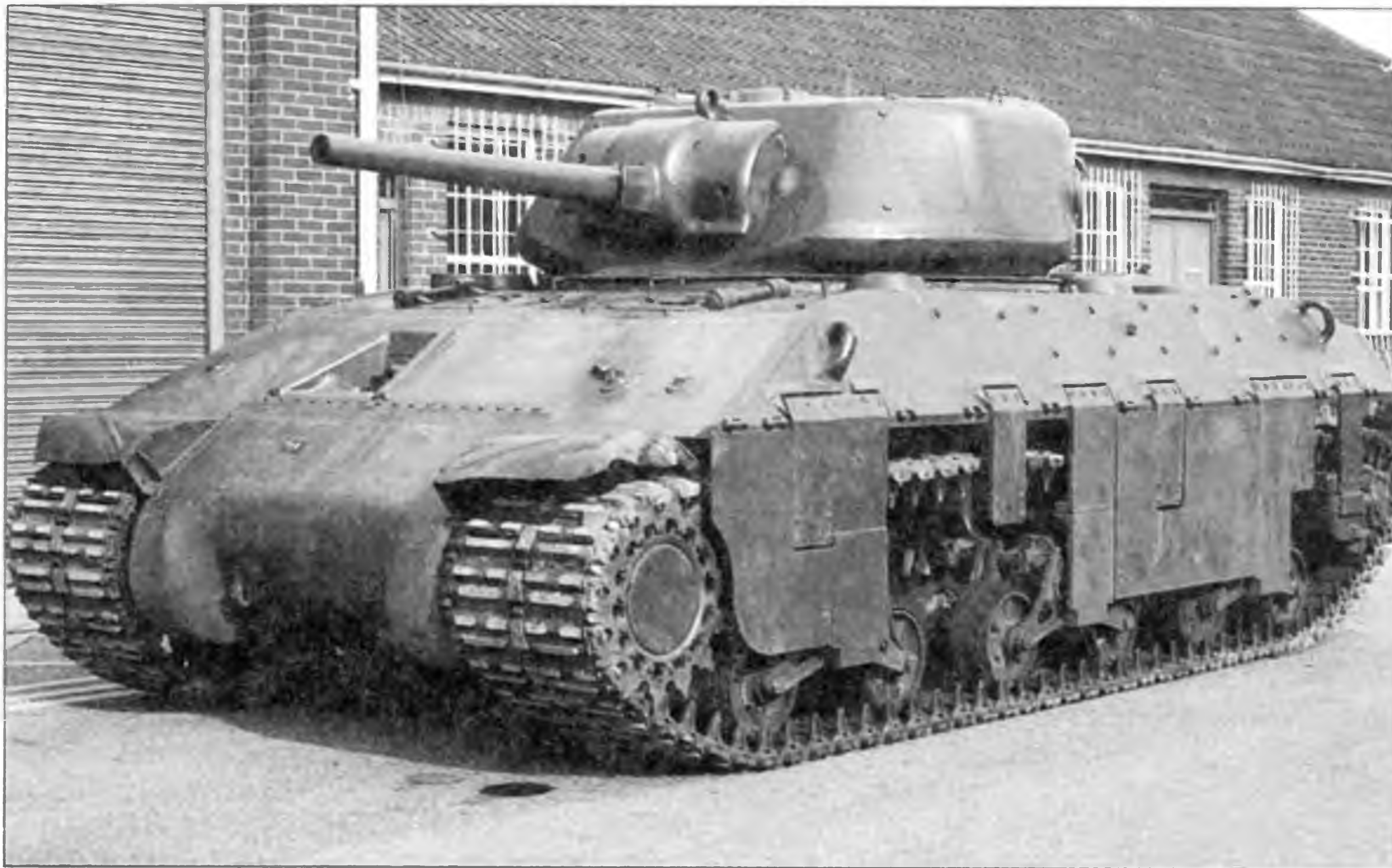
Опытный штурмовой танк T14. Эта 47-тонная боевая машина, защищенная 130-мм броней, была изготовлена в двух экземплярах. Один из них проходил испытания в США, другой в 1943 году был отправлен в Великобританию, благодаря чему и сохранился в коллекции Бовингтона
