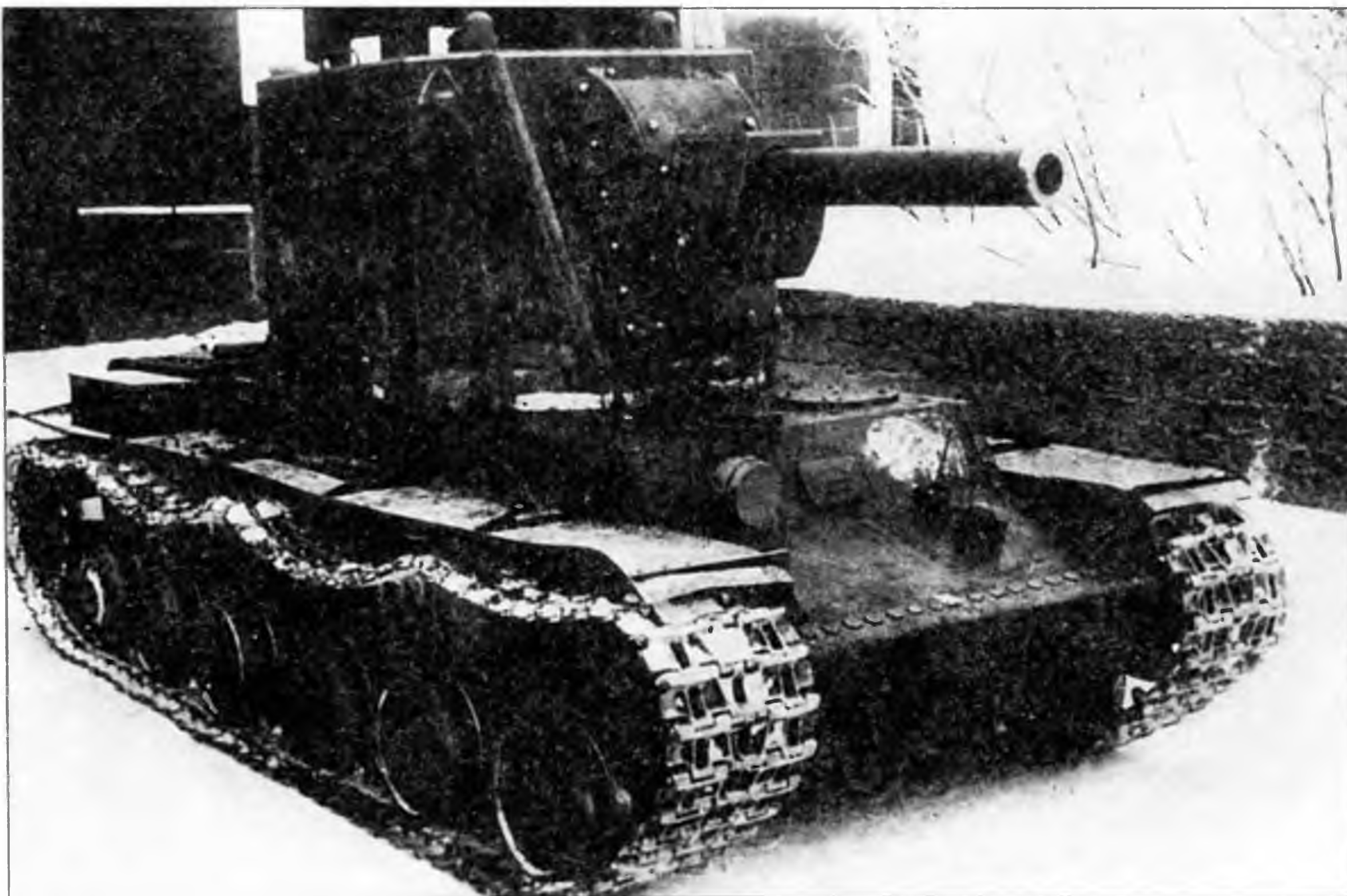
Танк КВ № У-0 с первым образцом башенной установки МТ-1 перед отправкой на фронт. Кировский завод, февраль 1940 года
