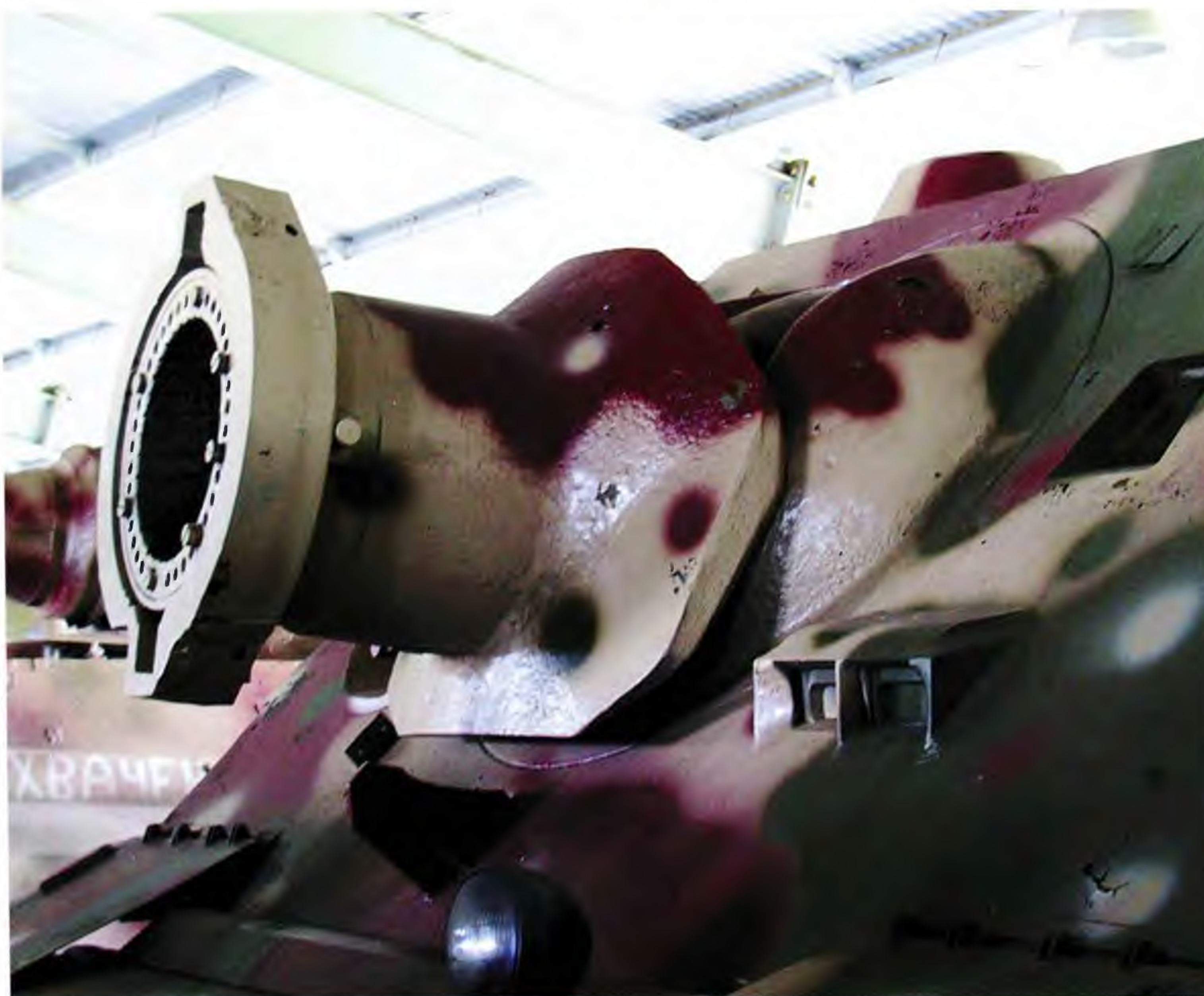
Шаровая установка 380-мм бомбомета на прототипе «Штурмтигра» (Кубинка)
