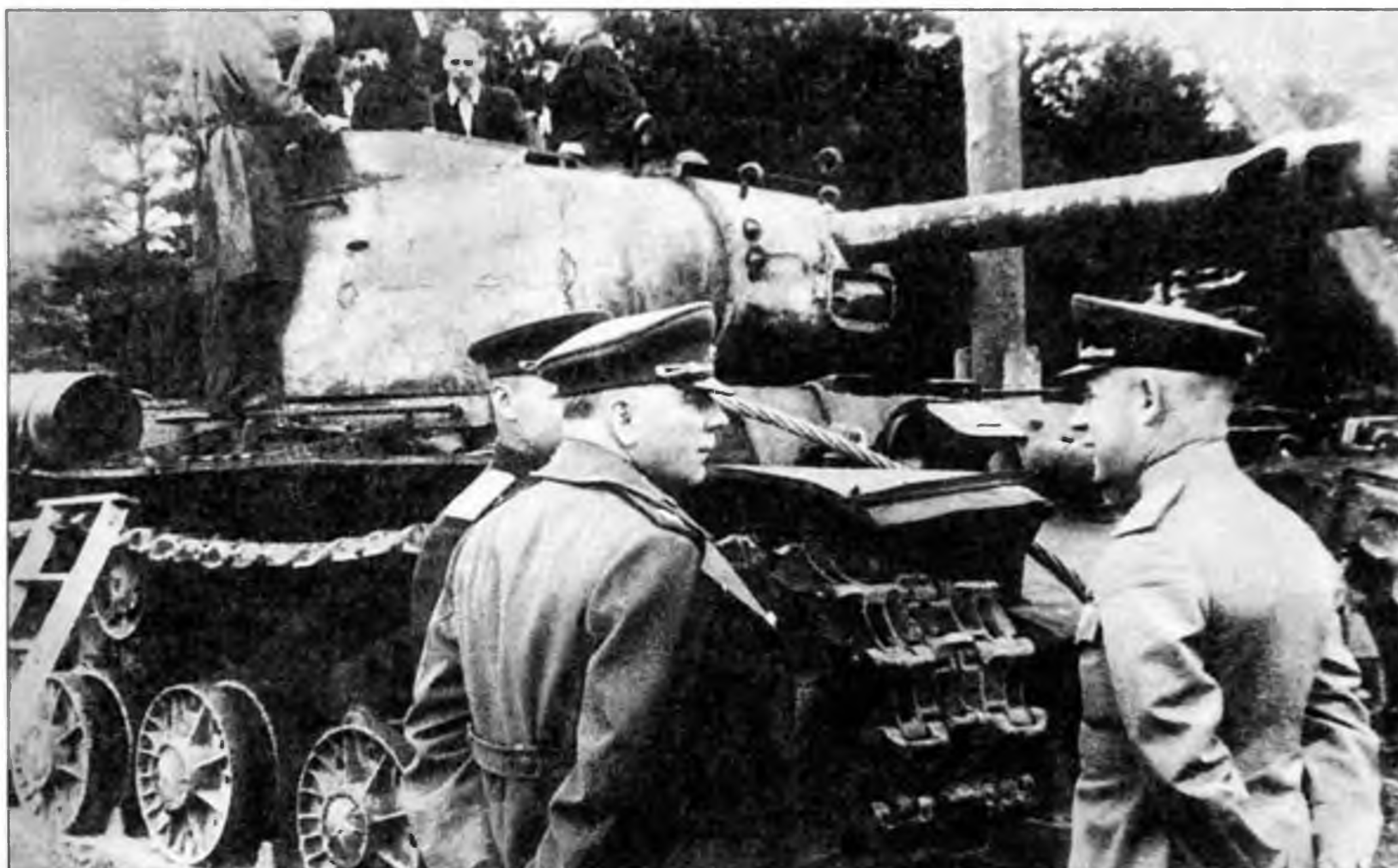
Маршал Советского Союза К.Е.Ворошилов осматривает танк КВ-1С с установленной на нем 152-мм гаубицей С-41. ЦАКБ, август 1943 года (справа и на с.79)
