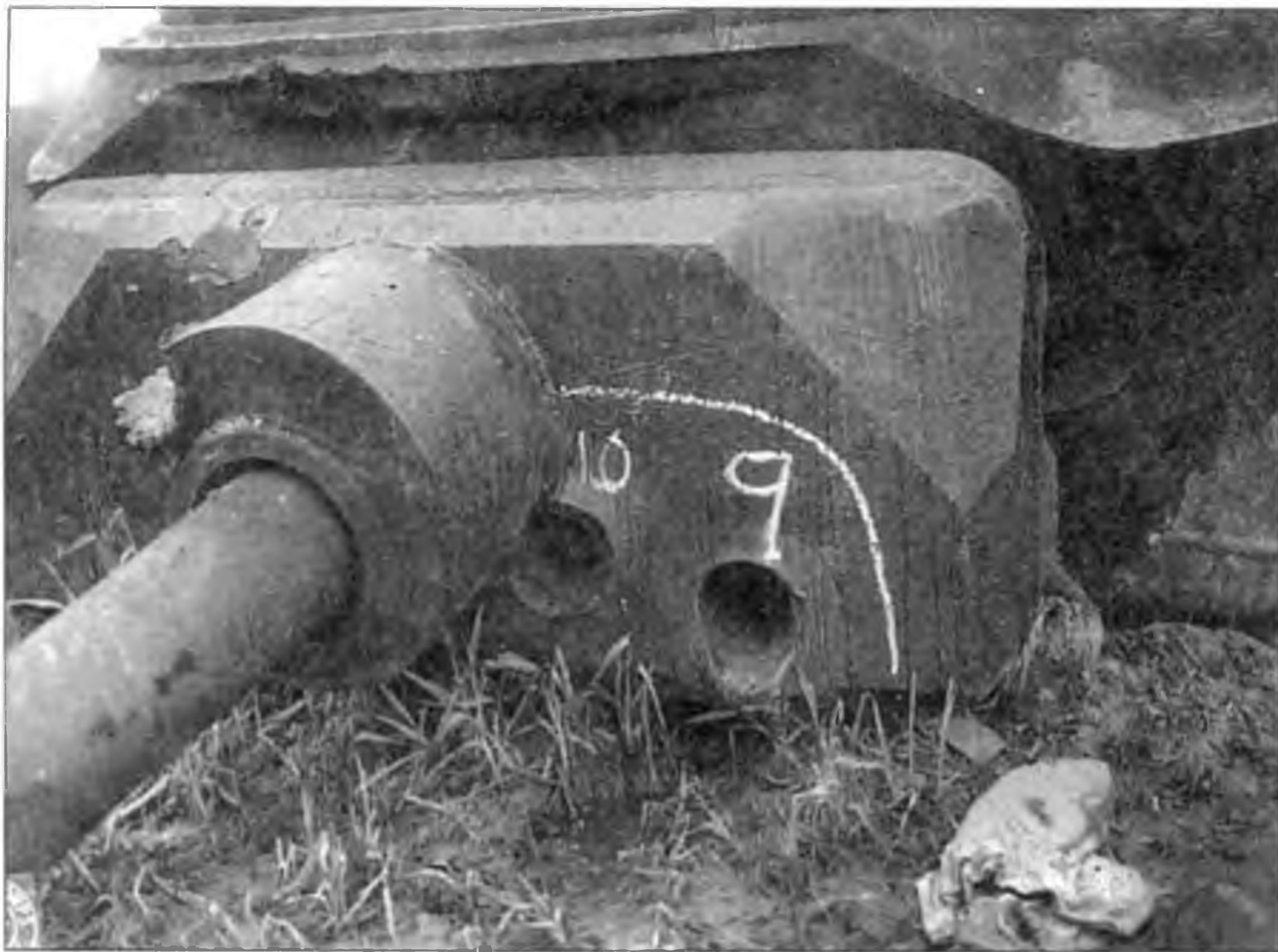
Башня танка М4А3Е2, сброшенная взрывом боекомплекта. Она выдержала два попадания 88-мм бронебойных снарядов, и лишь третье, поразившее танк прямо в амбразуру телескопического прицела (оно обозначено цифрой «9»), оказалось роковым
