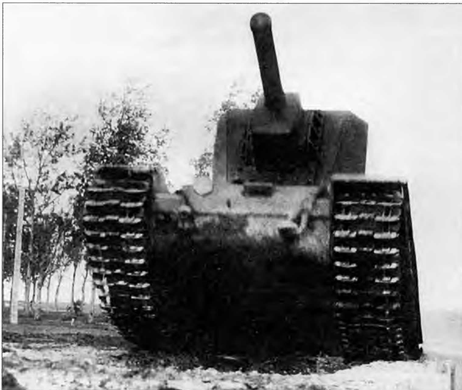
КВ № У-1 преодоле- вает вертикальную стенку высотой 0,7 м
