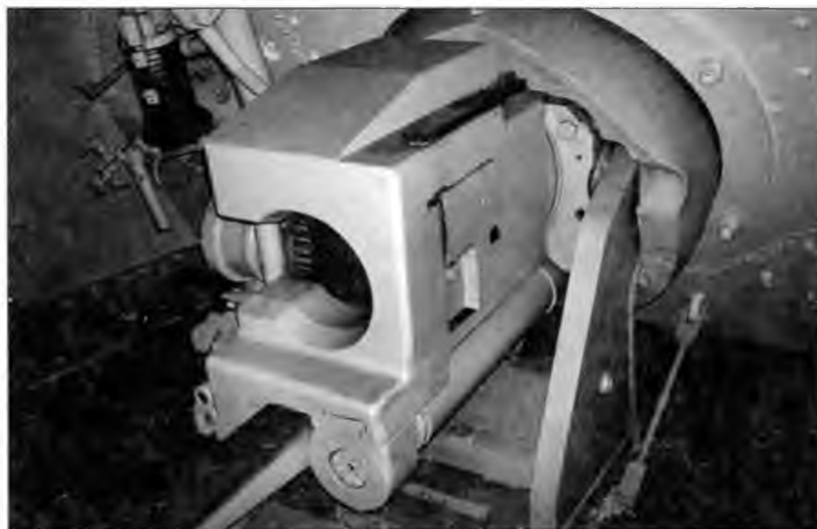
«Бруммеры» первой серии оснащались прибором наблюдения механика-водителя, заимствованным у тяжелого танка «Тигр» (вверху). Установка 150-мм гаубицы StuH 43 в лобовом листе рубки (в центре). Казенная часть и лафет штурмовой гаубицы (внизу)
