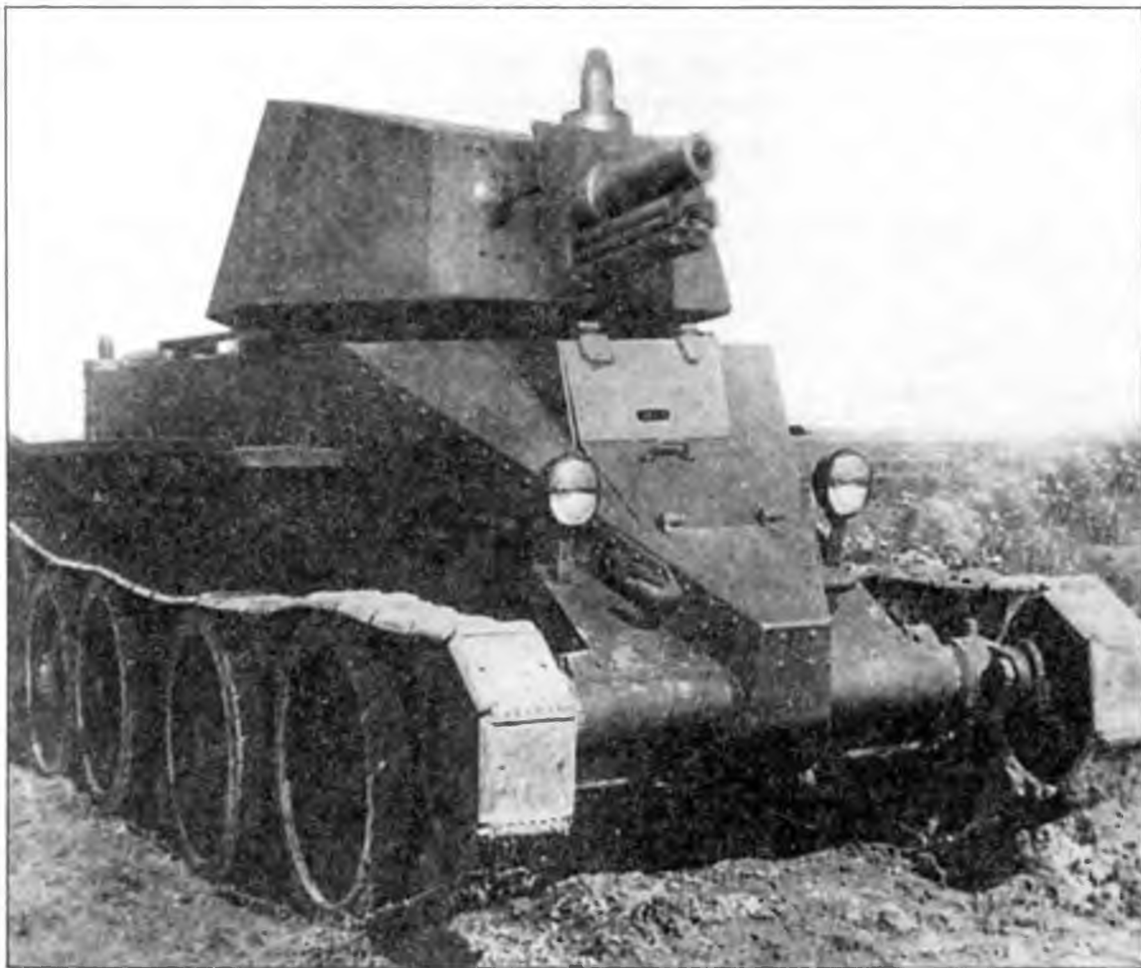
Колесно-гусеничный танк БТ с башней А-43
