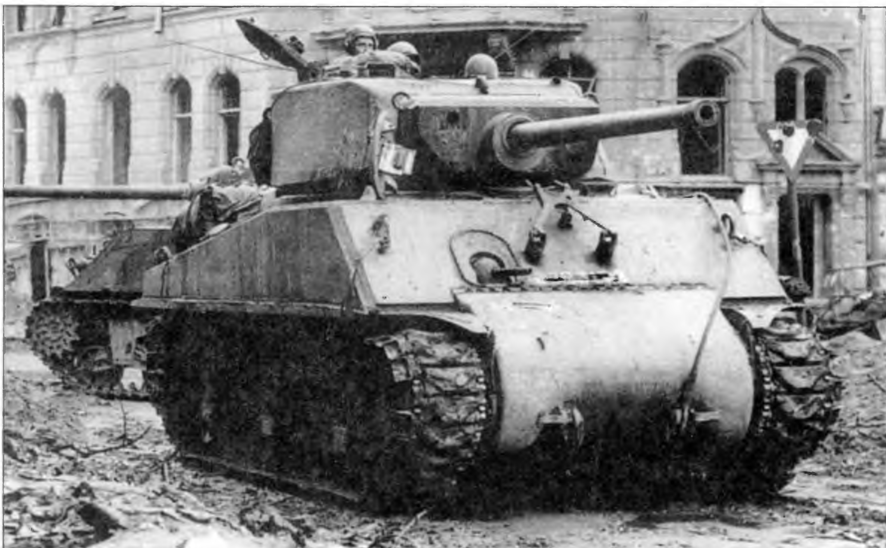
Штурмовой танк М4А3Е2 из состава 3-й танковой дивизии на улице Кельна во время боев за город. Март 1945 года. Эта машина также перевооружена 76-мм пушкой
