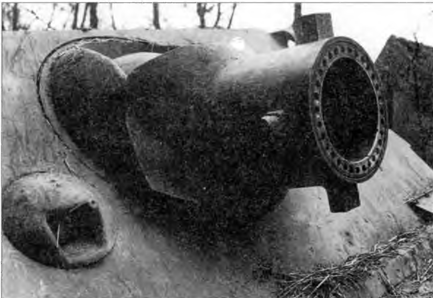
Шаровая установка 380-мм бомбомета
