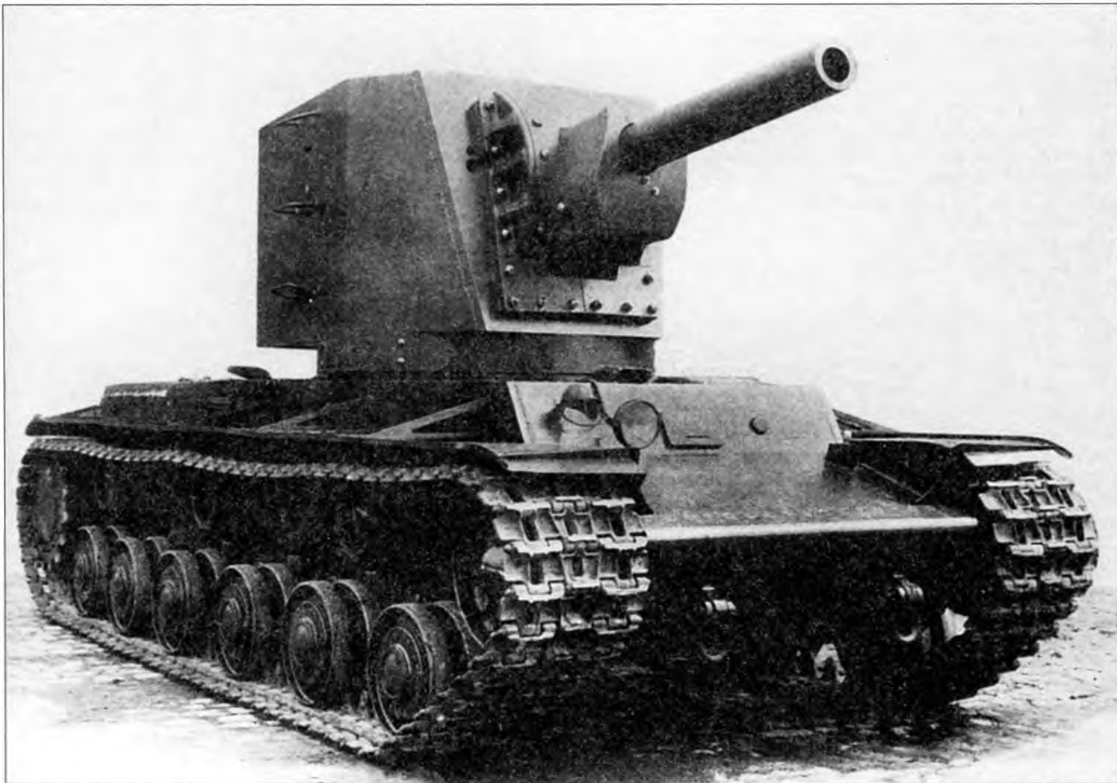
Танк КВ № У-4. Крылья «авиационного» типа демонтированы. Кировский завод, весна 1940 года
