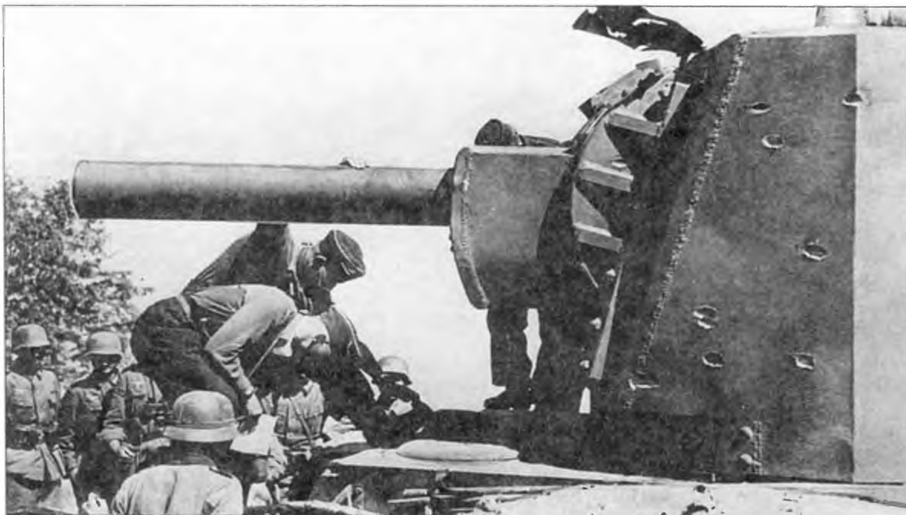
Немецкие солдаты осматривают подбитый КВ-2 из состава 2-й танковой дивизии 3-го механизированного корпуса. Литва, июнь 1941 года. Башня танка вся в «ссадинах» от попаданий 37-мм бронебойных снарядов
