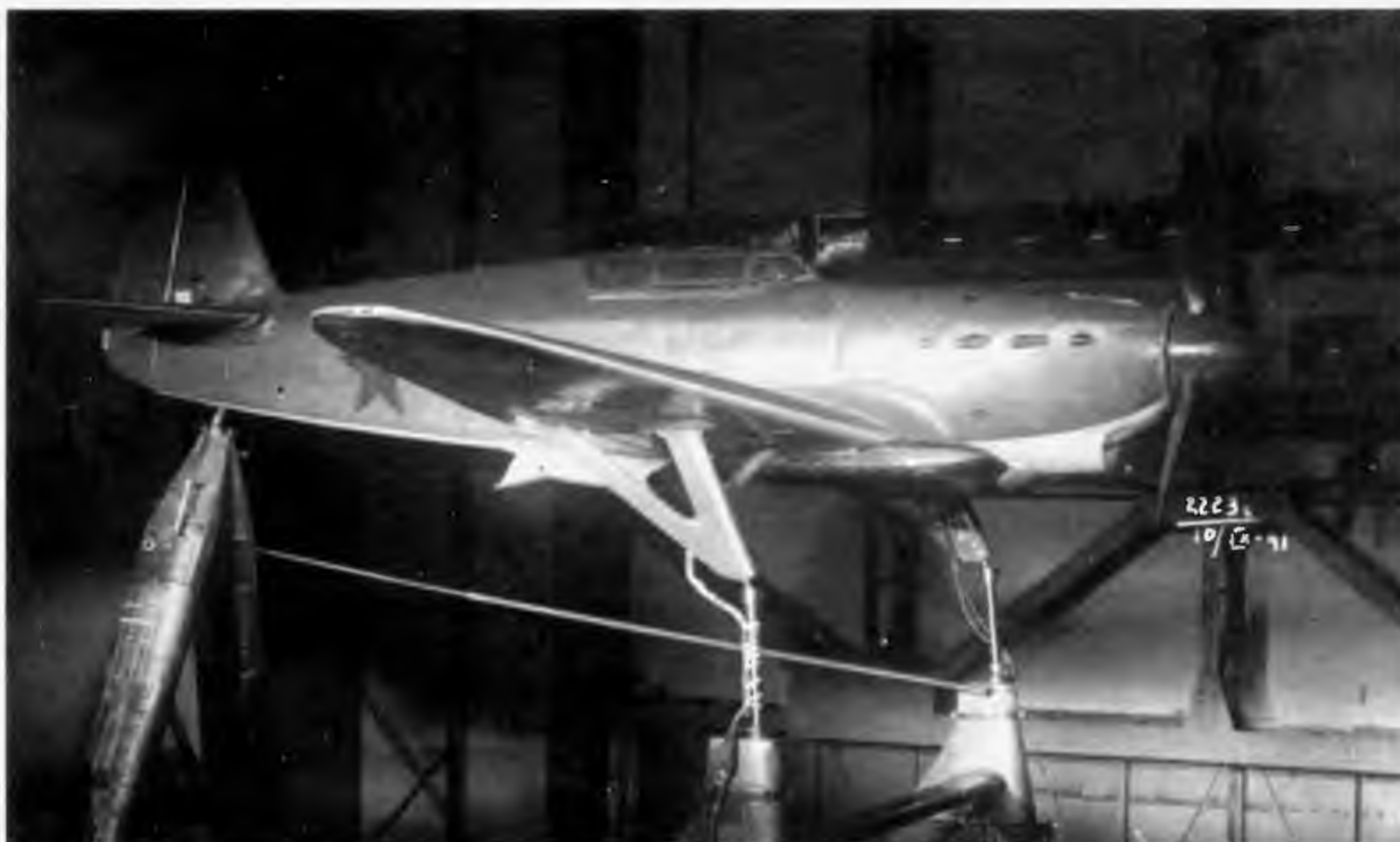
И-26-III на продувках лыжного шасси в ЦАГИ. Архив ОКБ
