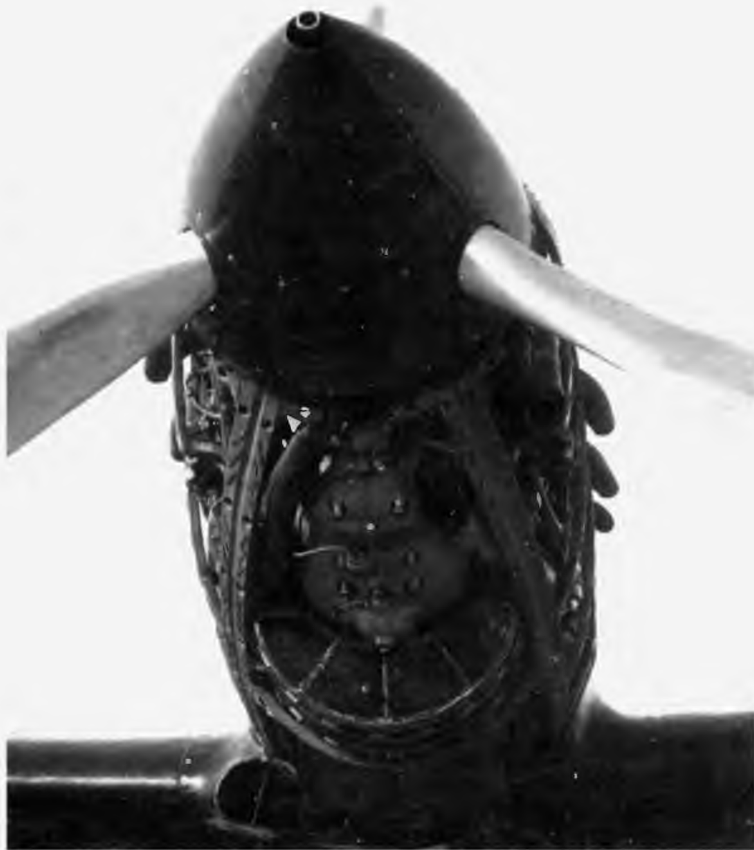
Винт ВИШ-61П № 01 на И-26-И. Архив ОКБ
