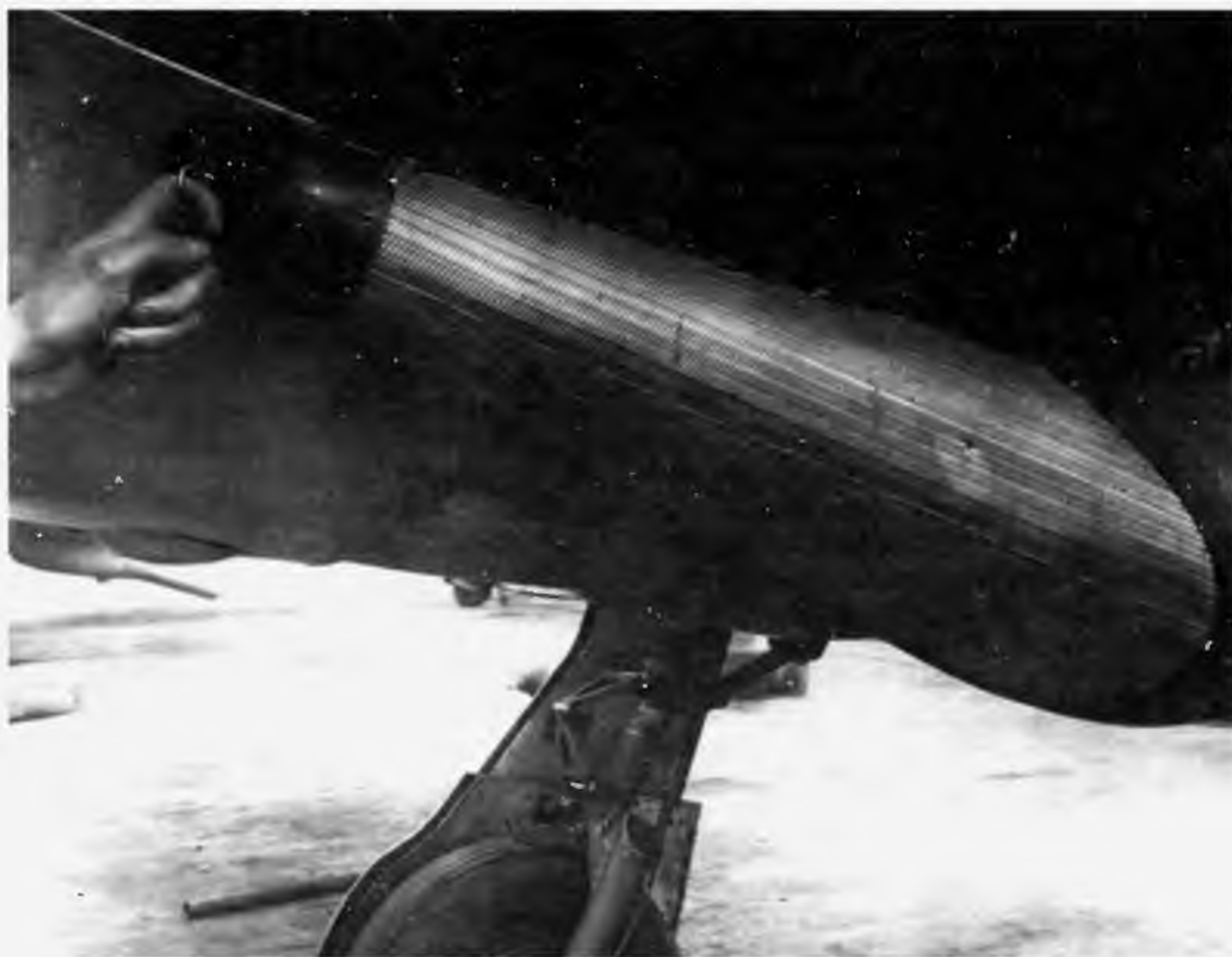
Пылефильтр конструкции ЛИИ НКАП. Архив ОКБ
