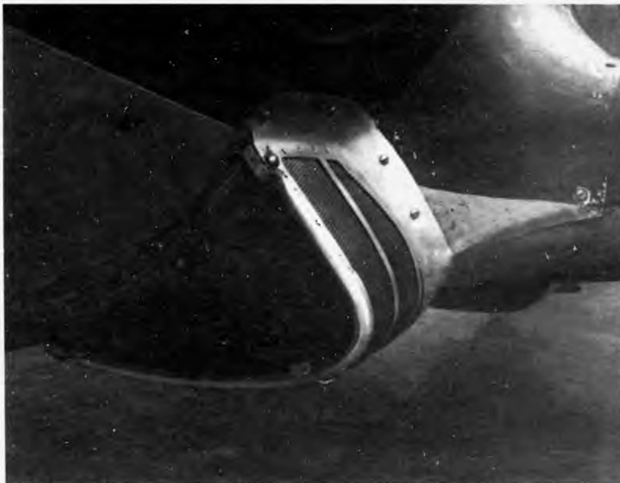
Пылефильтр, разработанный ЦАГИ. Первый вариант. Архив ОКБ
