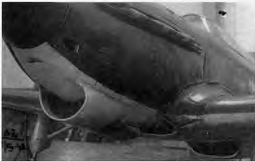
Як-1 № 0915 со стандартными формами маслорадиатора и всасывающего патрубка (в выхлопные патрубки вставлены бобышки, имитирующие выхлоп при продувках). Архив ОКБ
