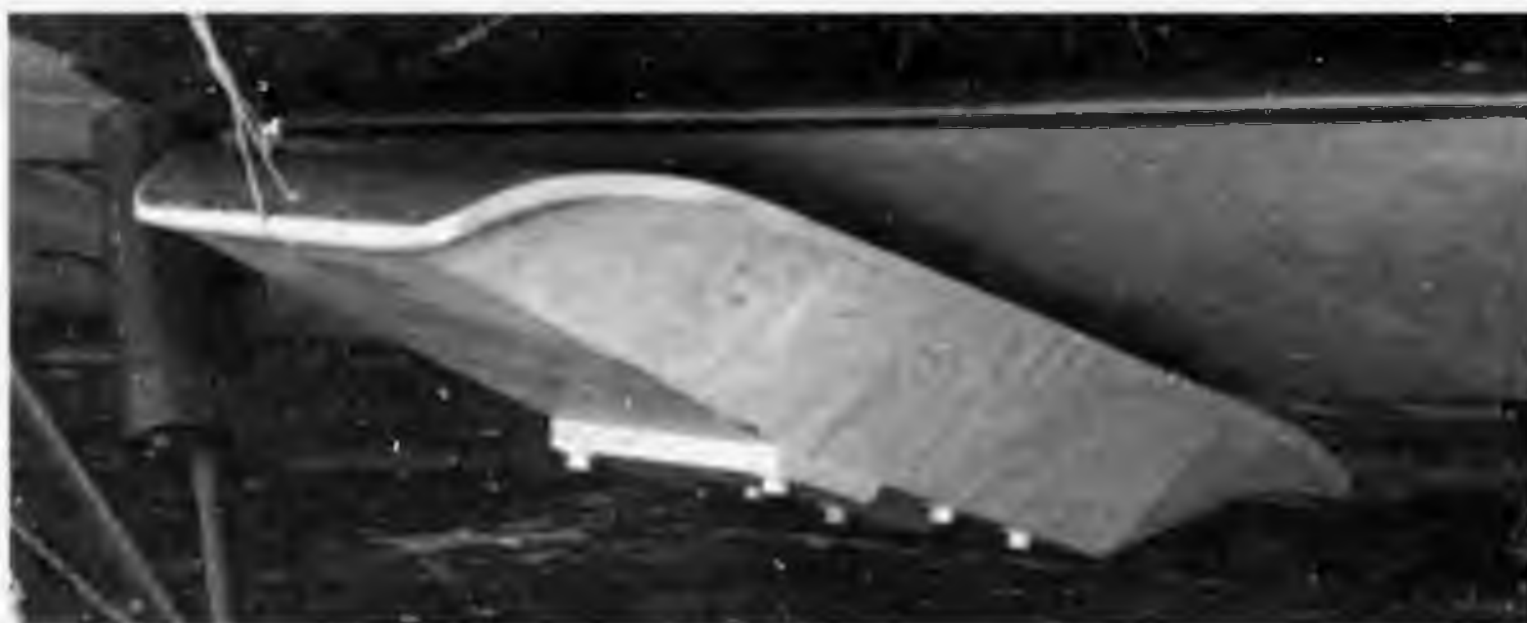
Взлетная лыжа 1-й группы, подвешенная под плоскость самолета По-2, для доставки к месту вынужденной посадки. Архив С. Кузнецова
