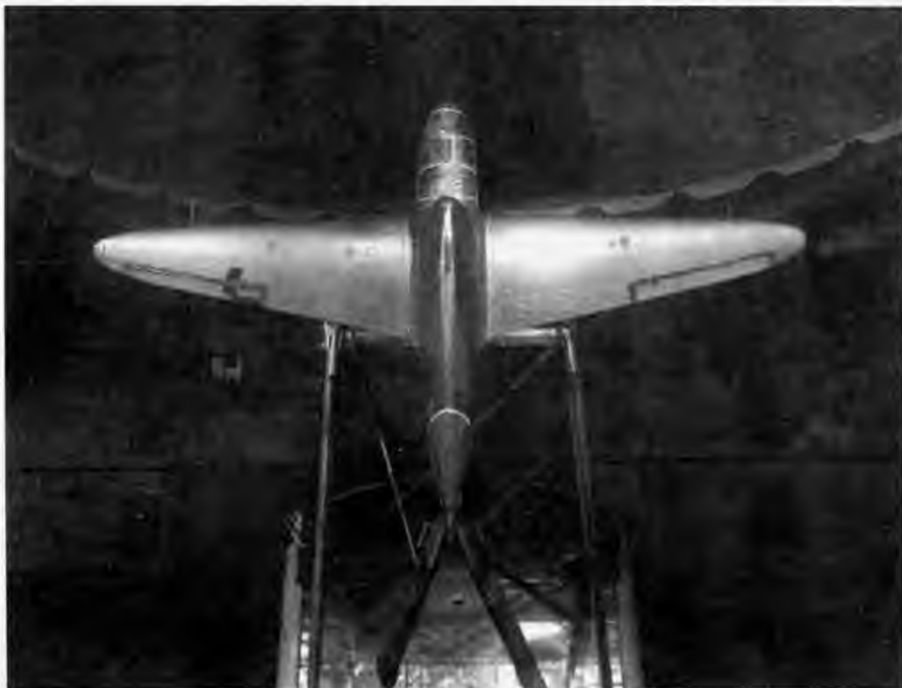
Як-1 № 0915 в большой аэродинамической трубе ЦАГИ. Архив ОКБ
