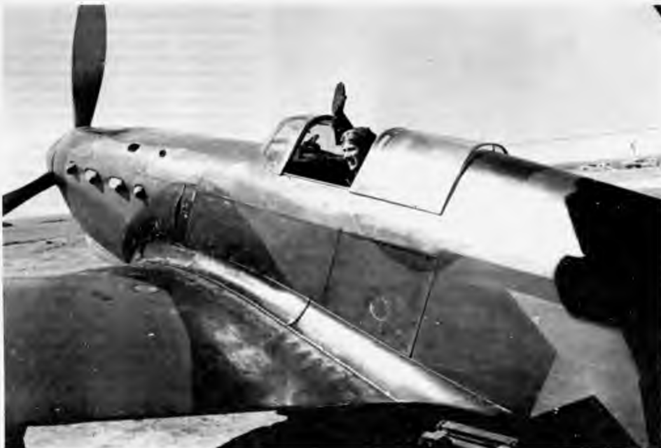
Як-1 капитана М.В. Авдеева 8-й ап ВВС ЧФ с установленным под козырьком фонаря бронестеклом. ЦВММ
