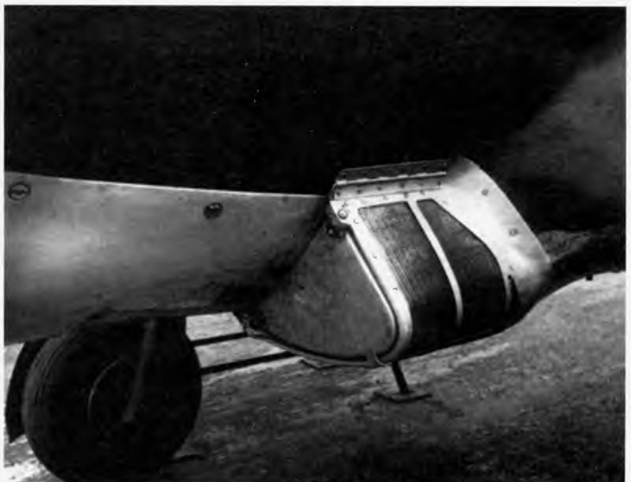
Пылефильтр, разработанный ЦАГИ. Втрый вариант Архив ОКБ
