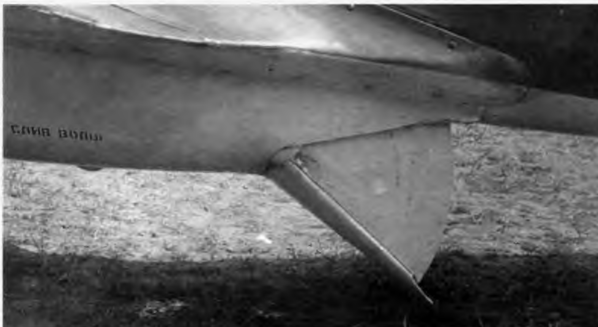
Як-1 № 0868 с внедренными мероприятиями по улучшению аэродинамики. Увеличенный угол отклонения створки водорадиатора. Герметизация желоба пулеметов. Обтекатели качалок элеронов. Архив ОКБ
