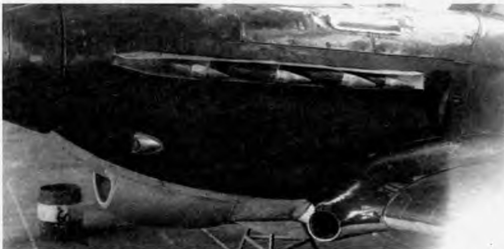
Як-1 № 0915 с улучшенными формами маслорадиатора и всасывающего патрубка, а также с обтекателем выхлопных патрубков. Архив ОКБ
