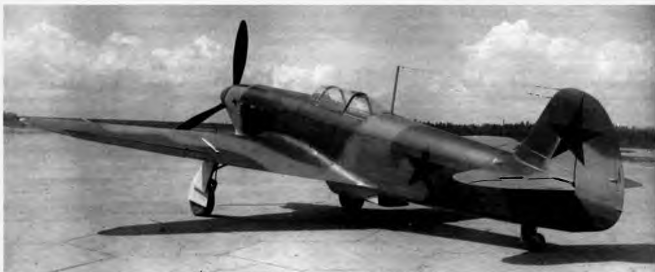
Як-1 № 3560 с обзором, улучшенным в ОКБ А.С. Яковлева. Архив ОКБ
