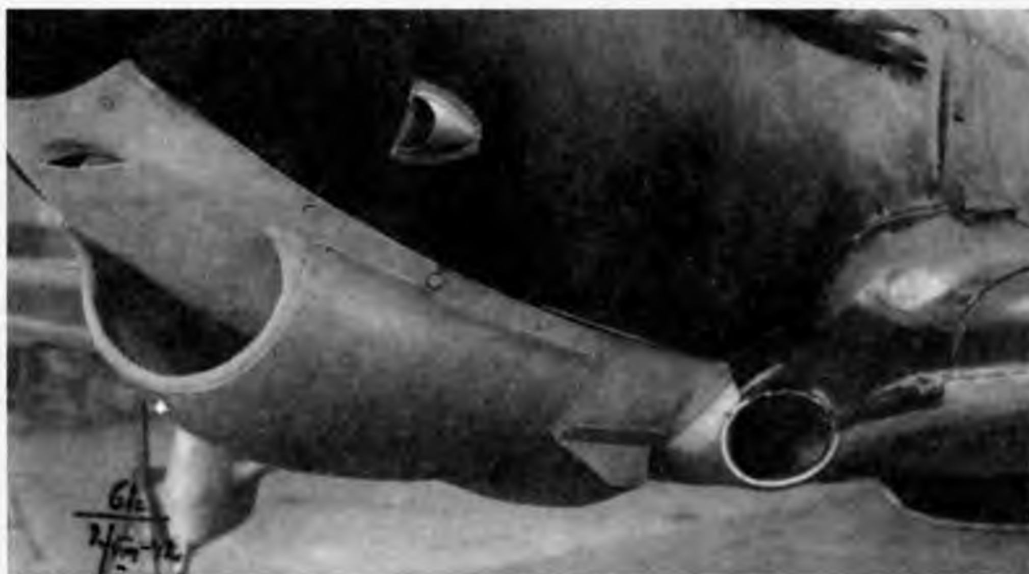
Як-1 № 0915 с улучшенными формами маслорадиатора и всасывающего патрубка, а также с обтекателем выхлопных патрубков. Архив ОКБ
