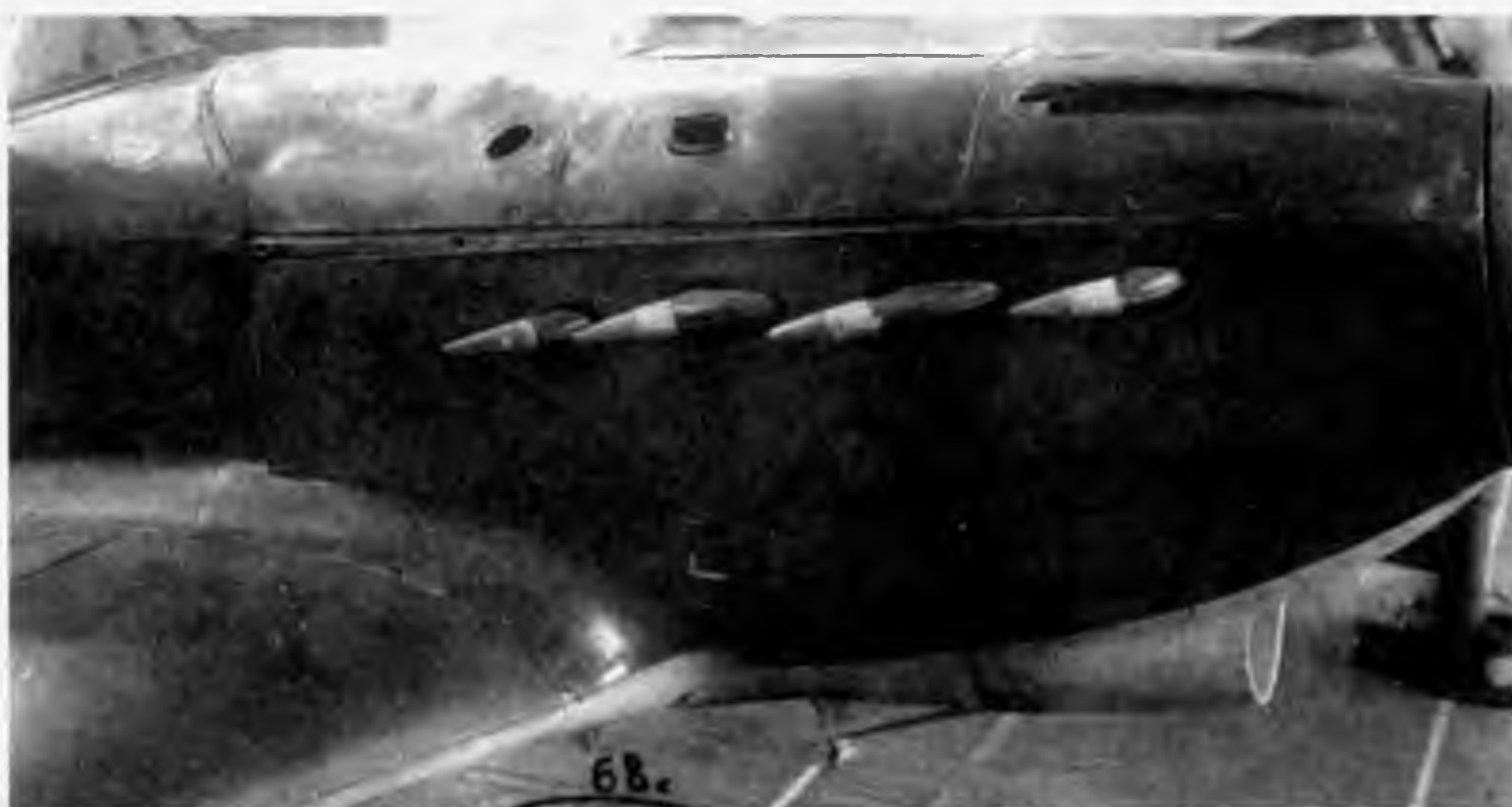
Як-1 № 0915 со стандартными формами маслорадиатора и всасывающего патрубка (в выхлопные патрубки вставлены бобышки, имитирующие выхлоп при продувках). Архив ОКБ
