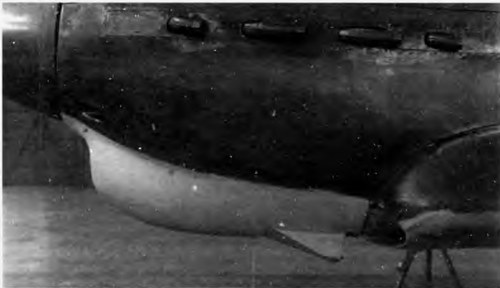
Як-1 № 0915 с улучшенным вариантом гондолы маслорадиатора на испытаниях в ЦАГИ. Архив ОКБ
