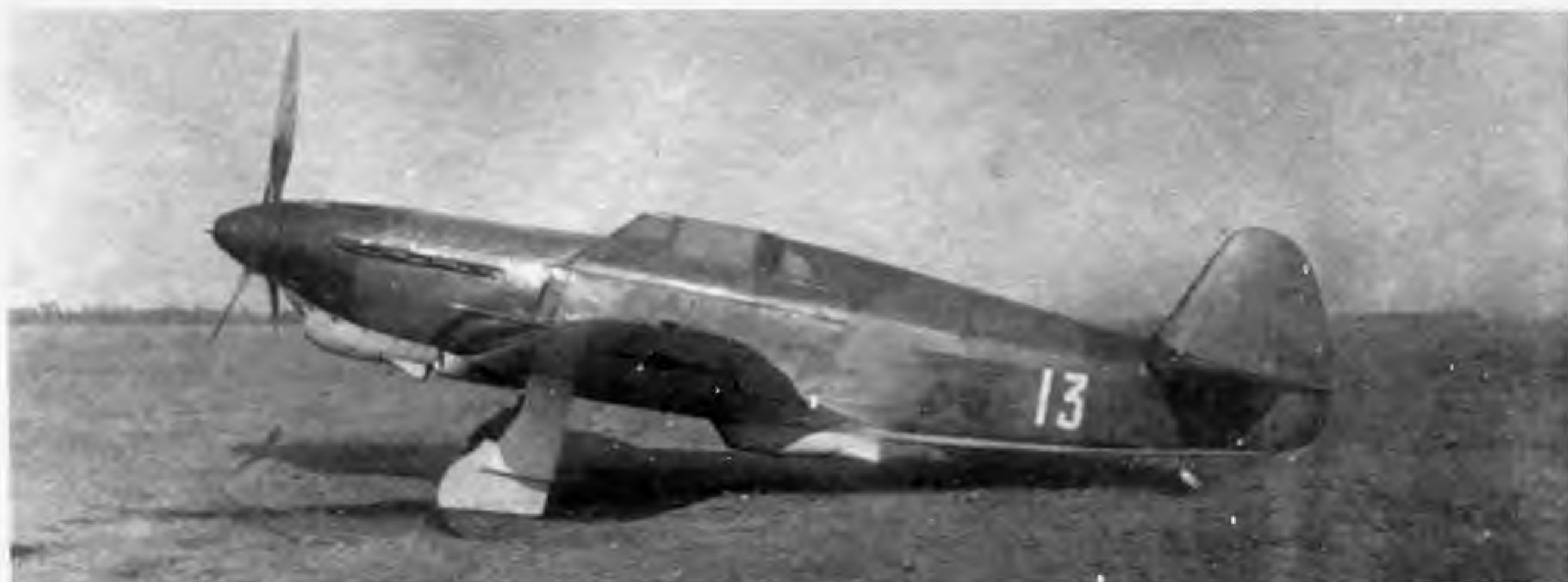
Як-1 № 0868 с внедренными мероприятиями по улучшению аэродинамики. Архив ОКБ
