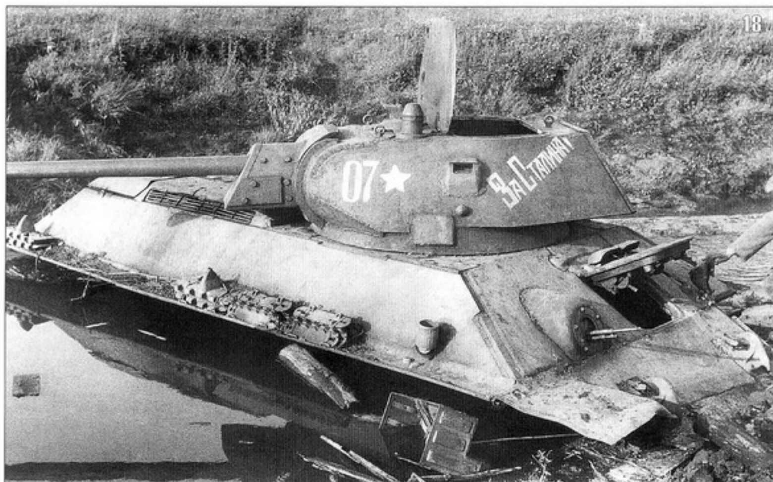
18. Застывший и оставленный экипажем Т-34 производства СТЗ. Июль 1942 года. Машина имеет сварную башню, гладкий борт корпуса (без крючьев), хорошо видна укладка шпор и запасных траков, а также дополнительное бронирование лобового листа корпуса.
