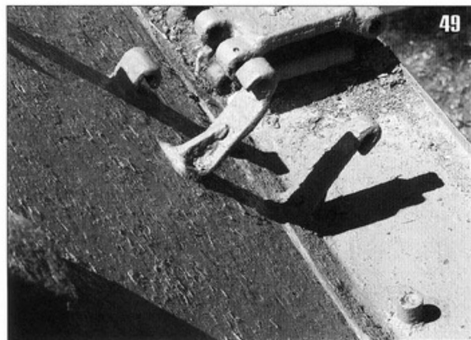
47. Стоп-сигнал на корме корпуса. Справа в центре видны электрические контакты (Медынь).
