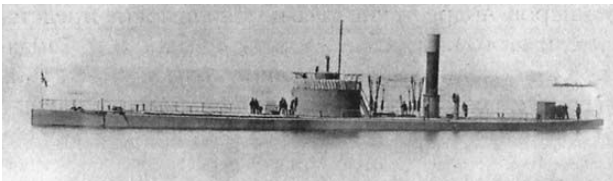
Броненосец береговой обороны «Вещун». На башне видна установленная защита из матросских коек (стр. 55)
