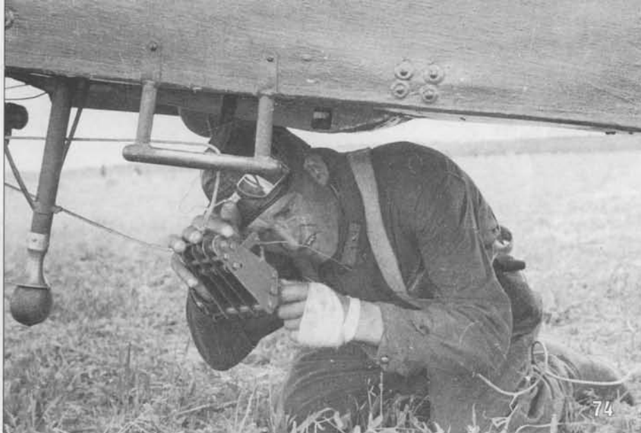
74. Летчик проверяет буксировочный замок перед стартом буксировщика планеров Р-5. Прекрасно видна подножка и стойка выпускной радиоантенны. Яйцевидный предмет — это грузик, под весом которого разматывался 50-метровый трос антенны. The pilot checks the tow hookup before beginning to tow a glider with an R-5.
