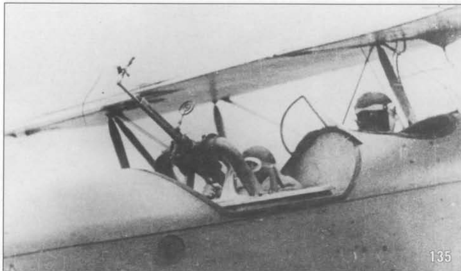
135. Турель ТУР-8 с пулеметом ШКАС. The TUR-8 ring mount with a ShKAS machine gun fitted.
