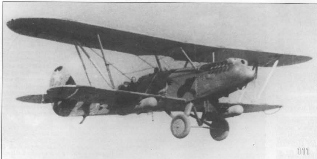
111-114. Р-5 в летнем камуфляже использовался для транспортных перевозок. Под крыльями машины видны подвешенные транспортные контейнеры. R-5 aircraft in winter camouflage being used for transport work. The enclosed transport containers can be seen on top of the wings.
