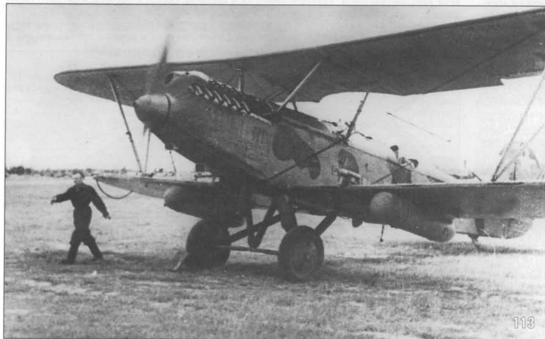
111-114. Р-5 в летнем камуфляже использовался для транспортных перевозок. Под крыльями машины видны подвешенные транспортные контейнеры. R-5 aircraft in winter camouflage being used for transport work. The enclosed transport containers can be seen on top of the wings.
