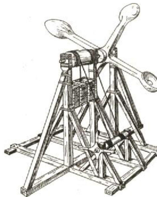
Рис. 105. Реконструкция одной из метательных машин Вальтера де Милимета (1326/27 г.).
