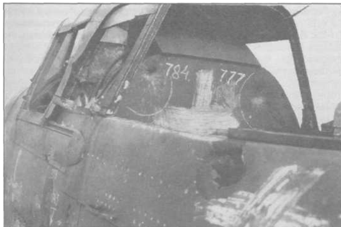
Разрушения Ил-2 в результате попадания двух 20-мм снарядов (одно с проломом брони)
