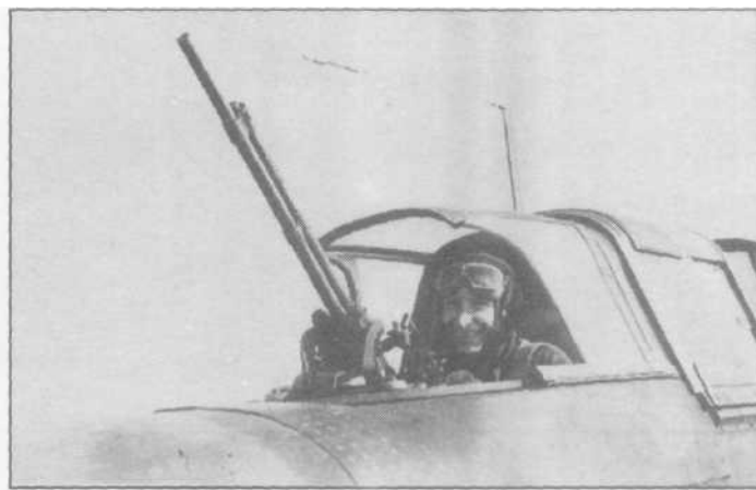
Установка пулемета УБТ на серийном Ил-2. Вырезы в боковиках крыши фонаря кабины сделаны техническим составом для улучшения углов обстрела (воздушный стрелок ст. сержант Е. Матвиенко, 1943 г.)
