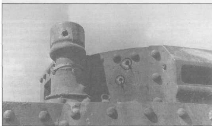
Пробоины в броне башни немецкого легкого танка Pz Kpfw 38(t) Ausf S от снарядов БЗ-23 пушки ВЯ (броня 15 мм)
