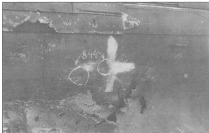
Разрушения в борту кабины летчика самолета Ил-2 в результате двух попаданий фугасных снарядов калибра 20-мм
