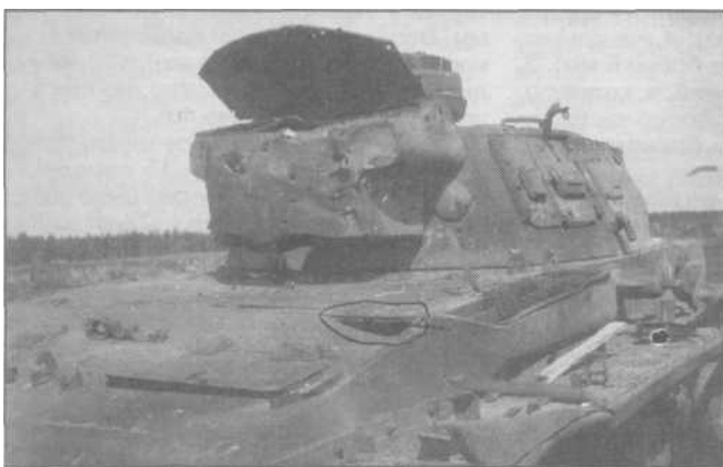
Прямое попадание РС-82 в надмоторную часть среднего немецкого танка Pz Kpfw III Ausf. J
