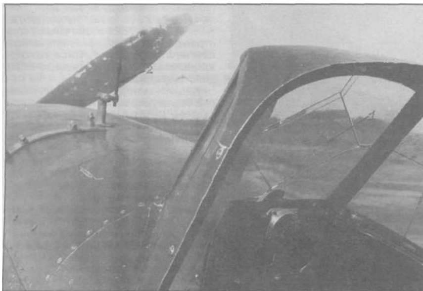
Размещение прицела ВВ-1 на самолете Ил-2: 1 - сетка прицела, 2 - мушка прицела
