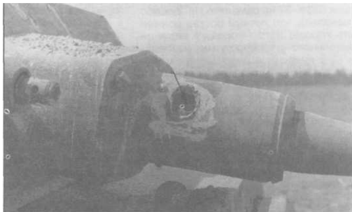
Попадание бронебойно-трассирующего снаряда калибра 37-мм БТ-37 в пушку немецкого среднего танка Pz. III Aust J
