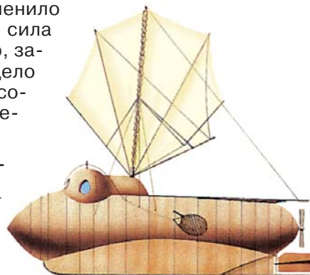
Подводная лодка Р. Фултона. Мачта, укрепленная на шарнире, быстро демонтировалась и укладывалась в специальный желоб.
