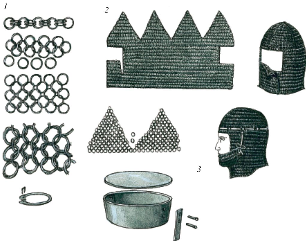
Изготовление простейшего защитного вооружения: 1 — способы плетения кольчуги из гроверных колец; 2 — последовательность плетения кольчужного капюшона; 3 — последовательность изготовления простейшего котелкового шлема из полистирольных пластин
