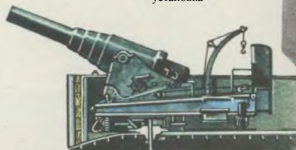
Барбетная казнозарядная установка
