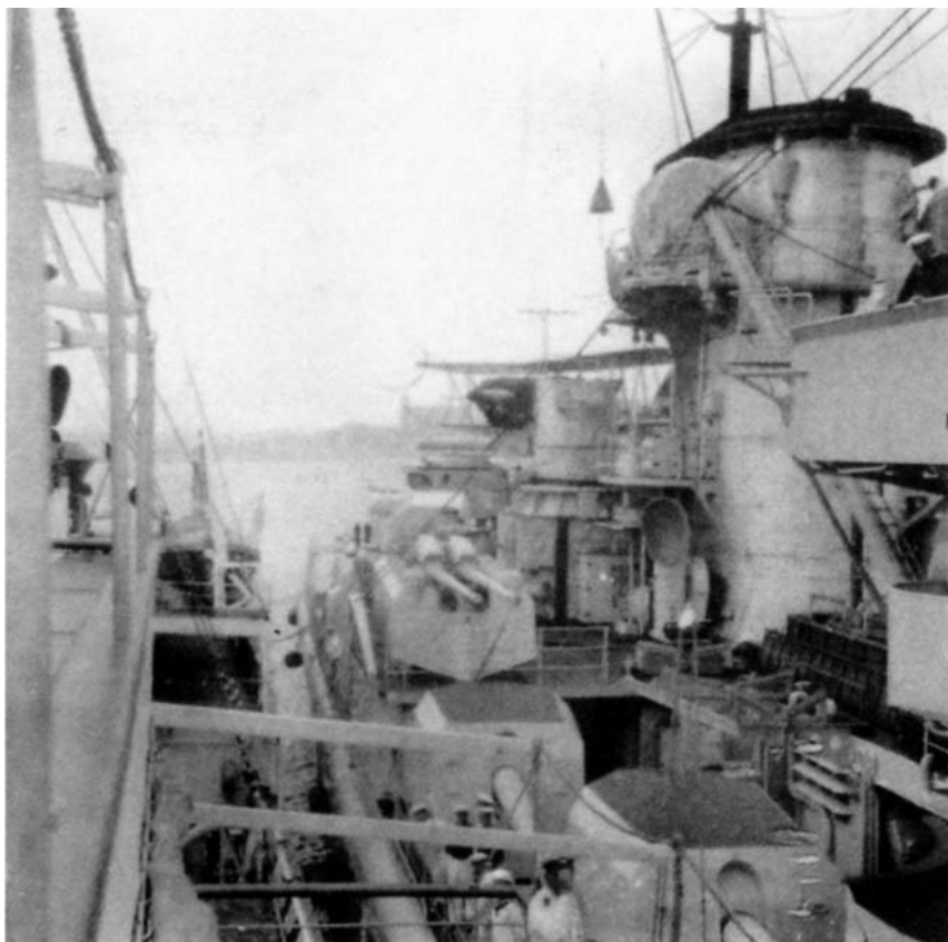
Вид броненосца «Адмирал Шпеер». Видны башни вспомогательного вооружения и тяжелые зенитные орудия. Обратите внимание на зачехленные поисковые прожекторы на трубах. Прямо под ними дальномеры системы управления зенитным огнем.
