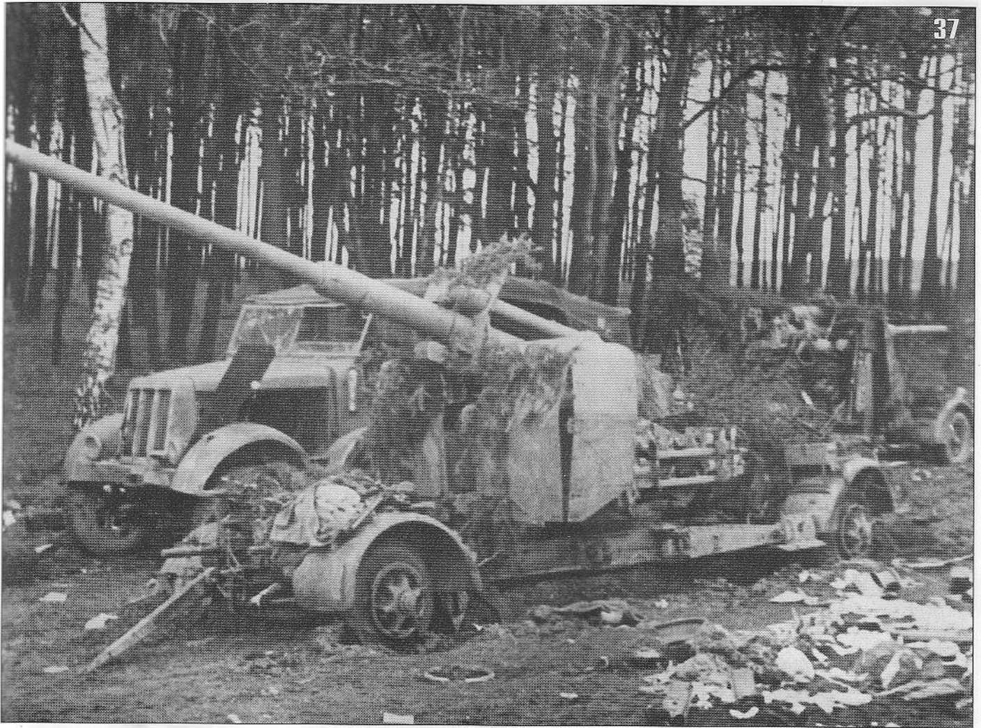
36. Полугусеничный тягач Sd.Kfz. 7 с 88-мм зенитной пушкой Flak 36, брошенный немцами при разгроме коттбусовской группировки юго-восточнее Берлина. Снято 27 апреля 1945 года (АСКМ).
