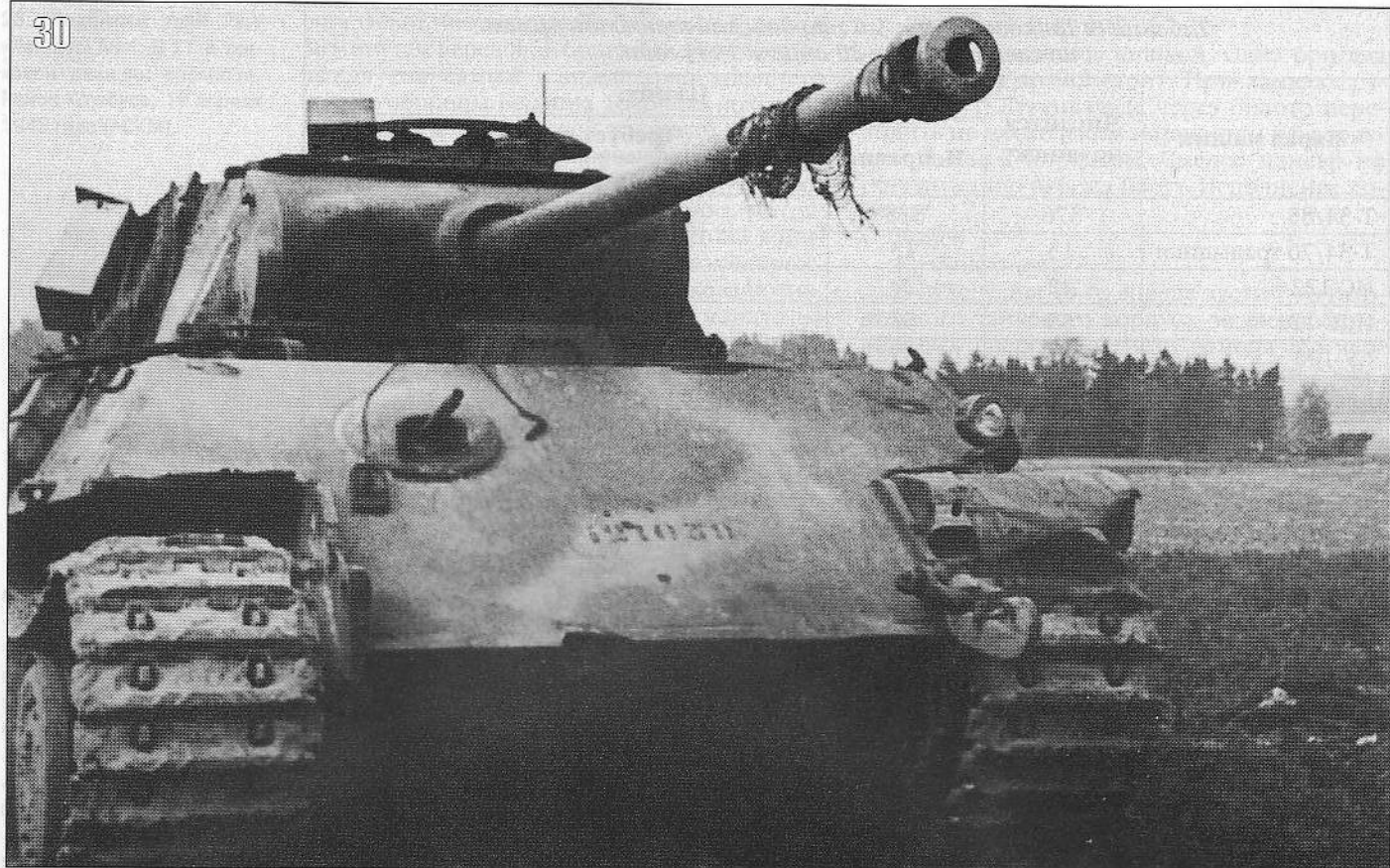
30, 31. Танк Pz.V «Panther» Ausf. G из состава 21-й танковой дивизии вермахта, подбитый в районе Коттбуса 19 апреля 1945 года. Машина имеет катки с внутренней амортизацией, на лобовом листе виден заводской номер танка 127039, на корме лежит сгоревший член экипажа (АСКМ).
