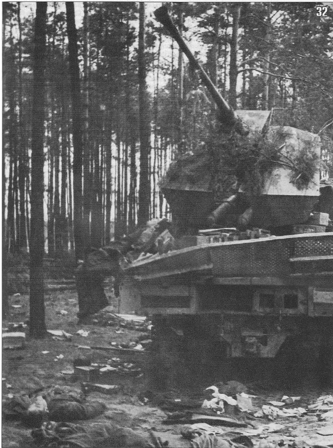
32. Зенитная самоходка Sd.Kfz. 7/2 (8-тонный полугусеничный тягач Sd.Kfz. 7 с установленной в кузове 37-мм зенитным орудием Flak 36), захваченная частями 3-й гвардейской танковой армии в районе Коттбуса. 19 апреля 1945 года (АСКМ).
