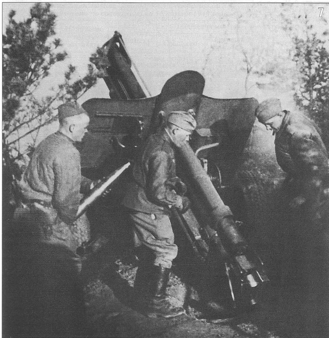
7. Огонь ведет 76-мм пушка Ф-22 УСВ батареи старшего лейтенанта Кондратюка. 16 апреля 1945 года. Ствол орудия в откате (АСКМ).
