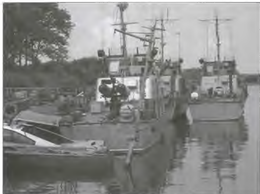
Абхазские «линкары». На корме — два вертолетных блока управляемых ракет С-5
