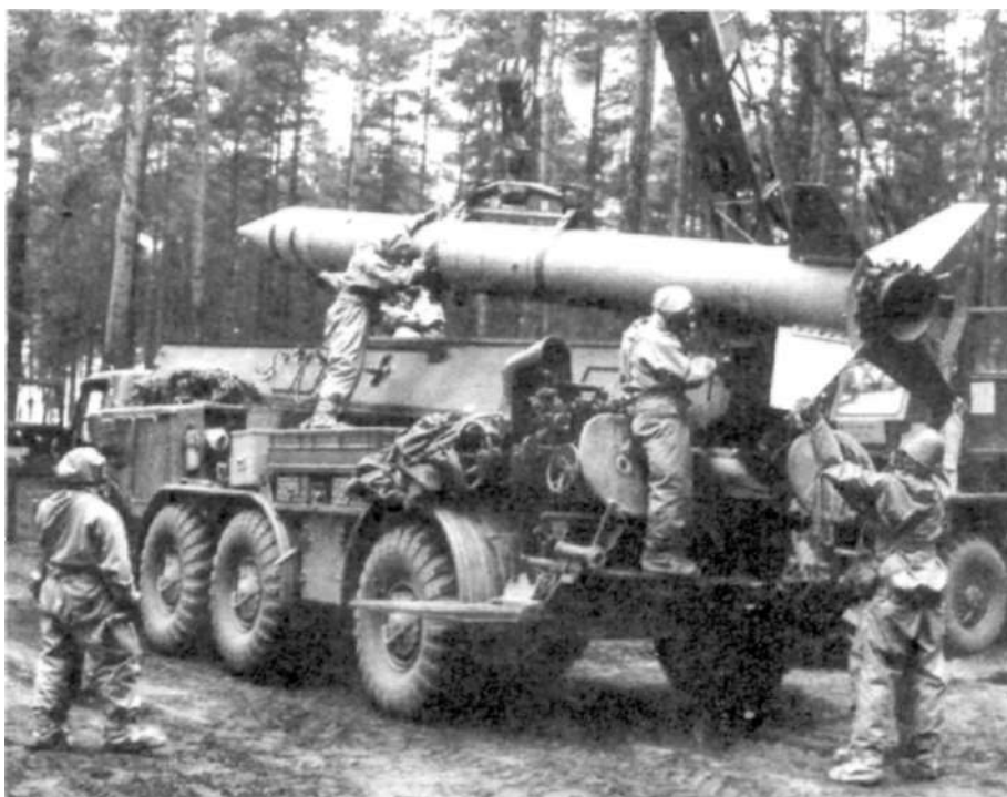
Погрузка ракеты «Луна-М» на пусковую установку 9П113
