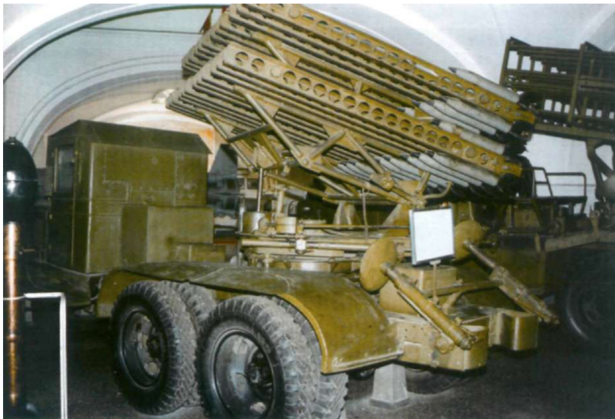
Боевая машина БМ-8-48 на шасси автомобиля ЗИС-6
