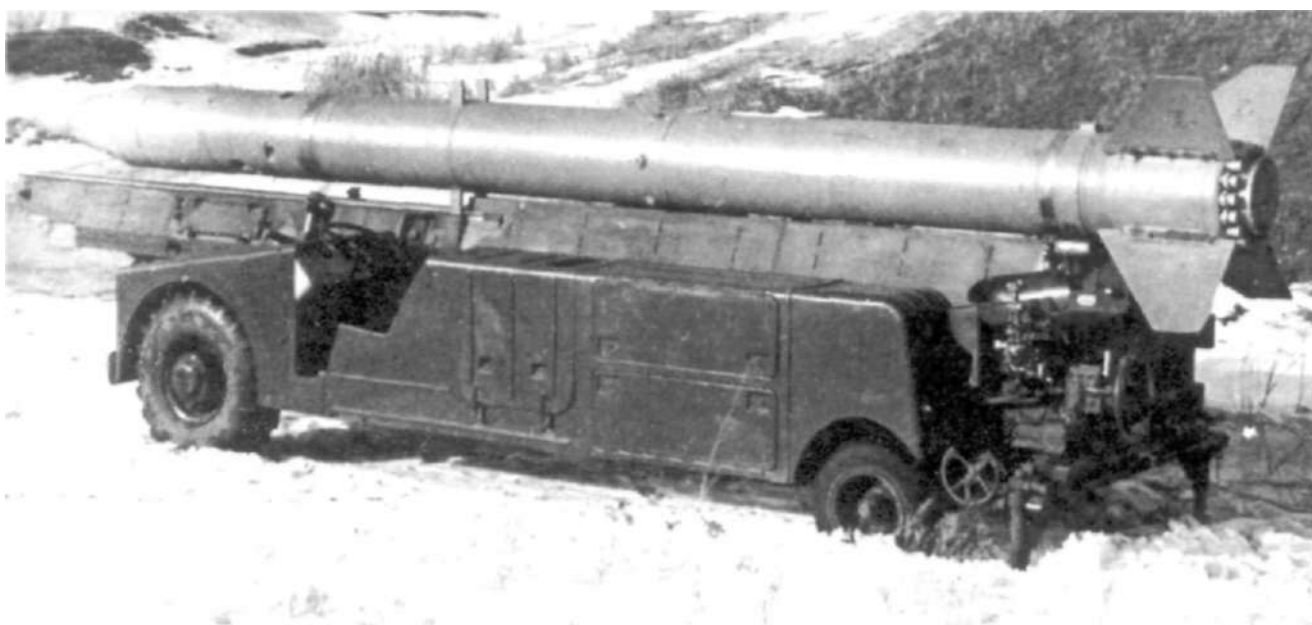
Вертолетная пусковая установка 9П114 (Бр-257) комплекса «Луна-М»
