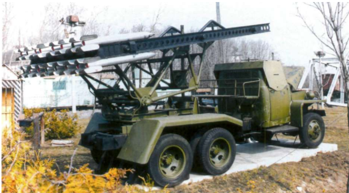
Боевая машина БМ-13 на шасси автомобиля «Студебеккер»
