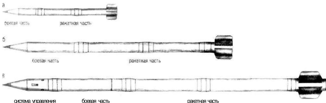
Реактивные снаряды для: а — 122-мм РСЗО «Град»; б — 220-мм РСЗО «Ураган»; в — 300-мм РСЗО «Смерч»
