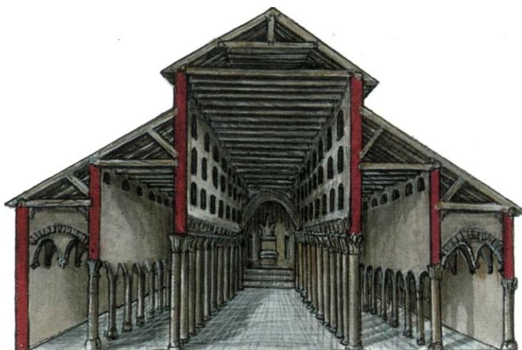
Древнехристианская базилика, стоявшая на месте римского собора Святого Петра в Риме (современная реконструкция). Широкие нефы — залы — зодчие смогли перекрыть только деревянными балками.
