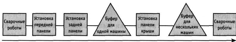
Рис. 3-5. Поток работ между сварочными роботами
