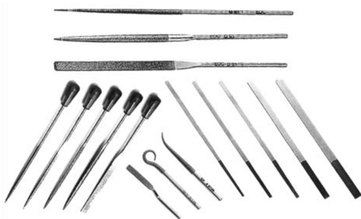
Рис. 6.3. Надфили из гальванически осажденного алмаза.
