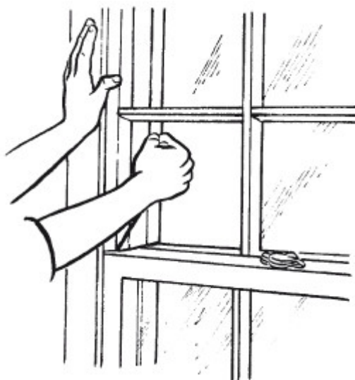
Рис. 40. Очистка направляющего паза
