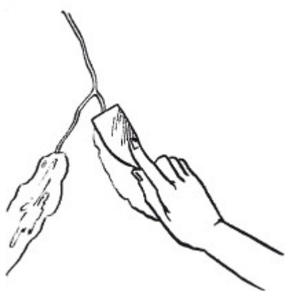
Рис. 8. Обработка стены грунтовкой
