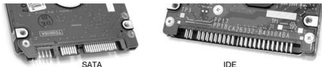
Рис. 12.2. Разъемы винчестеров
