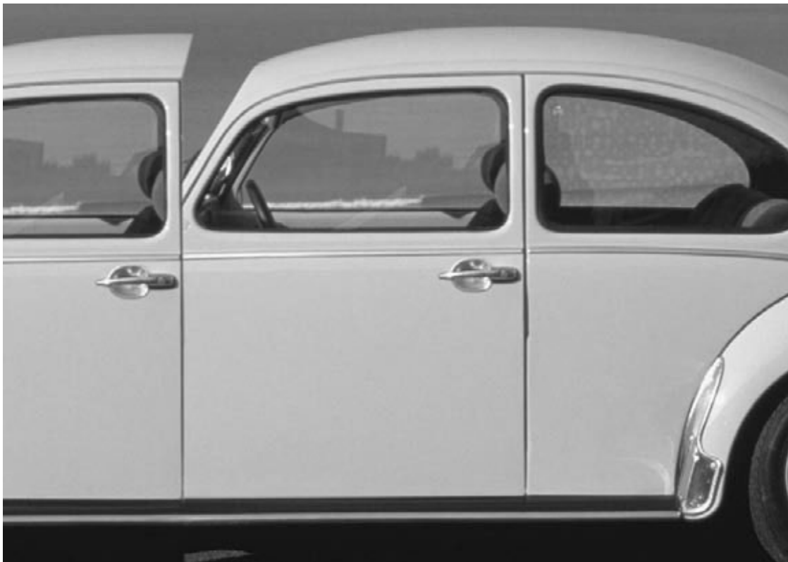
Рис. 34.10. Подровняли низ средней двери с помощью штампа
