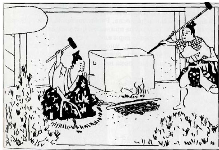
Кузнец за работой. Мастер сидит на соломенном коврике, удерживает заготовку клещами и легким молотком бьет по ней, задавая темп и указывая место удара молотобойцу, который работает стоя.
