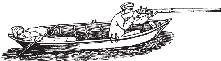
Рис. 118. Охотники на дикую птицу в каное из Пула. Она представляла собой плоскодонку, погружавшуюся в воду всего лишь на 2 дюйма и остроконечную с обеих сторон. Весила примерно 100 фунтов и оказывалась идеальным подспорьем для охоты в протоках и болотах. Из книги «Наставления начинающему охотнику» (1844)
