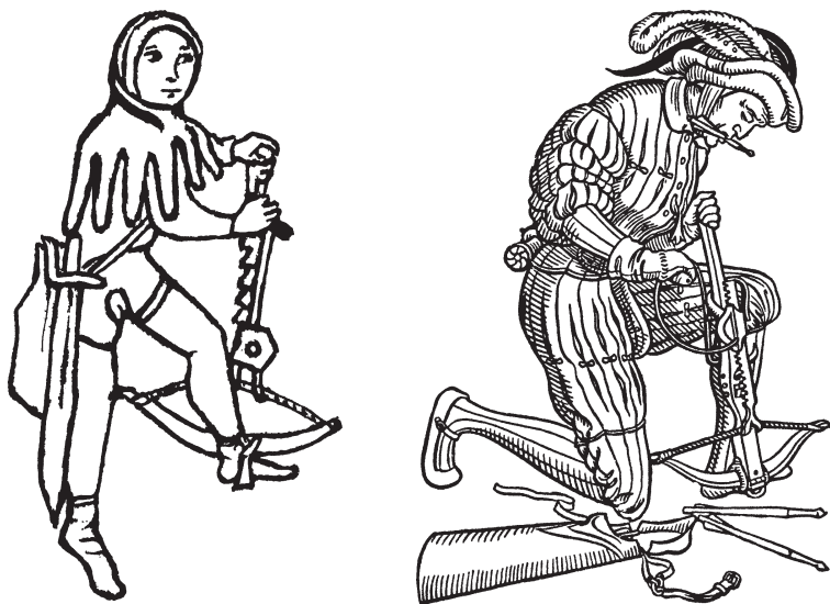
Рис. 78. Натяжители тетивы. Слева: с зубчатой рейкой, XV в. Справа: с изогнутой рукояткой, по рисунку Ганса Гольбейна-старшего, ок. 1516 г. Старая пинакотекa, Мюнхен
