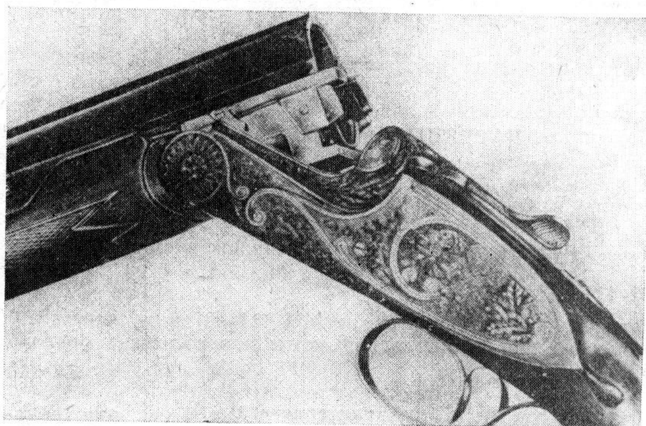
Рис. 37. Ружье модели МЦ 109—01 с открытым затвором
