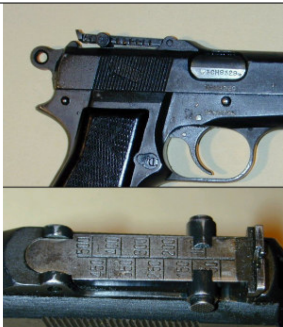
Регулируемый целик на пистолете Browning High Power периода Второй мировой войны. Шкала прицела имеет весьма оптимистическую разметку на дальность от 50 до 500 метров.
