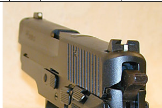
Открытый нерегулируемый прицел с контрастными вставками и сменным целиком, установленным в паз типа «ласточкин хвост» (пистолет SIG-Sauer P225)
