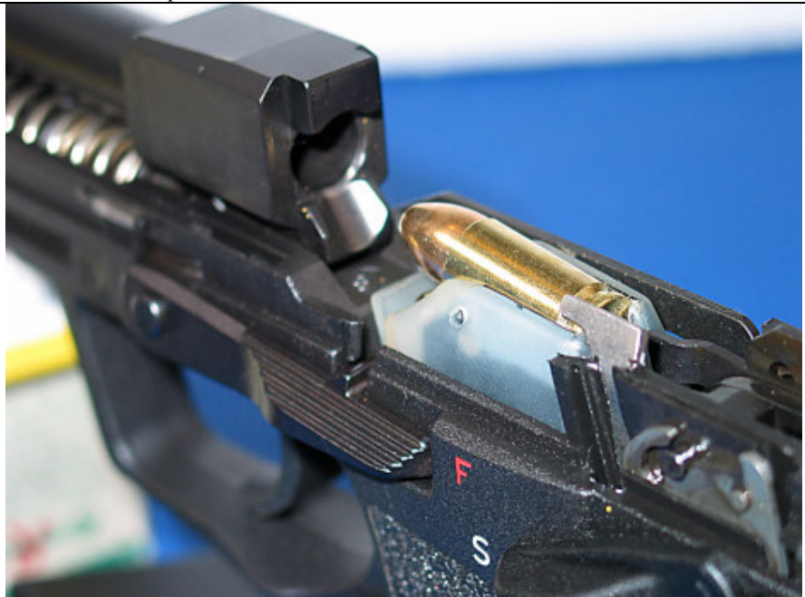
Механизм подачи патронов пистолета Heckler-Koch P8 / USP. На фото хорошо видно, как организован выход патронов из двухрядного магазина в один ряд, подающая рампа ствола, фиксированный отражатель (позади магазина)
