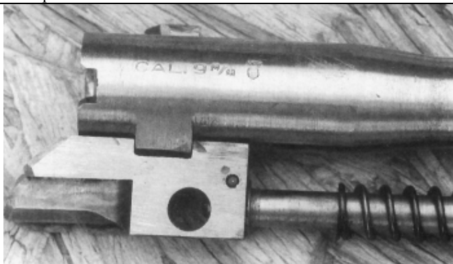
Вид сбоку на казенную часть ствола и основание возвратной пружины пистолета MAB P15. Хорошо видны два упора на казенной части ствола: нижний, обеспечивающий вращение ствола без его продольного смещения, и верхний, взаимодействующий с фигурным пазом в затворе
