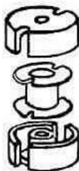
Рис. 2. Составные части конструкции броневой катушки.
