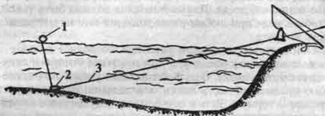
Рис. 58. Донка с резиновым амортизатором: 1 — буюк; 2 — груз; 3 — резина.
