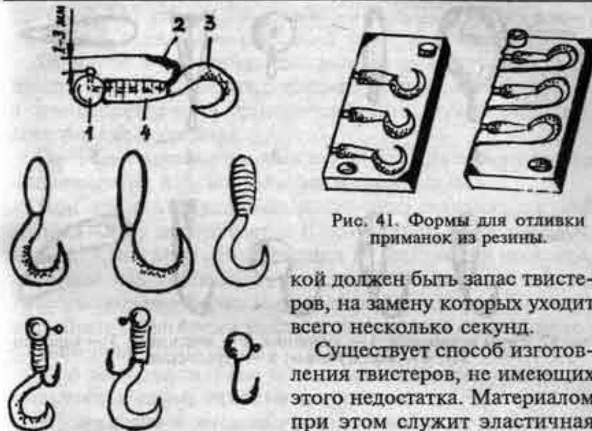
Рис. 40. Самодельные приманки из резины: 1 — дробинка, 2 — крючок, 3 — резиновый контур, 4 — нить.
