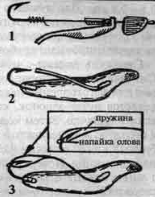
Рис. 23. Самодельные незацепляющиеся блесны: 1 — блесна с одинарным крючком; 2, 3 — блесна с пружиной.
