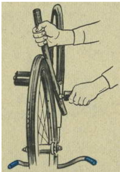
Рис. 9. Выправление шатуна
