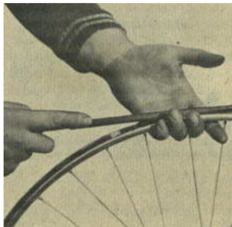
Рис. 7. Спиливание выступающих концов спиц
