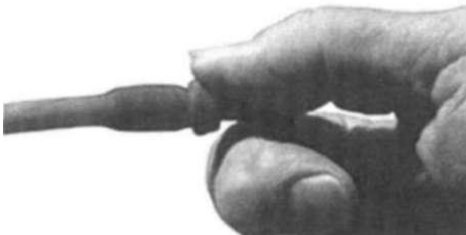
Рисунок 2-6. Снимите старые тяжи, скатав их пальцем с рогов.
