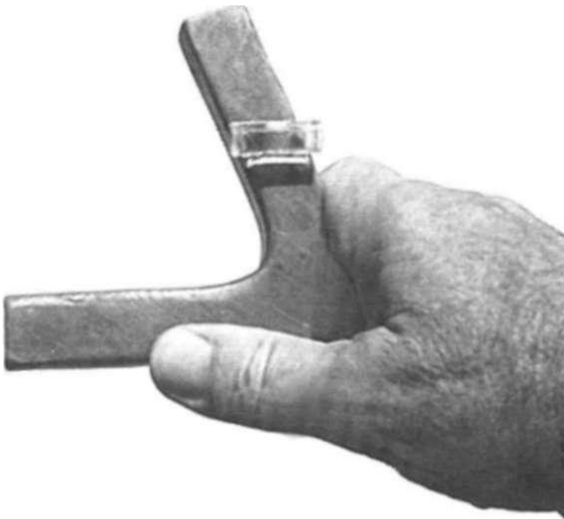
Рисунок 7-6. Когда плотницкий уровень установлен горизонтально, рогатка находится в правильном положении.
