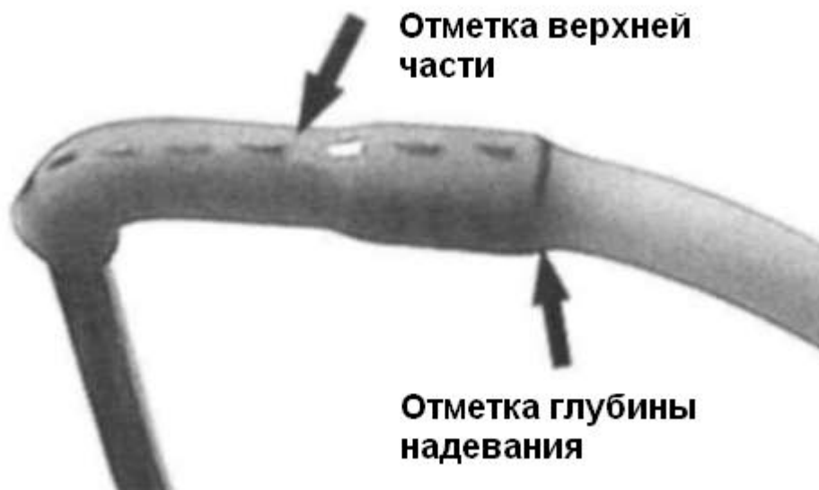
Рисунок 2-9. Убедитесь что после установки все отметки встали на свои места.
