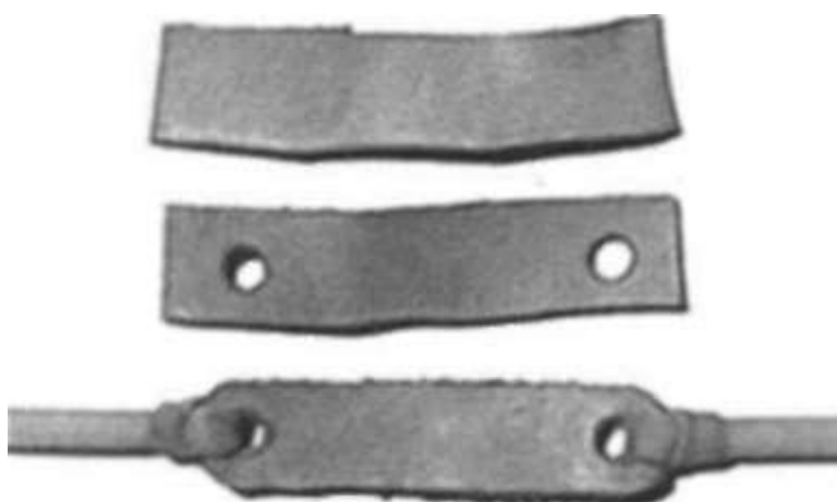
Рисунок 4-3. Три стадии изготовления кожетка.
