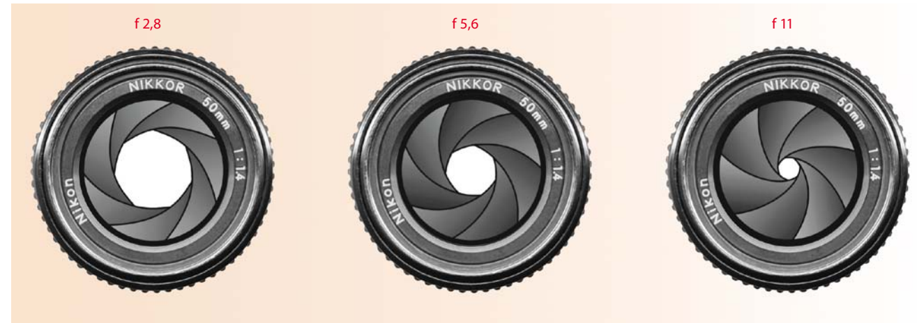
При разных значениях диафрагмы меняется отверстие для пропускания света
