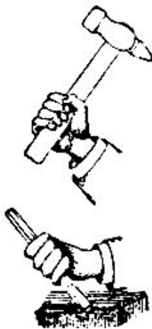
Рис. 83. Работа с зубилом
