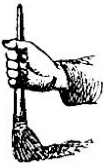
Рис. 66. Как держать кисть при клейке картона
