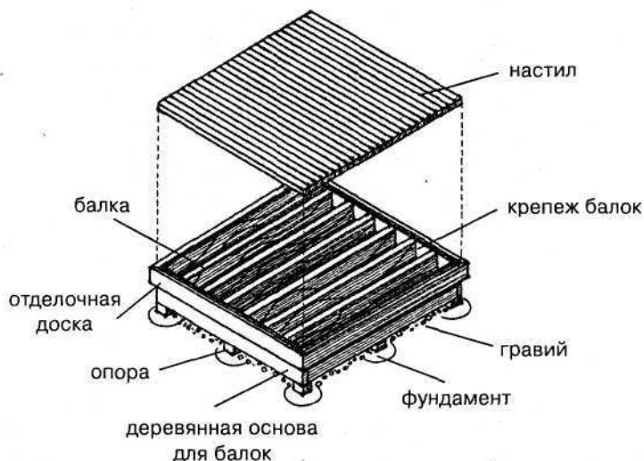
Рис. 24. Устройство низкой террасы
