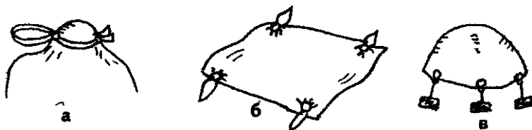
Рис. 33. Схема крепления пленочного материала: а — устройство петли; б — готовое покрывало; в — закрепление петли на стоге грузиками
