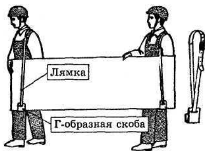
Рис. 3. Переноска листов гипсокартона на лямках
