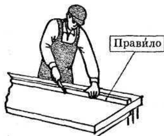
Рис. 5. Прорезка листа гипсокартона
