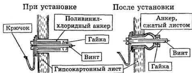
Рис. 21. Крючки для крепления в гипсокартонных перегородках
