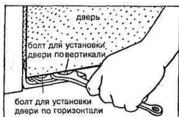
Рис. 17. Регулировка положения двери
