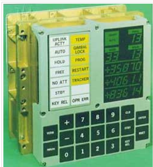
Панель управления и индикации компьютера, установленного на лунном модуле.
