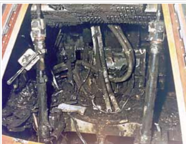
Фото NASA S-67-21294. Командный модуль «Аполлона-1» после пожара.
