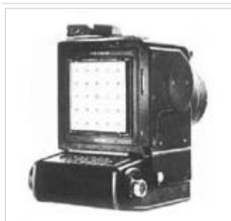
Камера «Hasselblad», в которой установлена стеклянная пластинка с нарисованными крестиками (вид со снятой кассетой для пленки)».
