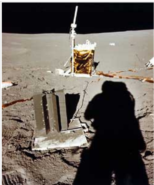
Фото NASA AS14-67-9366. Центральная часть комплекта научных приборов ALSEP: радиоизотопный электрогенератор и центральный блок.
