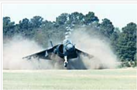
Самолет «Харриер», висящий над полем. Сила тяги его двигателя, которая держит аппарат в воздухе, в несколько раз больше силы тяги посадочного модуля «Аполлона».
