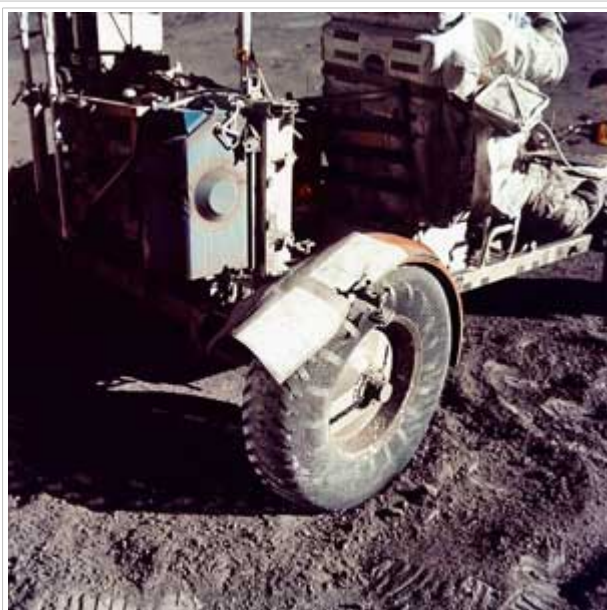
Фото NASA AS17-137-20979. Ремонт «луномобиля» в полевых условиях. На сиденье — астронавт Харрисон Шмитт.
