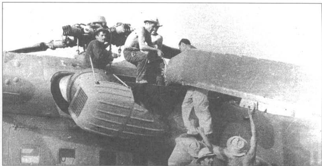
Замена лопасти винта силами техсостава. Кундуз, весна 1984 г.
