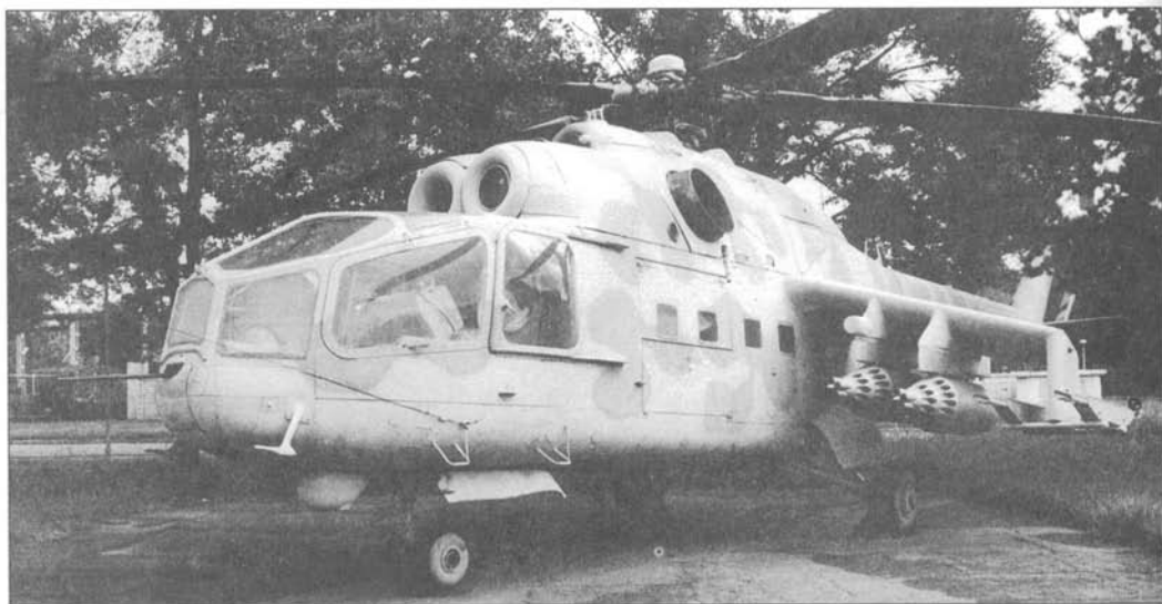
Ми-24А из 344-го ЦБЛ и ПЛС. На внутреннем пилоне хорошо видна установка фотопулемета
