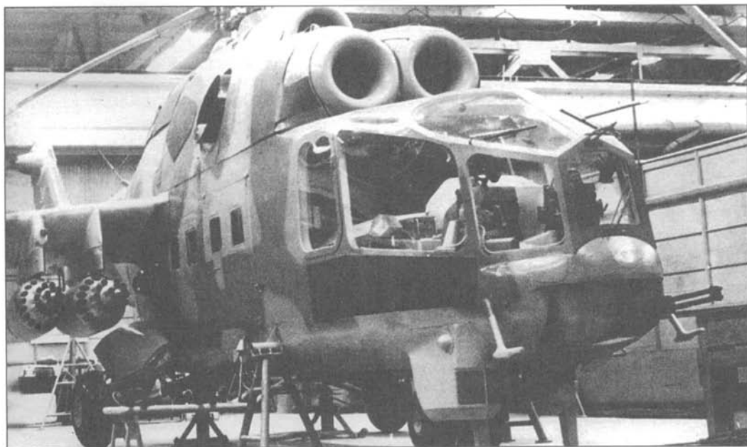
Макет вертолета Ми-24Б с подвижной турельной дистанционной стрелковой установкой УСПУ-24 с пулеметом ЯкБ-12,7
