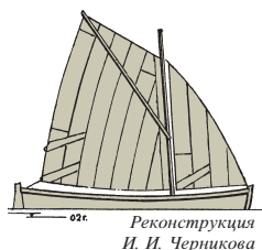
Ял двухвесельный «Ерш». Царское Село, 1859 г. Длина 4,21 м; ширина 1,4 м; осадка 0,33 м
