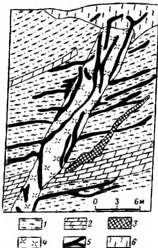
Рис. 41. Обобщенный разрез графитовых месторождений Шри-Ланки (по Д. Н. Вадиа):
