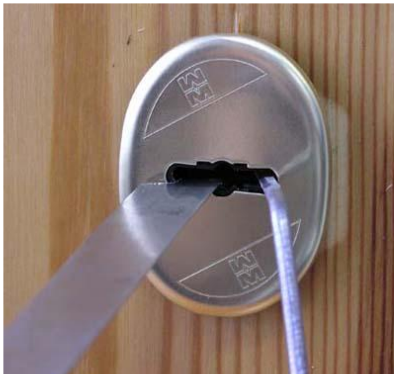
Фото 8. На фотографии вы видите процесс снятия слепка с замка Mottura.
