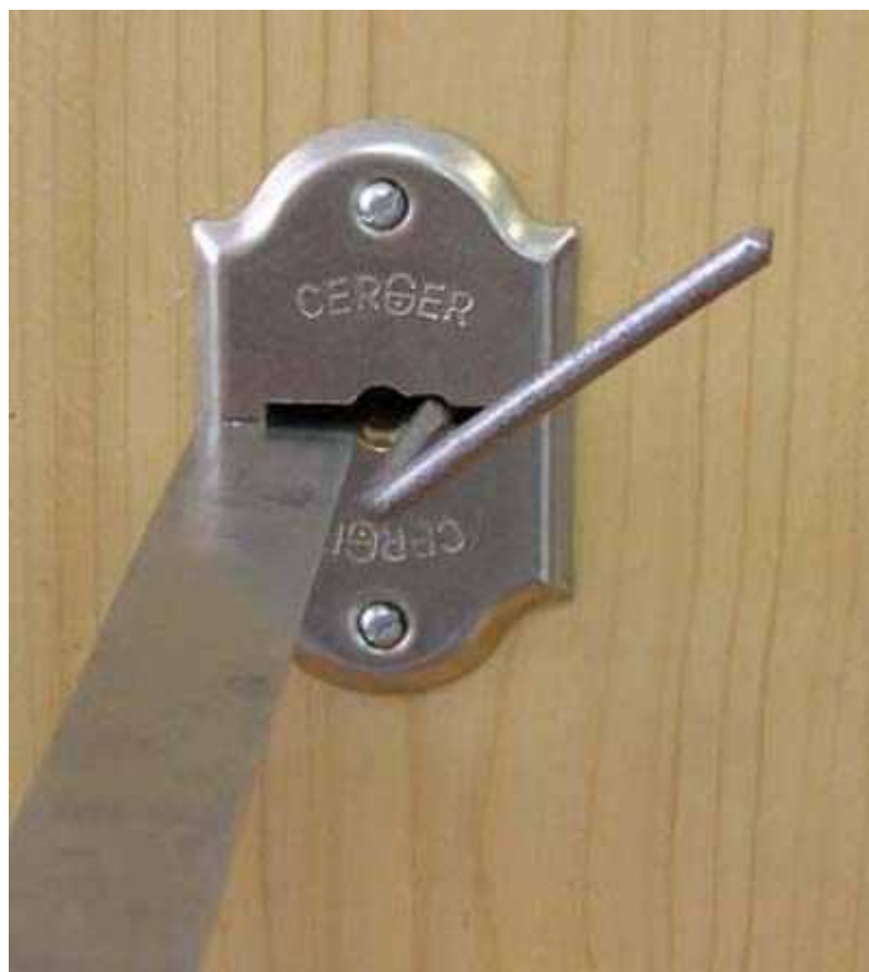
Фото 2. На фотографии зафиксирован процесс снятия слепка с ключа. В данном эксперименте вы видите замок CERBER. Именно на нем специализировались пойманные воры. Манипулируя правой рукой с шилом или другим тонким твердым предметом, левой рукой подсовываете пластину с пластилином.
