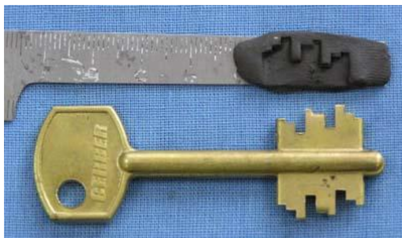
Фото 3. На фотографии вы видите полученный четкий слепок, по которому изготовить ключ не составит труда, имея под рукой нужную заготовку ключа и надфиль. Эту заготовку легко купить в любой ключной мастерской за копейки.
