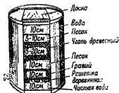
Рис. 28. Полевые фильтры из подручных материалов.
