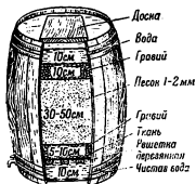
Рис. 28. Полевые фильтры из подручных материалов.
