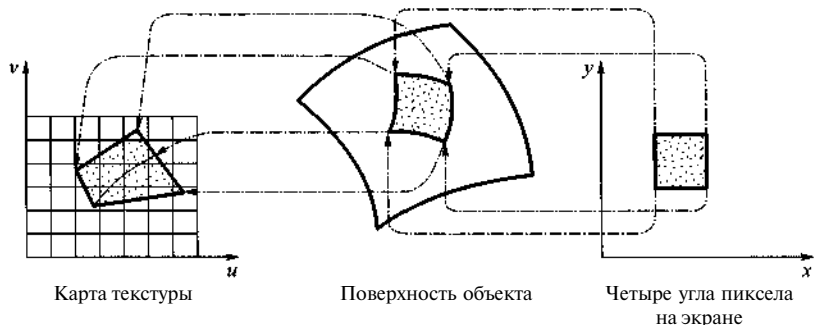
Рис. 4.71. Отображение текстуры от пиксела до поверхности и до карты текстуры
