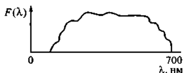
Рис. 1.1. Пример спектрального состава пучка света
