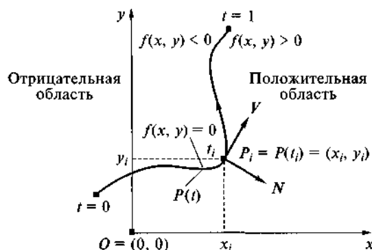
Рис. 4.43. Ориентированная кривая линия, касательная V и нормаль N
