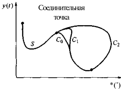
Рис. 3.6. Соединение фрагментов кривых трех различных типов
