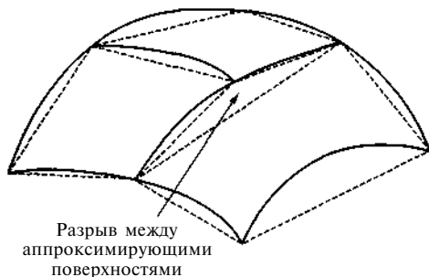
Рис. 3.34. Возникновение разрыва аппроксимации
