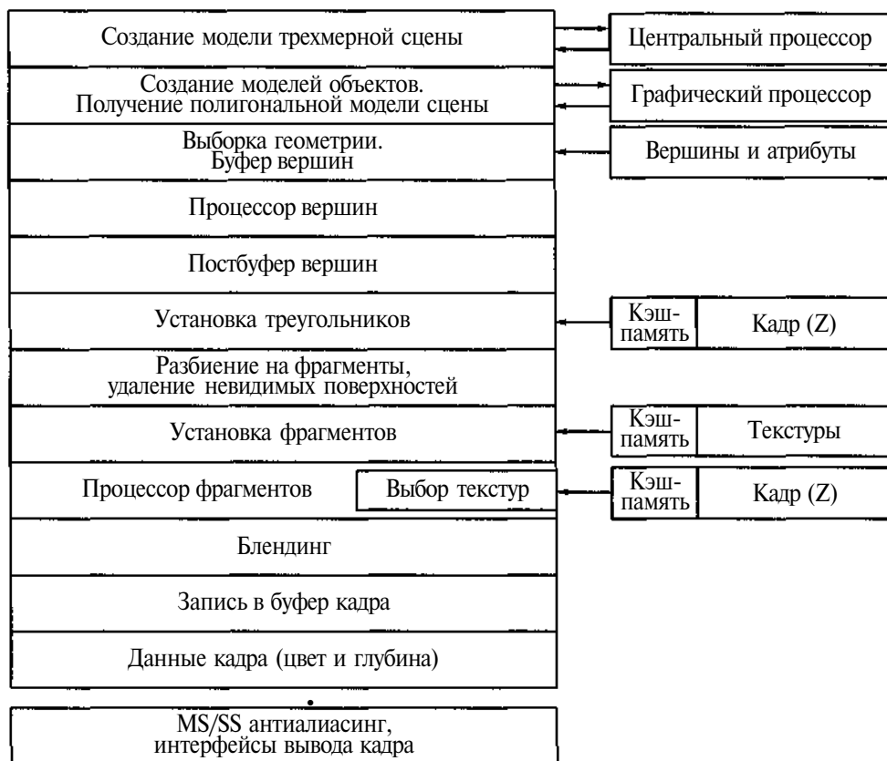
Рис. 2.20. Этапы работы графического конвейера
