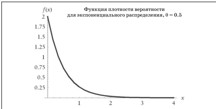
Рис. 9.10. Функция плотности вероятности экспоненциально распределенной с параметром \theta = 0.5 случайной величины
