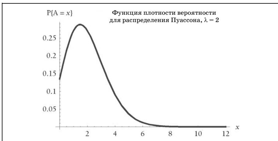
Рис. 9.8. Функция плотности вероятности (pdf) для величины, подчиняющейся распределению Пуассона с \lambda = 2 , отображает вероятность P(A = x) того, что в течение секундного интервала наблюдения поступит ровно x запросов
