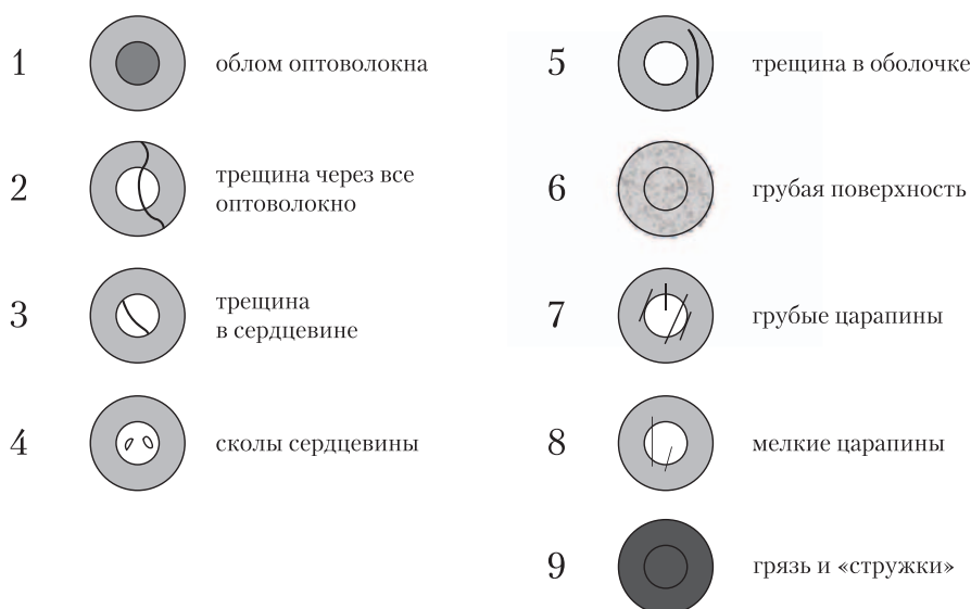
Рис. 10.1. Виды брака при обработке торца наконечника коннектора
