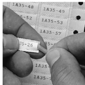
Рис. 6.6. Маркер типа плоской гильзы
