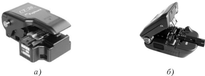
Рис. 156. Скальватели с продольно-скользящим резаком: а) с боковым вводом волокна (модель CT-20 компании Fujikura); б) с торцевым вводом волокна (модель FC-7S компании Sumitomo)
