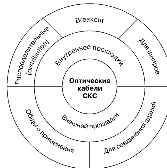
Рис. 39. Классификация оптических кабелей СКС
