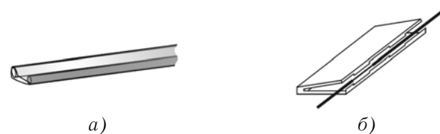
Рис. 146. Элементы защиты сварного сростка: а) термоусадочного типа; б) механический
