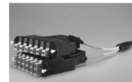
Рис. 142. Сборка с несколькими групповыми разъемами
