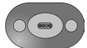
Рис. 45. Ленточный кабель внутренней прокладки
