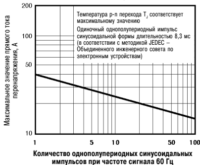
Рис. 6. Максимальное значение прямого тока перенапряжения (только для приборов с униполярным включением)
