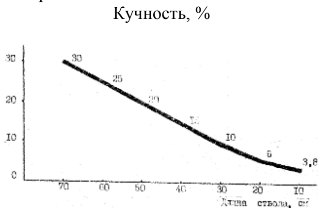
Рис. 7, Кривая зависимости кучности дробовой осыпи от длины ствола гладкоствольного ружья
