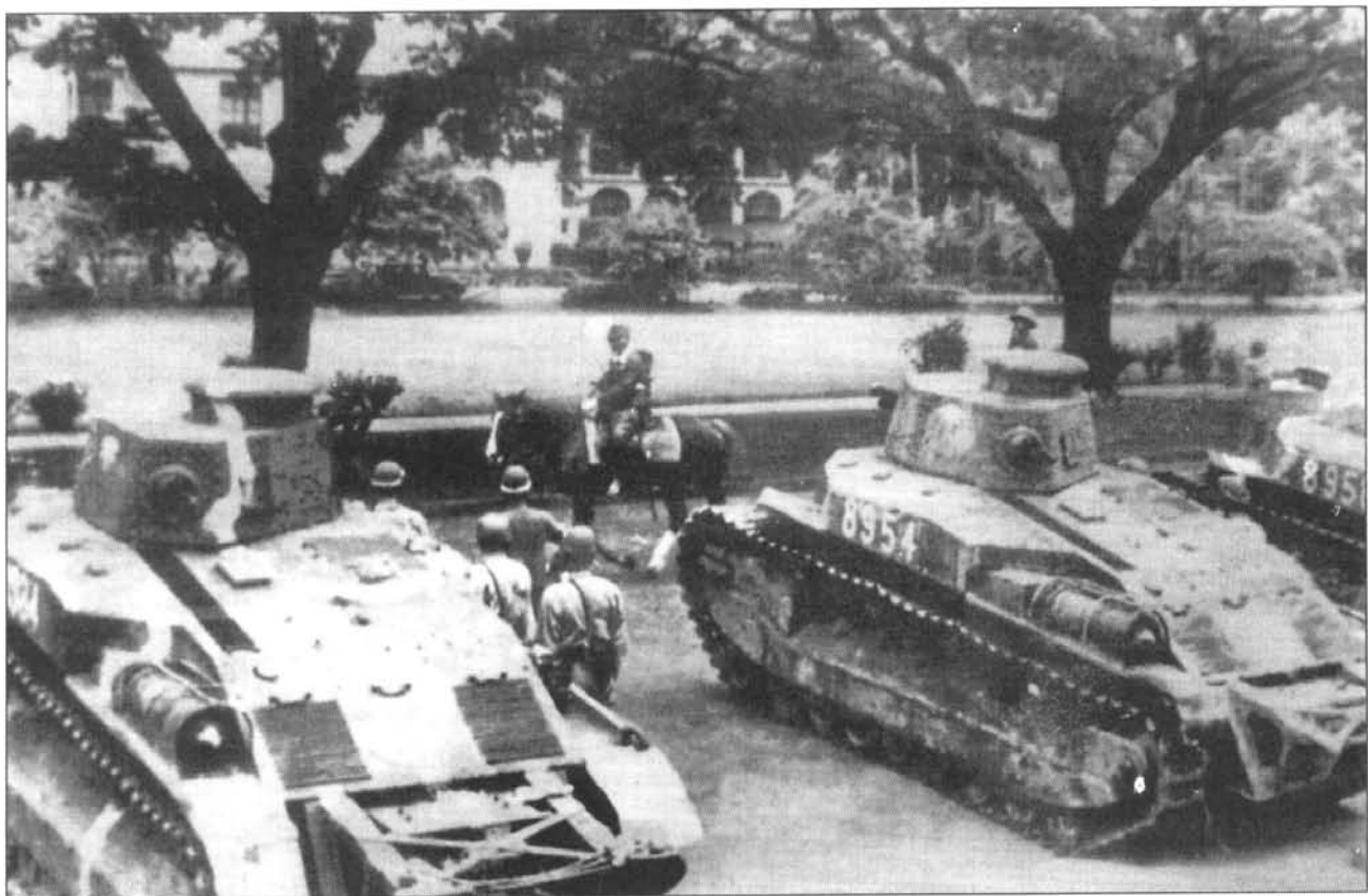
Танки «тип 89» («2594») поздней постройки, скорее всего машины принадлежат 2-й роте 7-го танкового полка. Обратите внимание на «хвосты».
