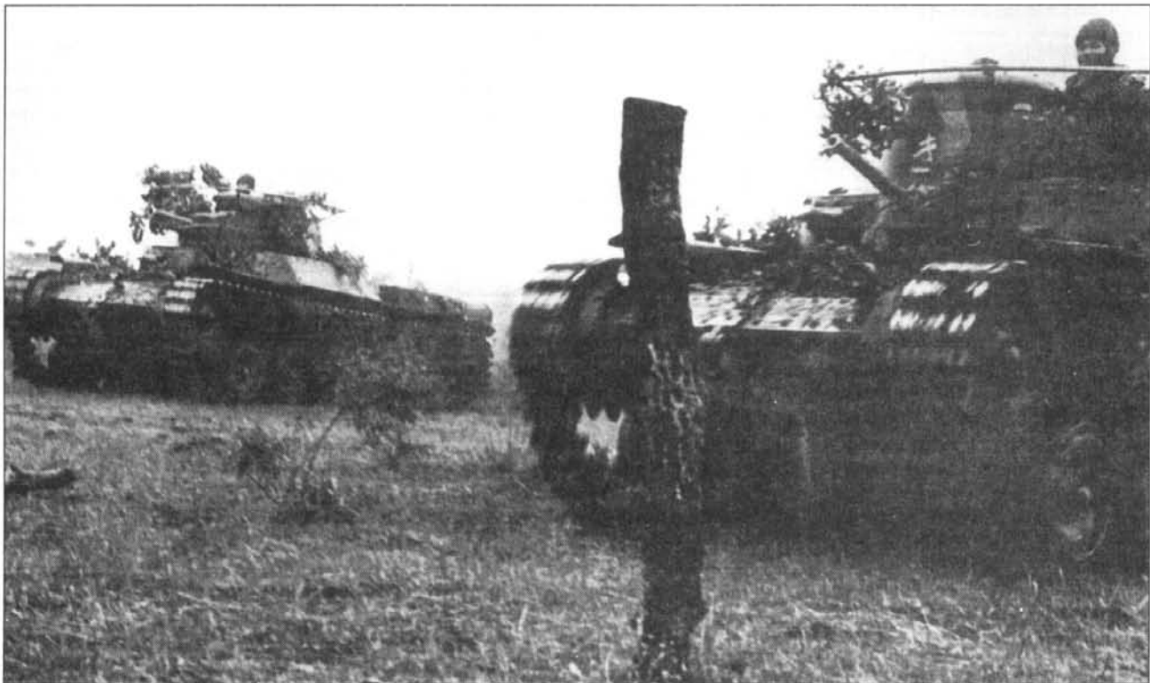
Первые варианты танков командиров батальонов и полков «Ши-ки» выпускались на основе линейных танков «тип 97 Чи-ха». Артиллерийское вооружение в башни не устанавливалось, но вместо курсового пулемета в корпусе смонтирована 37-мм пушка. На башне виден иероглиф «ки» - танк принадлежит кавалерийскому училищу в Чибо.
