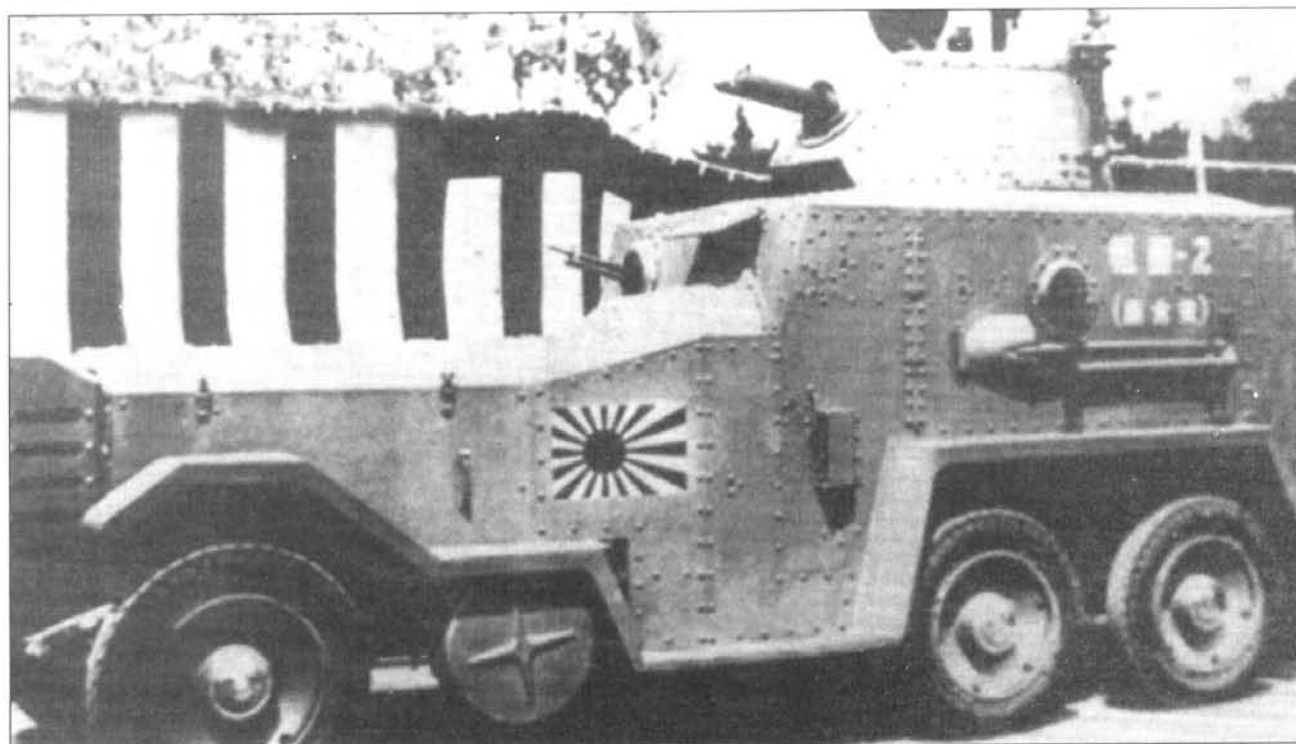
Бронеевтомобиль «тип 92» позднего выпуска (крылья образованы плоскими поверхностями, имеются вспомогательные колеса, изменена форма лобовой части кузова в районе места водителя). Машина принадлежит подразделению морской пехоты. Львиная часть построенных бронеевтомобилей «тип 92» поступила на вооружение десантных частей ВМС Японии.
