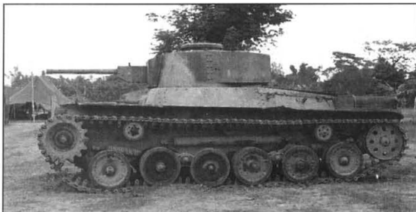
Средний танк «тип 97 Шинхото Чи-ха» представлял собой дальнейшее развитие танка «Чи-ха», отличаясь, главным образом, башней увеличенных размеров. Танк был вооружен длинноствольной пушкой калибра 47 мм.
