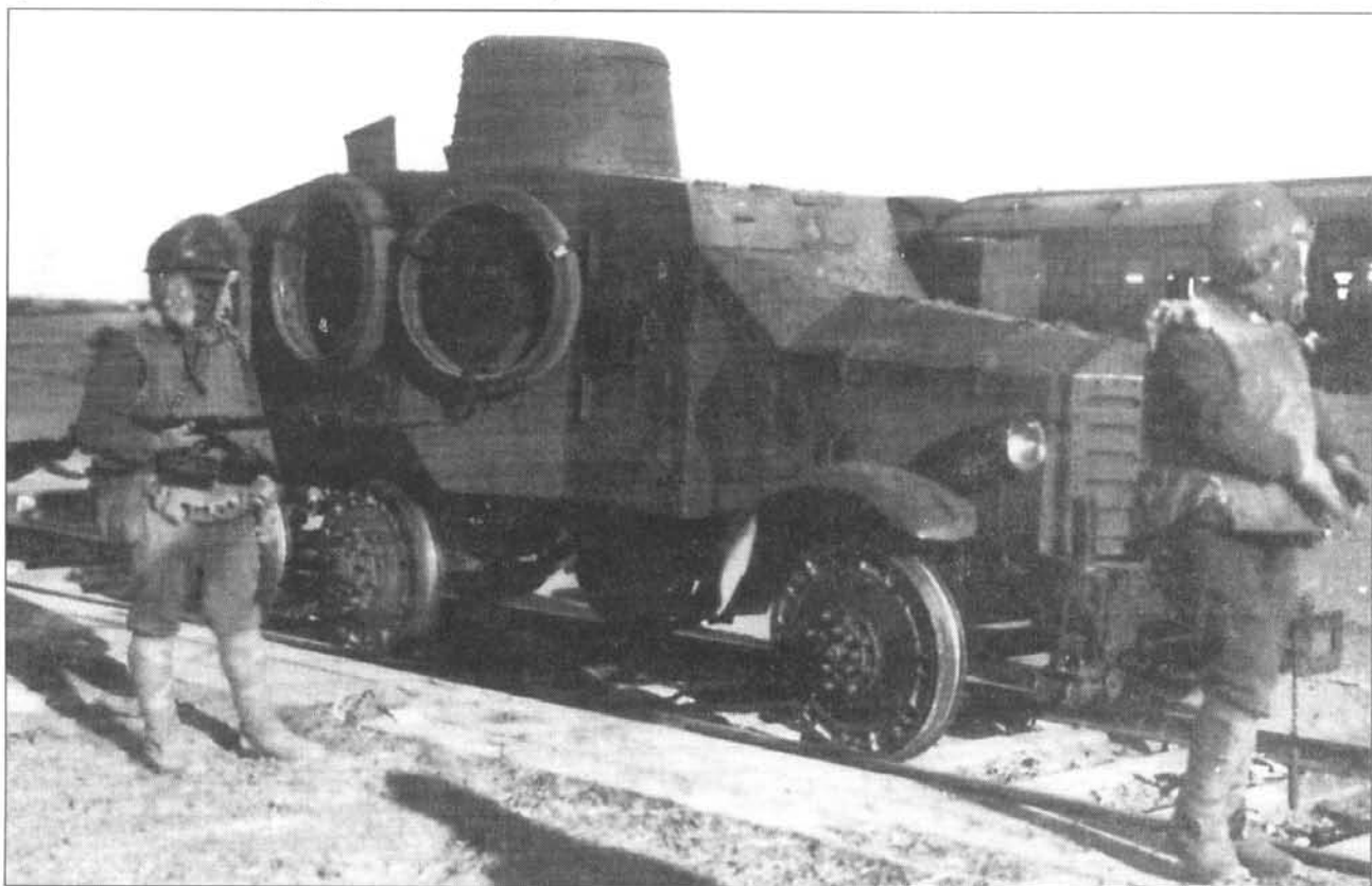
Бронедрезина - броневомобиль «тип 93 Сумида» поздней постройки. Машины поздних выпусков имели более широкий кузов. Эта машина интересна тем, что вообще не имеет вооружения - бронетранспортер в чистом виде.
