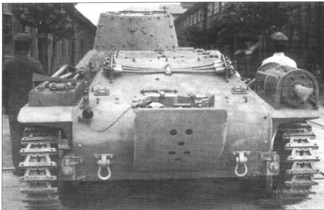
Средний танк «тип 97 Чи-ни», вид сзади. Хорошо виден «хвост», в 30-е годы такое устройство уже считалось явным анахронизмом.
