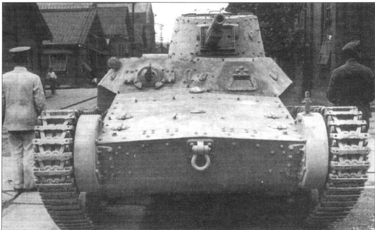
Средний танк «тип 97 Чи-ни», вид спереди. Место механика-водителя расположено слева от продольной оси машины, в соответствии с правилами дорожного движения, принятыми в Европе. На всех последующих японских танках место механика-водителя находилось справа от продольной оси, как и место шофера японского автомобиля. На снимке хорошо видны кожуха выходных устройств трансмиссии, крайне уязвимых при обстреле спереди.
