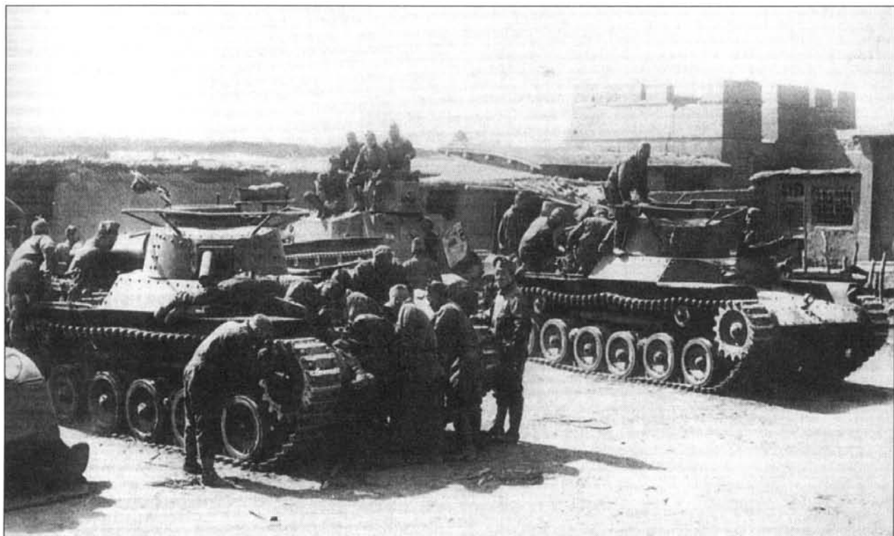
Танки «тип 97 Чи-ха» из 4-го танкового полка. Оба танка оборудованы радиостанциями, скорее всего - это машины командиров взводов. Командирские танки легко отличить от линейных по поручневым антеннам вокруг башен. На заднем плане - облепленный танкистами старый танк «тип 2594 Чи-ро». Видимо - на снимке первые танки «Чи-ха», полученные полком. Танкисты с интересом знакомятся с устройством боевых машин. Обратите внимание насколько танк «Чи-ро» выше танка «Чи-ха».
