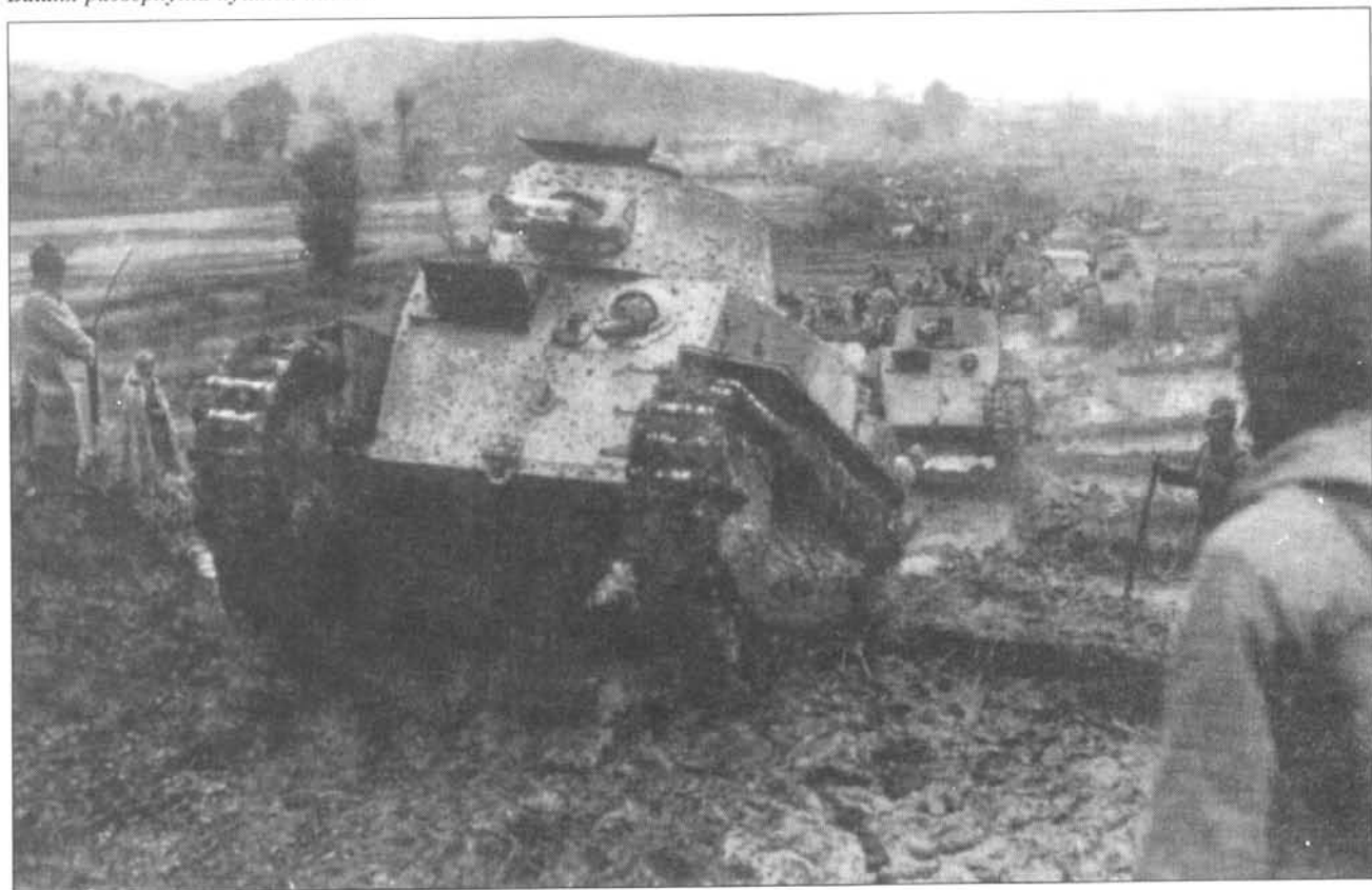
Колонна средних танков «тип 89» поздней постройки на марше, Китай. Обратите внимание на толстый слой грязи, почти полностью закрывший ходовую часть головной машины.
