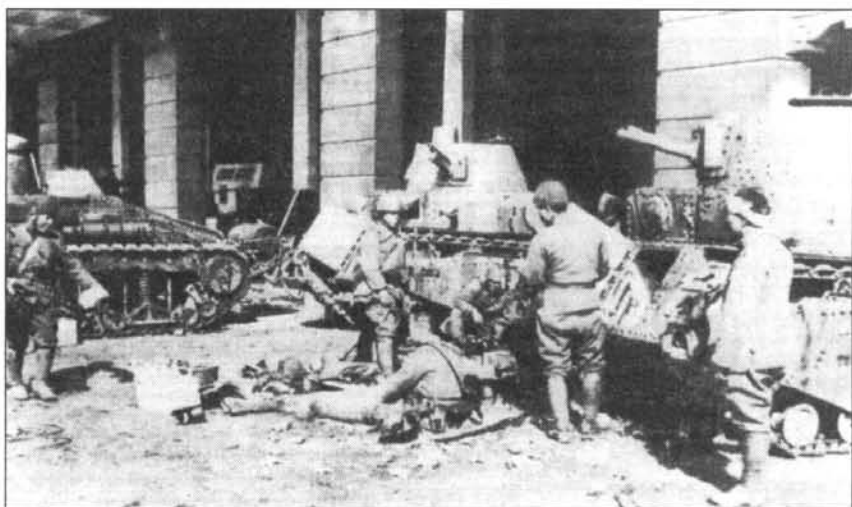
Передышка в уличных боях. Шанхай, 1932 г. Справа - два танка «тип 89А» ранней постройки со старыми траками и первым вариантом башни. Слева (виден не полностью) - танк Рено NC-27, японское обозначение «Оцу Гата Синша».
