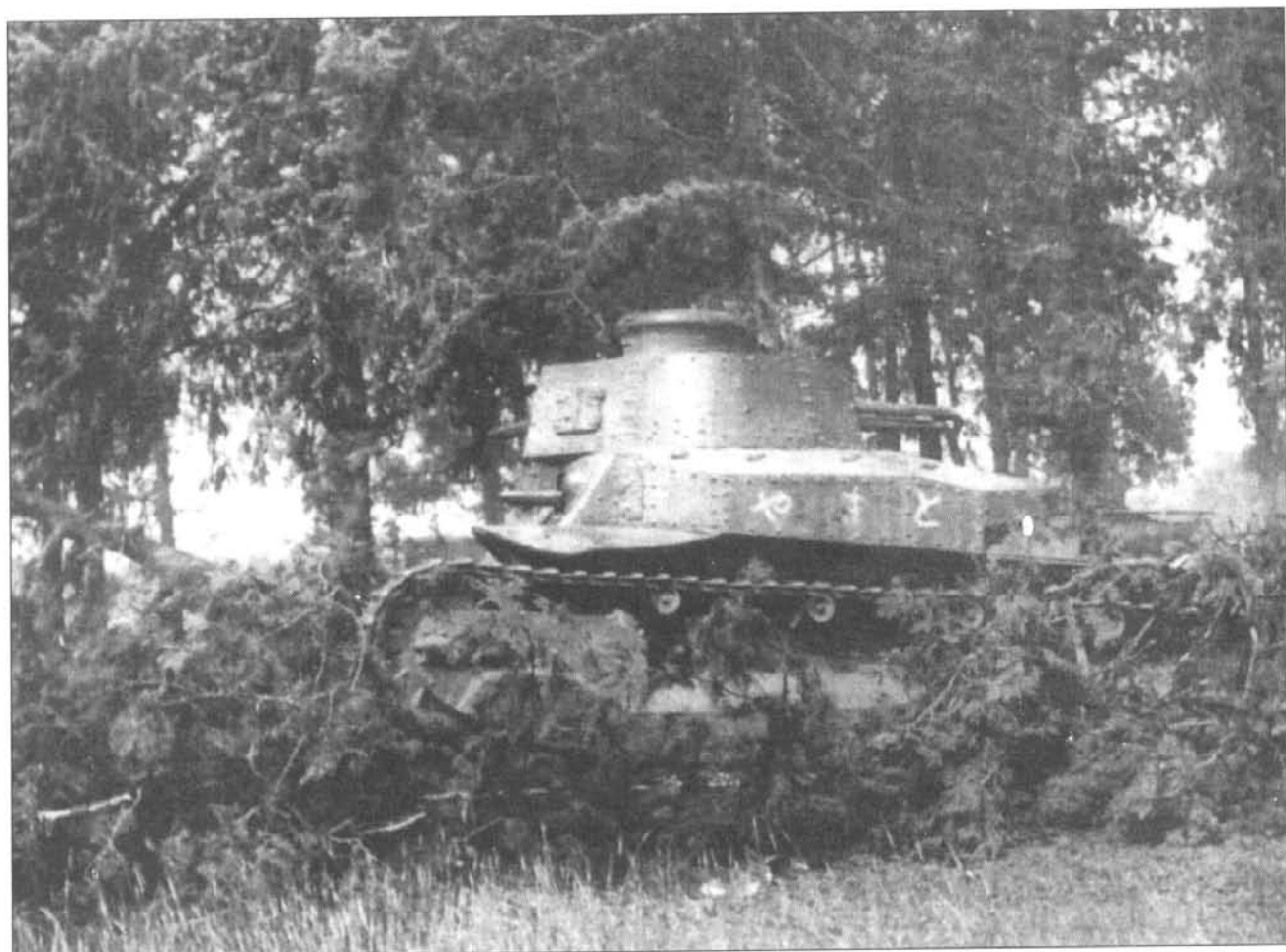
Средний танк «тип 89» («2594») поздней постройки, Китай. Иероглифы на корпусе в переводе обозначают «японский дух». Башня развернута пушкой назад.
