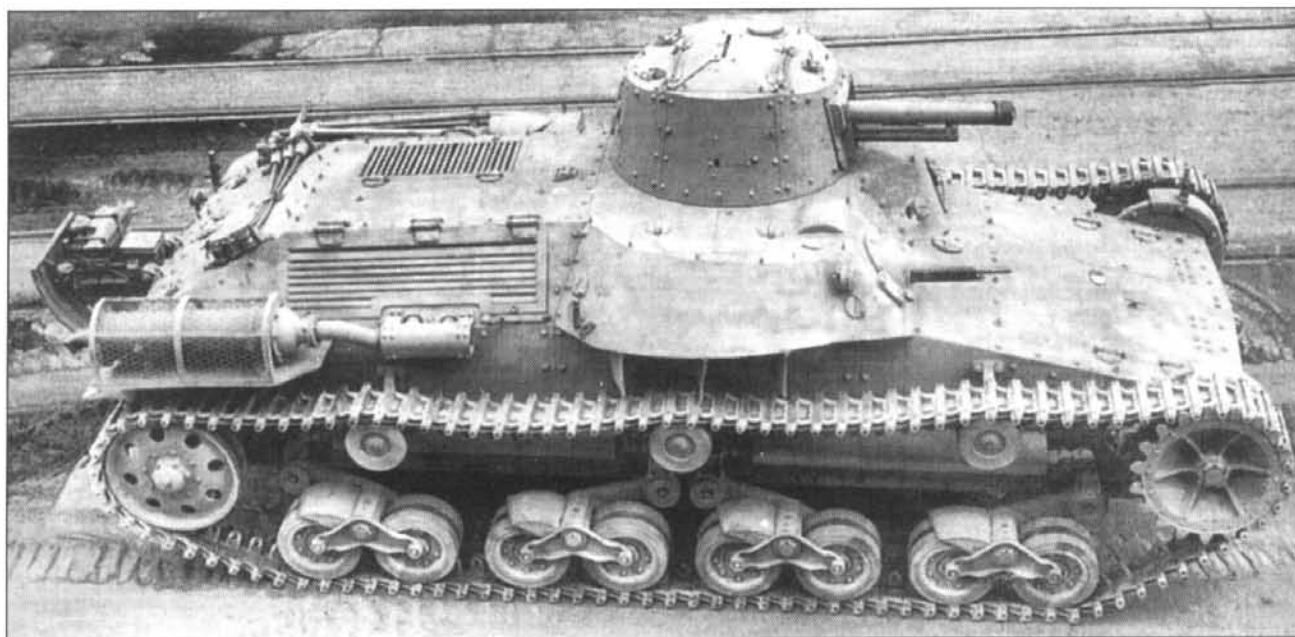
Прототип среднего танка «тип 97 Чи-ни». Разработанная в арсенале Осаки машина оказалась неудачной. Масса (чуть меньше 10 т) и ограниченные боевые возможности (одноместная башня, ненадежный двигатель, тонкая броня) скорее соответствовали легкому танку, а не среднему. Обратите внимание на «хвост» в задней части корпуса танка - наследие французского танка Рено FT М1е 1917 («Ко-Гата Синиша»)
