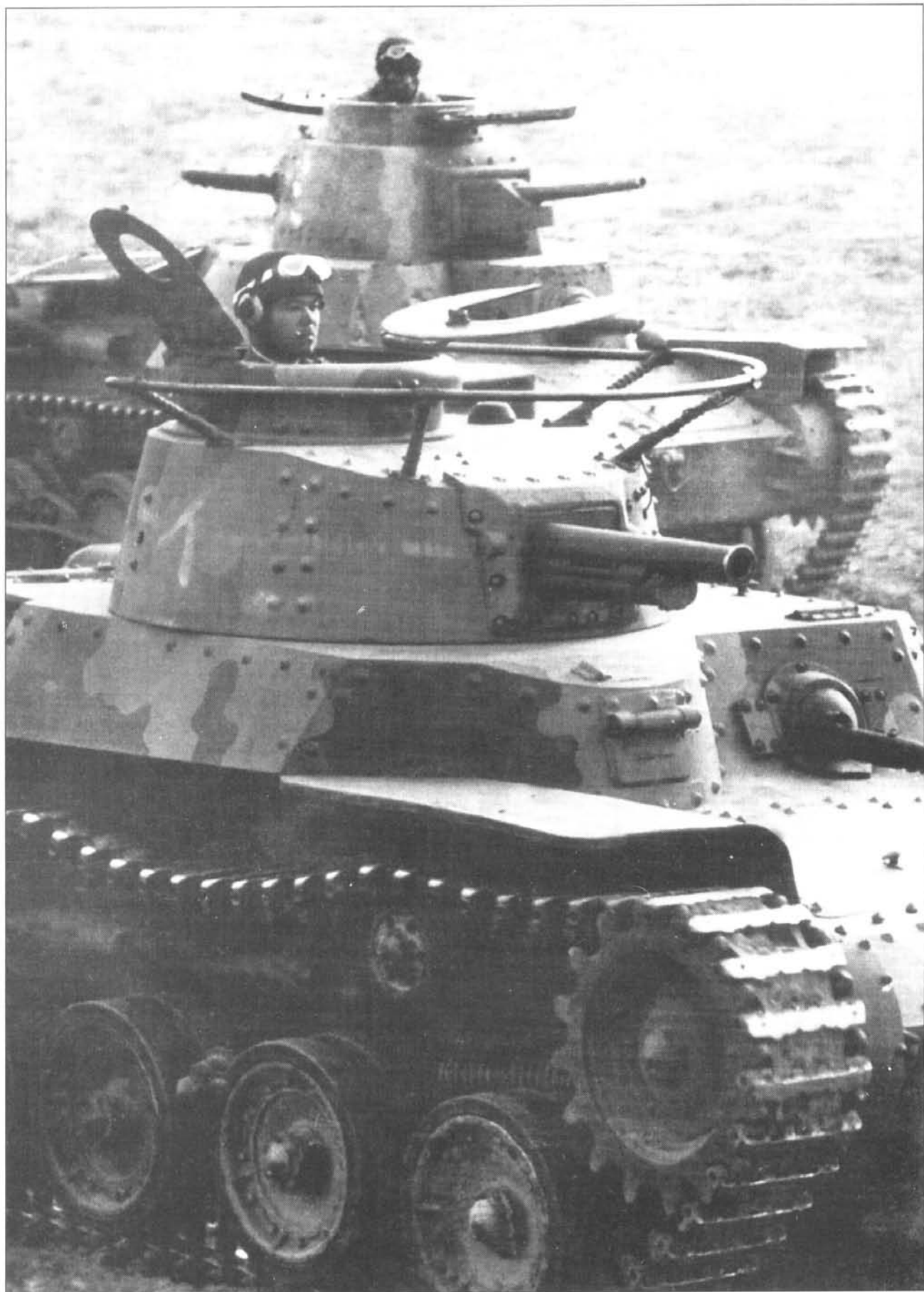
Танки из 23-го танкового полка Квантунской армии на учениях в Маньчжурии. На переднем плане - командирский танк «Чиха». Обратите внимание - в правой створке башенного люка нет наблюдательного прибора - осталась одна дырка. Хорошо видна оригинальная форма створок верхнего люка. Снимок дает хорошее представление о детализровке лобовой части корпуса. На заднем плане - легкий танк «тип 95 Ха-го».
