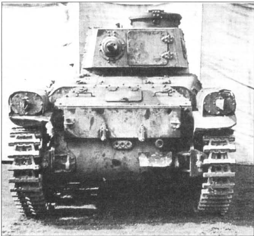
Тот же танк, вид сзади и спереди, хорошо виден кормовой бронелист башни с пулеметной установкой и аварийным люком. Аварийный люк также использовался для погрузки боекомплекта.
