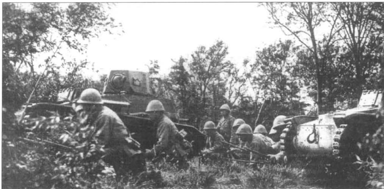
Танкетки «тип 94», Китай. Прежде всего такие машины использовали для снабжения войск на передовой и только потом - в качестве боевой машины.
