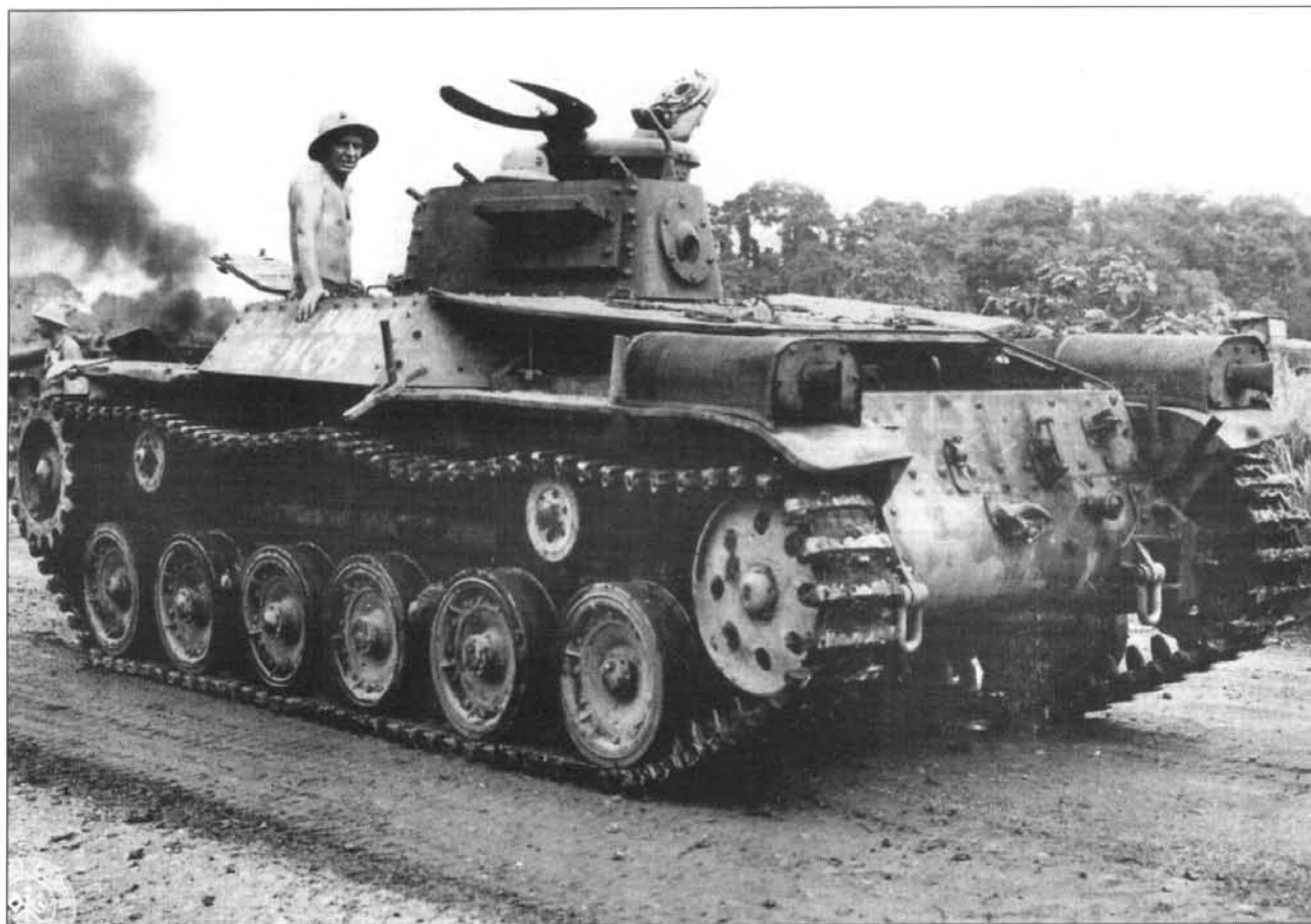
Средний танк «тип 97 Чи-ха», захваченный американскими морскими пехотинцами. Обратите внимание на кронштейны для крепления поручневой антенны, шкворень для зенитного пулемета. Верхний башенный люк открыт. На стенке башни закреплена площадка под дымовые гранатометы.
