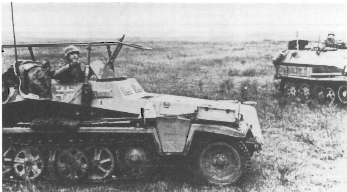
Средний полугусеничный бронетранспортер SdKfz 250 дивизии «Лейбштандарт» на Восточном фронте. На фотографии модификация SdKfz 250/3 — машина связи, оборудованная радиостанцией большой мощности
